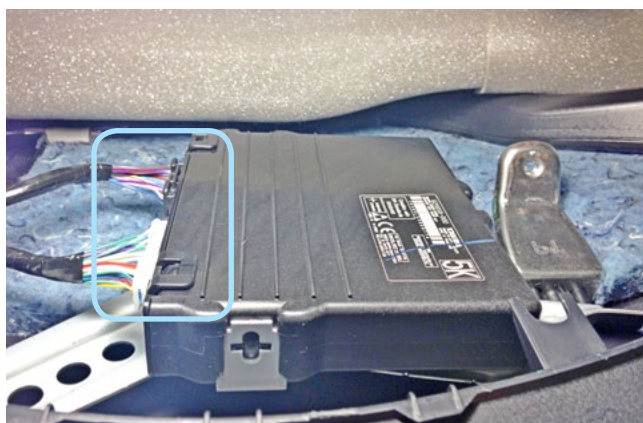
Фото 3.2. Местоположение блока сертификации. Разъёмы
