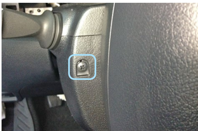
Фото 1.10. Саморез крепления кожуха рулевого вала слева
