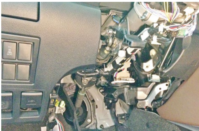
Фото 1.19. Коленная подушка безопасности водителя снята
