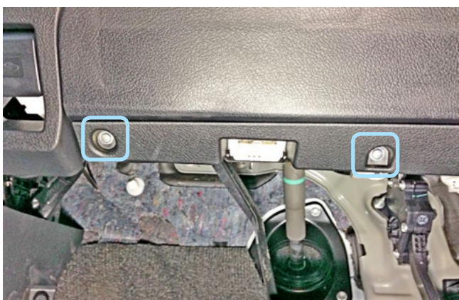
Фото 1.15. Саморезы крепления декоративной накладки под подушкой безопасности
