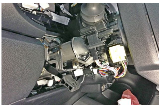
Фото 1.14. Кожух рулевого вала снят
