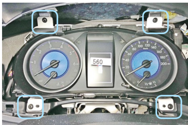
Фото 1.7. Саморезы крепления панели приборов
