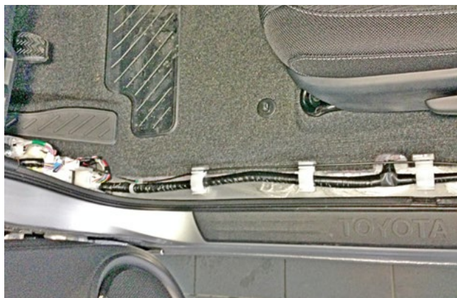
Фото 1.3. Накладки порога и кик-панели сняты
