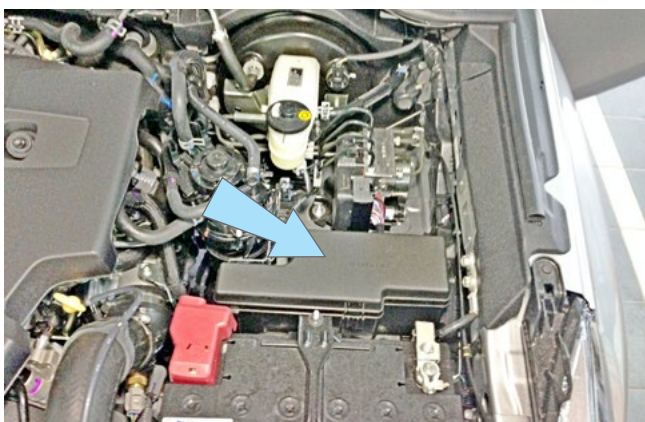
Фото 2.7. Возможное место установки подкапотного блока R6
