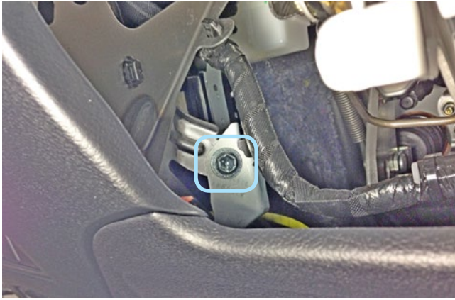
Фото 1.17. Болт крепления подушки безопасности вверху слева
