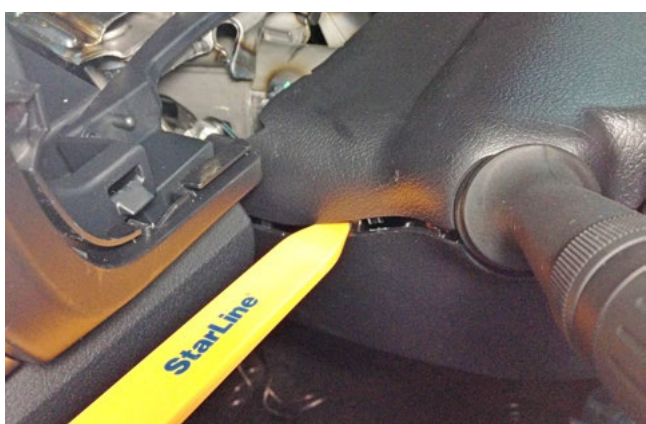
Фото 1.13. Разъединить верхнюю и нижнюю части кожану рулевого вала
