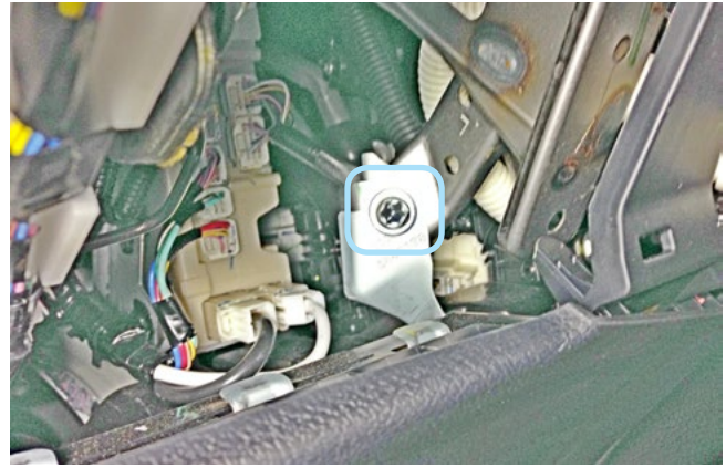
Фото 1.18. Болт крепления подушки безопасности вверху справа
