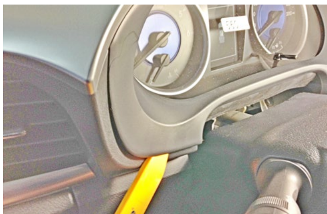
Фото 1.6. Снять накладку панели приборов
