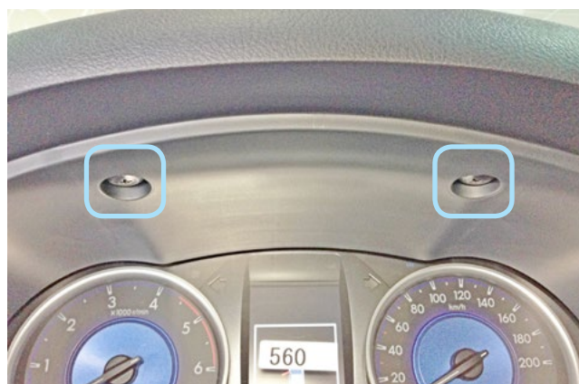
Фото 1.5. Клипсы крепления накладки панели приборов
