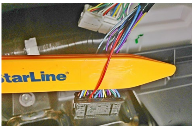
Фото 3.4. Разблокировка рулевого вала (красный)
