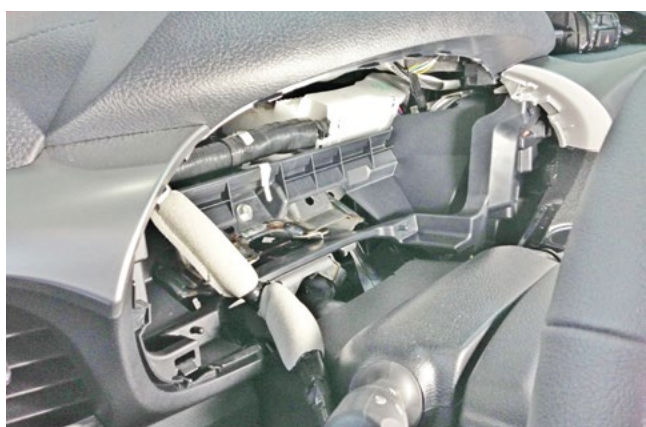
Фото 1.8. Панель приборов снята
