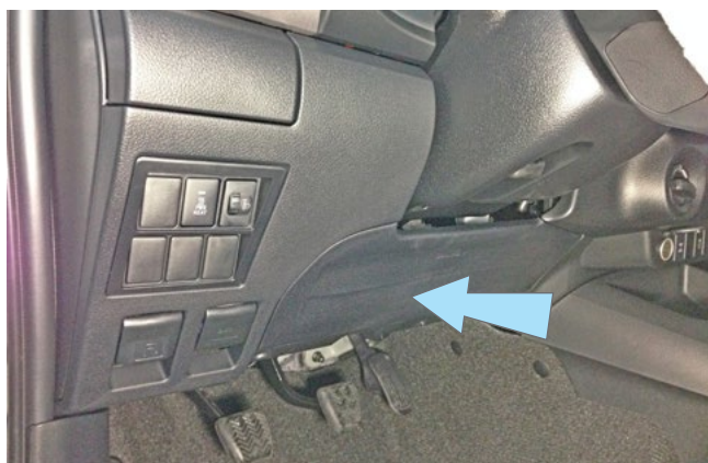
Фото 1.9. Коленная подушка безопасности водителя. Общий вид
