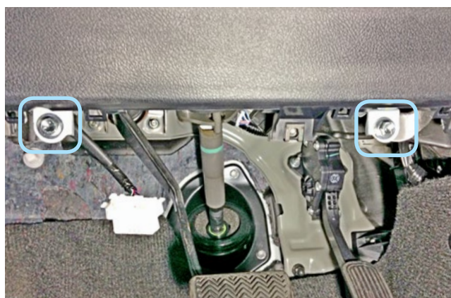
Фото 1.16. Болты крепления подушки безопасности снизу
