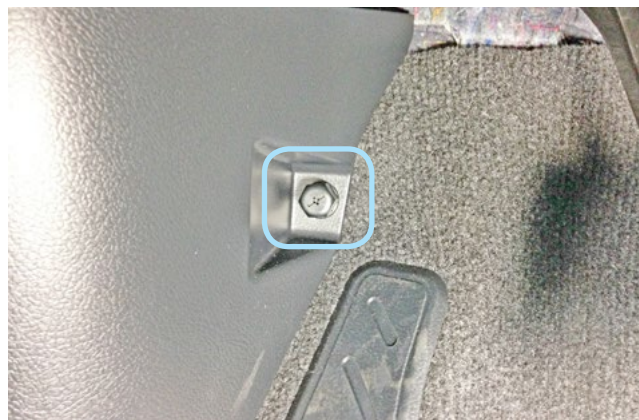
Фото 1.2. Клипса крепления накладки кик-панели
