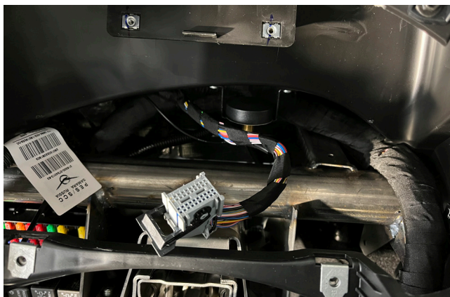
Фото 1.12. Приборная панель снята
