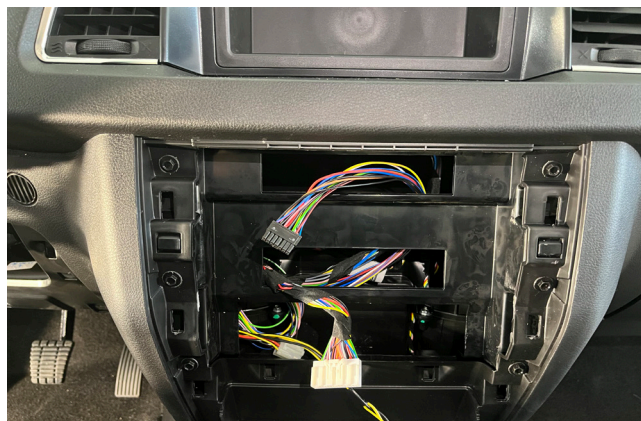
Фото 1.14. Блок климатической установки снят
