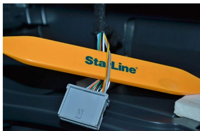
Фото 3.3. Шина CAN-A (жёлто-красный и серый)
