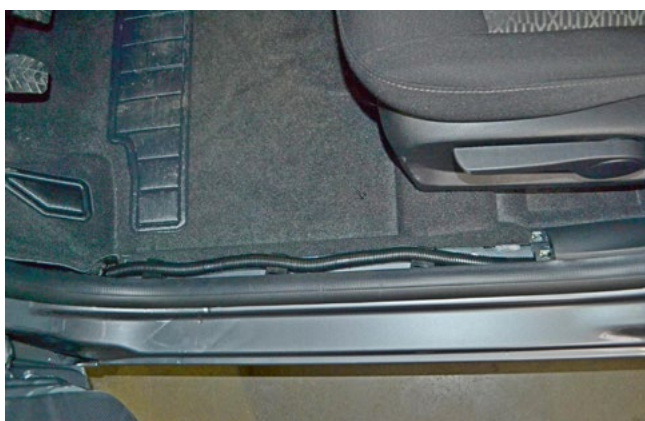
Фото 1.3. Накладка порога двери водителя снята
