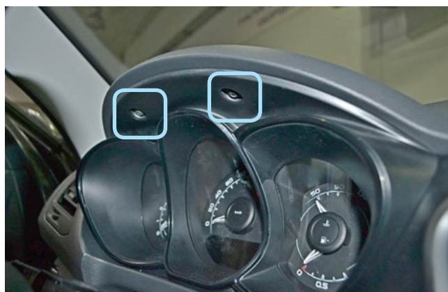
Фото 1.11. Саморезы крепления декоративной накладки панели приборов
