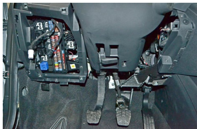
Фото 1.6. Пластиковая накладка под рулевой колонкой снята
