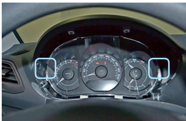
Фото 1.12. Декоративная накладка снята. Саморезы крепления панели приборов
