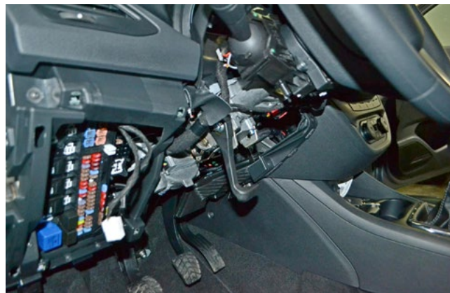
Фото 1.10. Кожух рулевого вала снят
