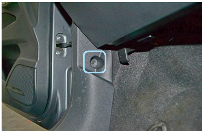
Фото 1.1. Саморез крепления накладки порога двери водителя
