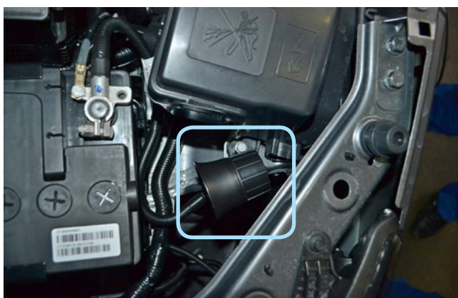
Фото 2.3. Возможное место установки сирены
