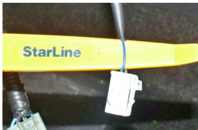
Фото 3.12. Имитация нажатия педали сцепления (синий)
