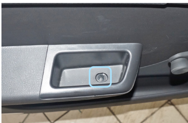
Фото 1.16. Саморез крепления накладки двери водителя
