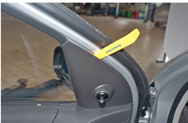
Фото 1.14. Снять декоративный уголок
