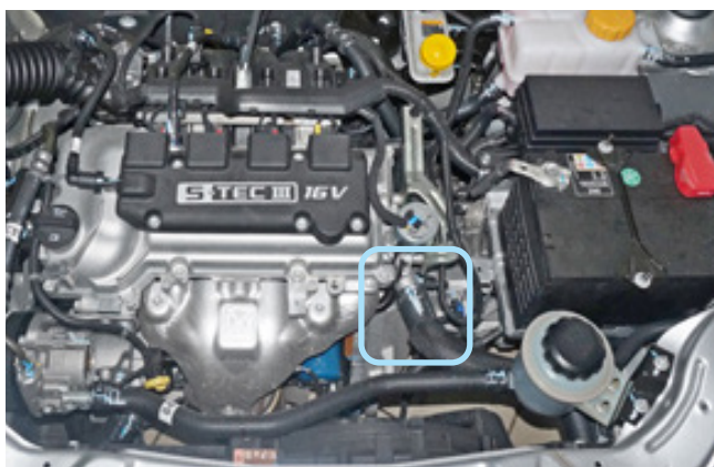
Фото 2.4. Место установки датчика температуры двигателя
