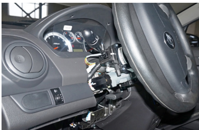
Фото 1.11. Кожух рулевого вала снят
