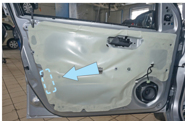
Фото 1.17. Накладка двери водителя снята. Место установки дополнительного электропривода
