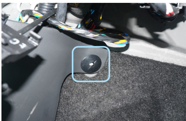
Фото 1.5. Клипса крепления накладки порога двери водителя
