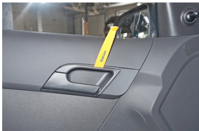
Фото 1.13. Снять накладку ручки открывания двери
