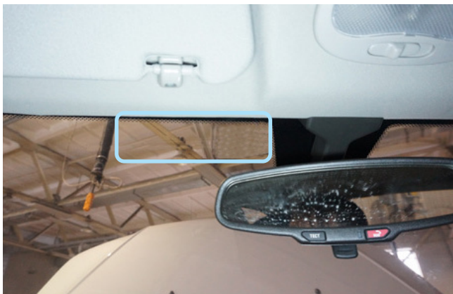
Фото 2.1. Возможное место установки антенного модуля
