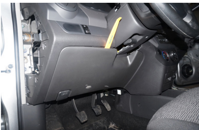
Фото 1.3. Снять пластиковую накладку под рулевой колонкой
