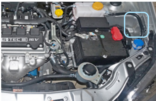
Фото 2.2. Возможное место установки сирены
