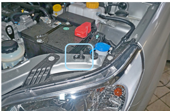
Фото 2.6. Возможное место установки концевика капота
