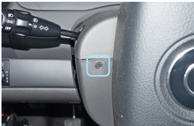
Фото 1.7. Саморез крепления кожуха слева
