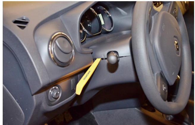
Фото 1.2. Снять верхнюю часть кожуха рулевого вала
