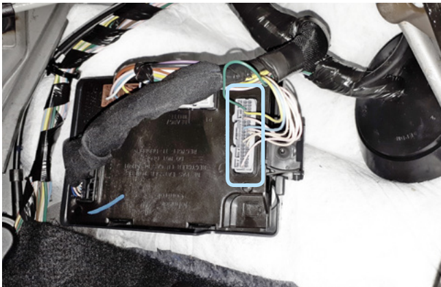
Фото 3.4. Местоположение серого разъёма S2
