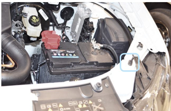
Фото 2.6. Возможное место установки концевика капота
