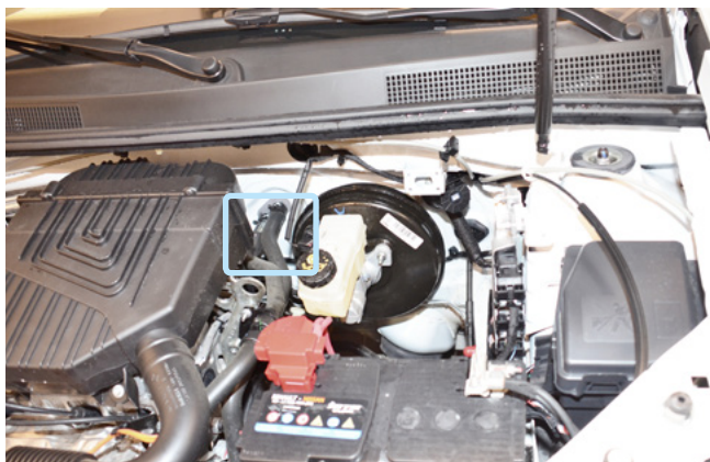
Фото 2.4. Место установки датчика температуры двигателя
