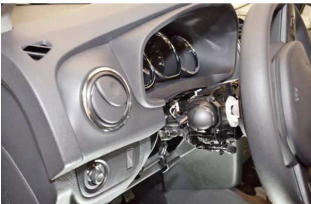
Фото 1.3. Кожух рулевого вала снят
