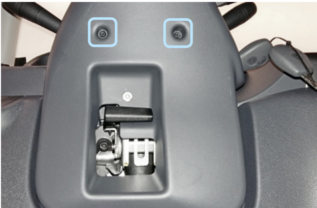
Фото 1.1. Саморезы крепления нижней части кожуха
