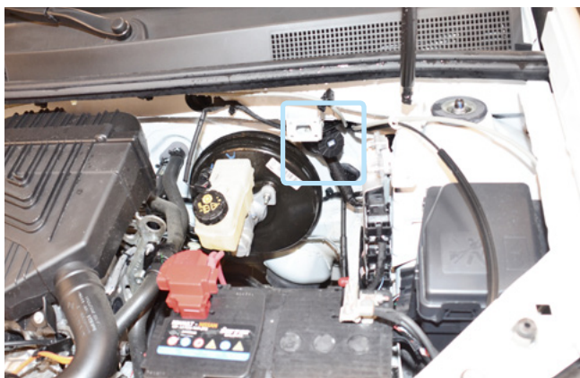
Фото 2.2. Возможное место установки сирены
