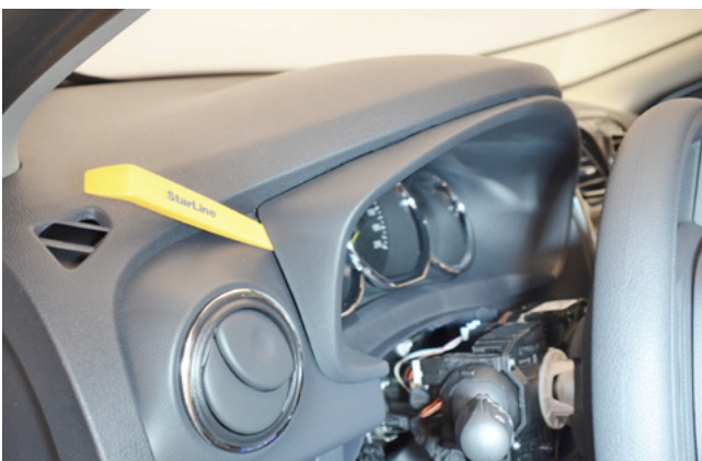
Фото 1.4. Снять накладку панели приборов
