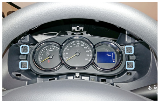
Фото 1.5. Саморезы крепления панели приборов
