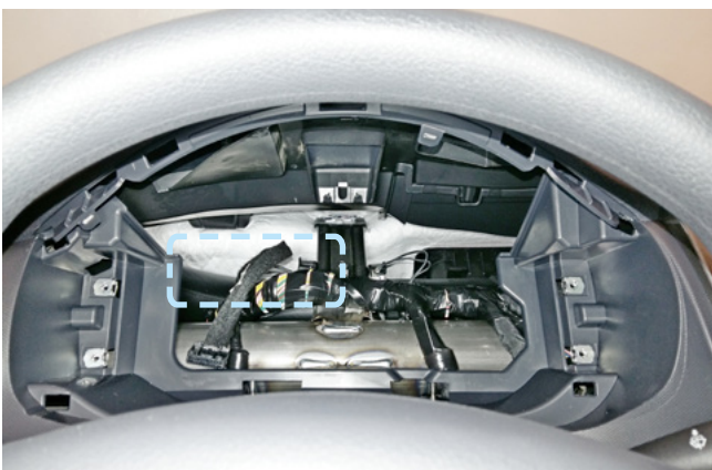
Фото 2.9. Пример расположения центрального блока охранно-телематического комплекса
