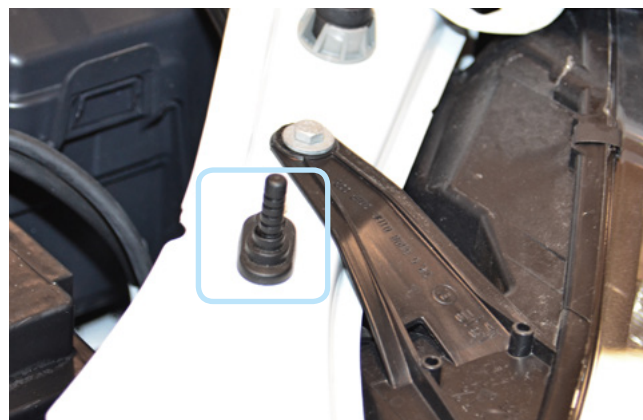
Фото 2.7. Крепление концевика капота
