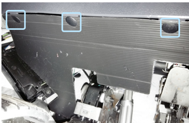
Фото 1.7 Клипсы крепления декоративной накладки педального узла
