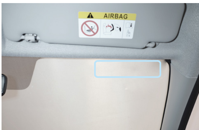
Фото 2.1. Возможное место установки антенного модуля
