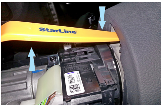
Фото 1.14. Освободить фиксатор подушки безопасности
