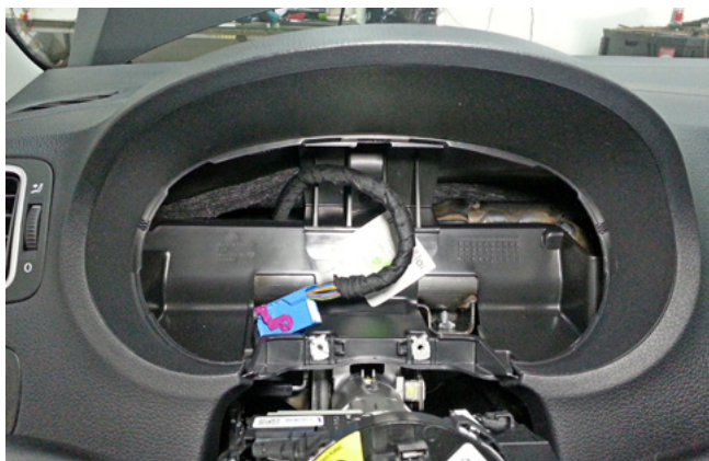
Фото 1.13. Панель приборов снята
