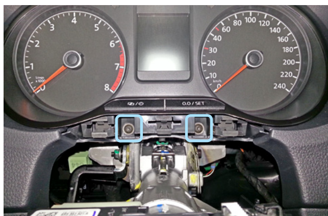
Фото 1.12. Саморезы крепления панели приборов
