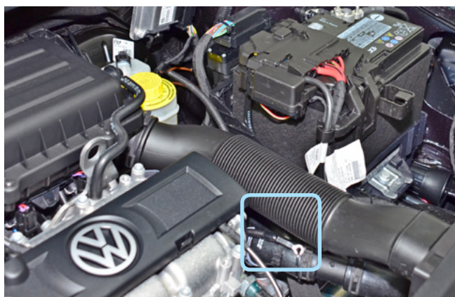
Фото 2.3. Место установки датчика температуры двигателя
