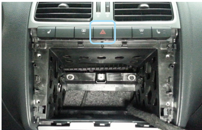
Фото 3.9. Местоположение кнопки аварийной сигнализации
