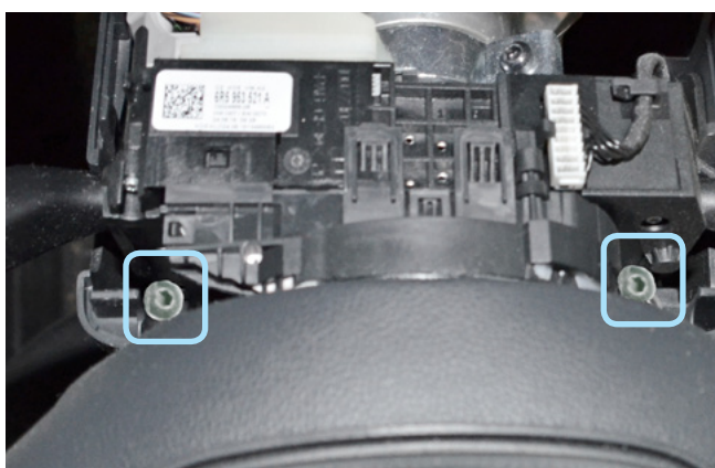
Фото 1.20. Саморезы крепления кожуха рулевого вала
