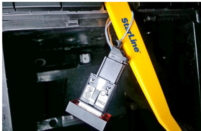
Фото 3.10. Управление световыми сигналами (бело-синий)
