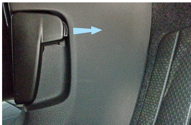
Фото 1.6. Сдвинуть фиксатор, снять ручку отпирания капота
