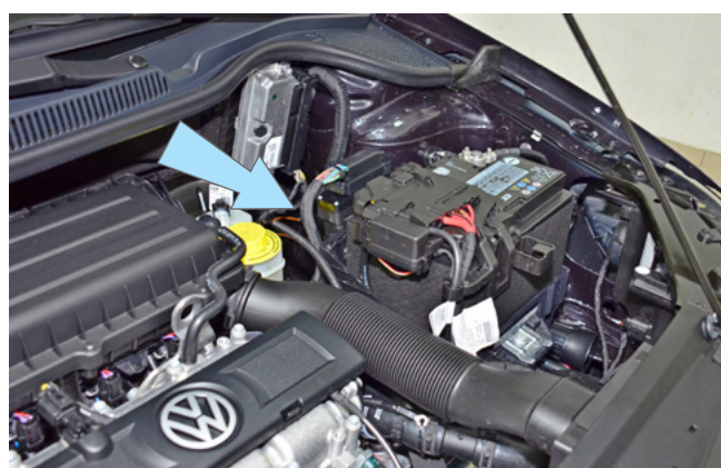
Фото 2.7. Возможное место установки подкапотного блока R6
