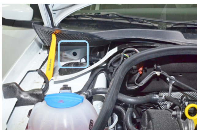
Фото 2.6. Штатный уплотнитель. Вид со стороны капота
