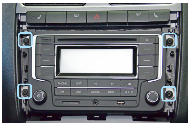
Фото 1.2. Саморезы крепления магнитолы
