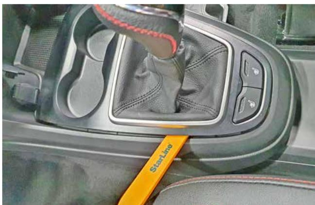
Фото 1.19. Снять накладку коробки передач
