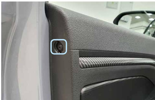
Фото 1.14. Саморез крепления внутренней обшивки двери водителя
