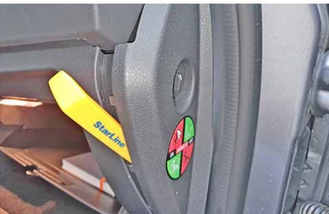
Фото 1.5. Снять правую накладку передней панели
