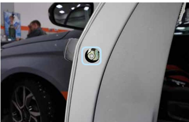
Фото 1.17. Саморез крепления ручки двери водителя
