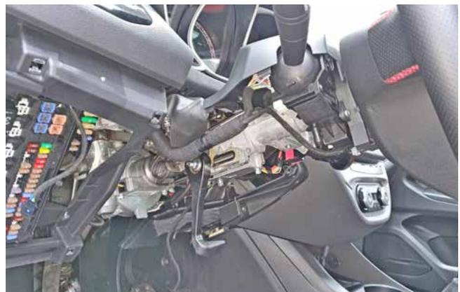
Фото 1.4. Нижняя часть кожуха рулевого вала снята
