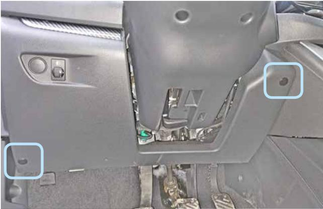
Фото 1.1. Клипсы крепления накладки под рулевой колонкой
