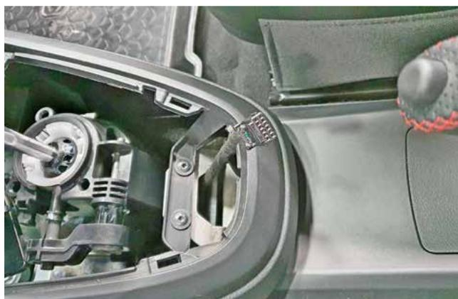
Фото 1.20. Накладка коробки передач снята
