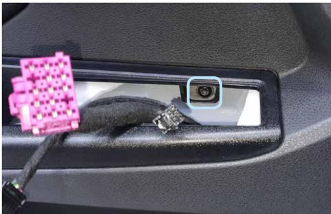
Фото 1.13. Саморез крепления внутренней обшивки двери водителя
