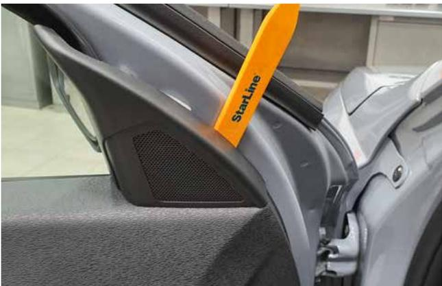
Фото 1.9. Снять пластиковую накладку динамика
