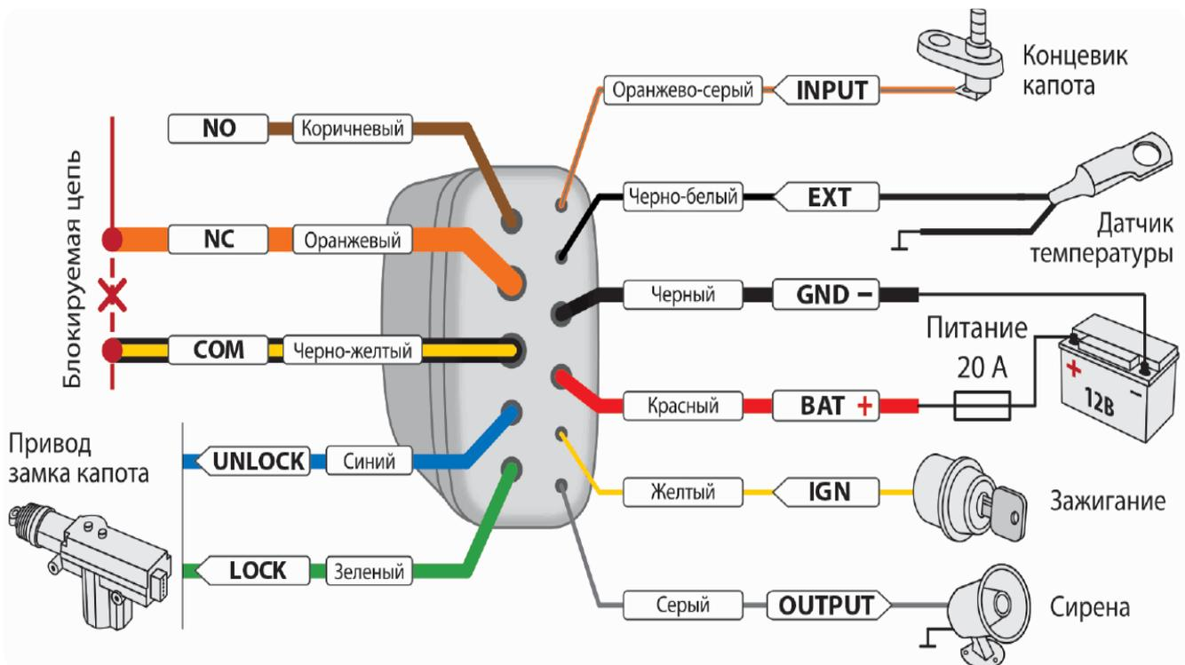
Центральный блок охранно-телематического комплекса StarLine закрепить на двусторонний скотч и пластиковые стяжки за перчаточным ящиком. **Внимание!!! Не размещайте центральный блок на расстоянии менее 10 см от металлических частей кузова автомобиля во избежание плохого качества приёма сигнала GSM и Bluetooth!**
