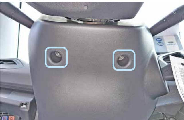
Фото 1.3. Саморезы крепления кожуха рулевого вала
