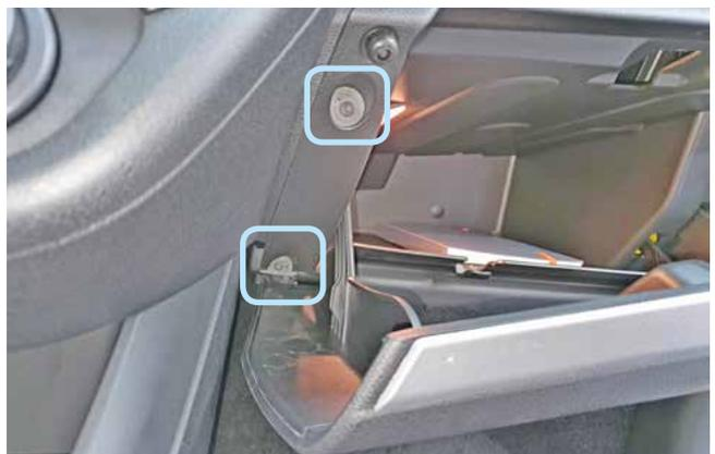
Фото 1.6. Саморезы крепления перчаточного ящика слева
