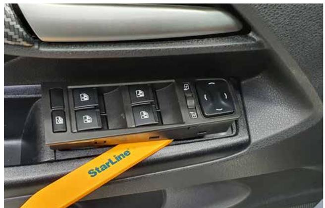
Фото 1.12. Снять блок кнопок двери водителя
