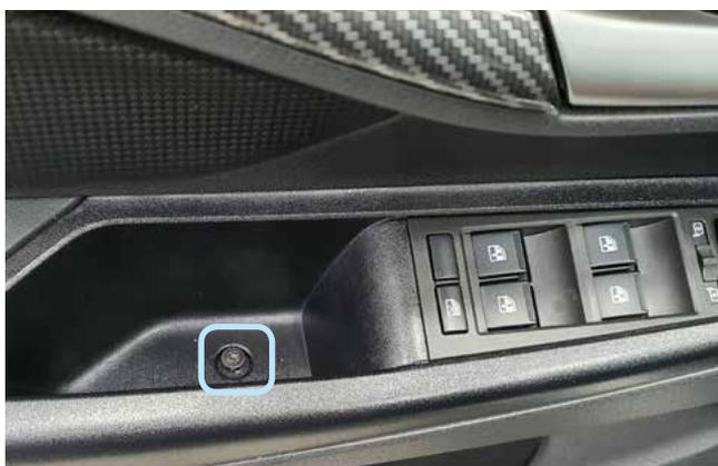
Фото 1.11. Саморез крепления ручки двери водителя
