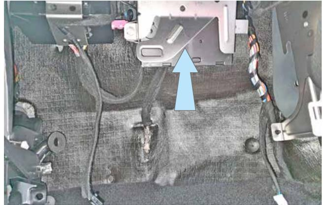
Фото 1.8. Перчаточный ящик снят. Местоположение блока BCM
