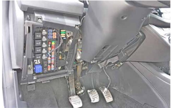
Фото 1.2. Накладка под рулевой колонкой снята
