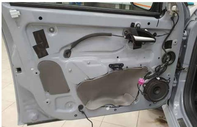
Фото 1.16. Обшивка двери водителя снята
