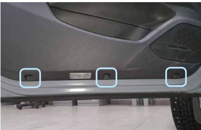
Фото 1.15. Саморезы крепления внутренней обшивки двери водителя
