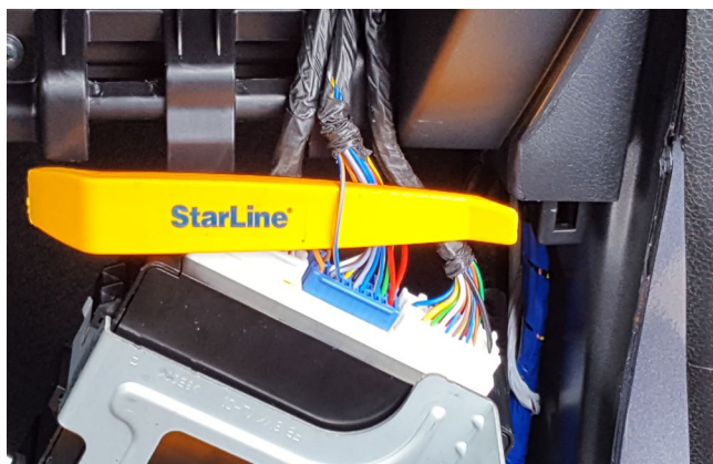
Фото 3.5. Шина данных штатного иммобилайзера (сине-оранжевый)
