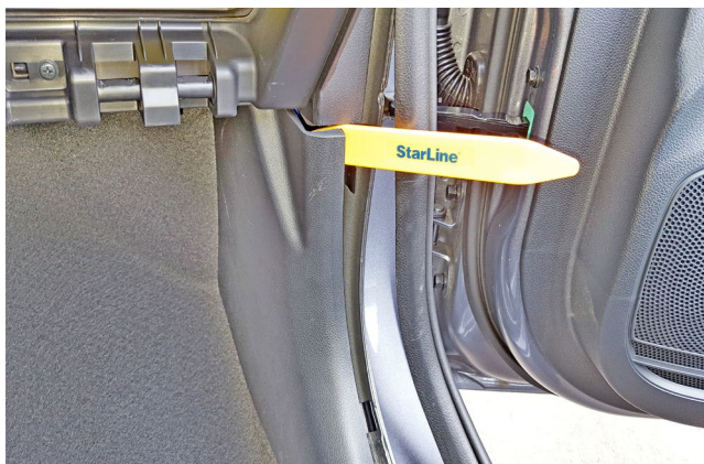
Фото 1.7. Снять накладку правой кик-панели
