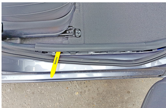
Фото 1.5. Снять накладку порога двери пассажира
