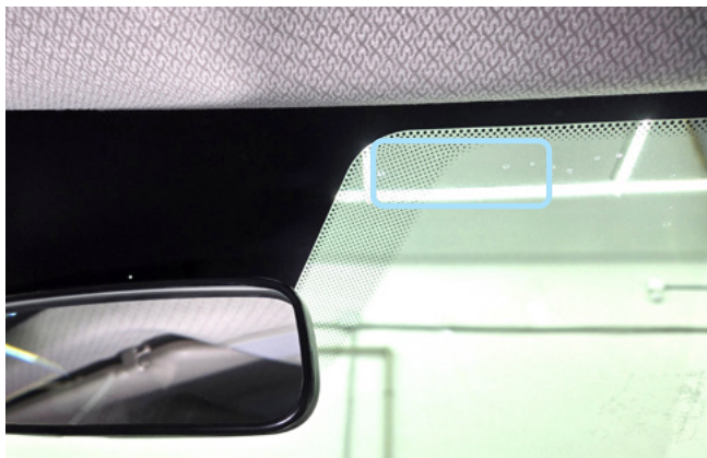
Фото 2.1. Возможное место установки антенны (сервисной кнопки)
