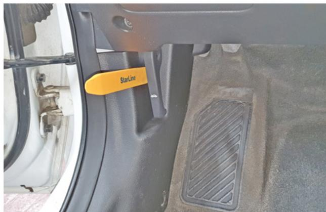
Фото 1.2. Снять ручку отпирания капота
