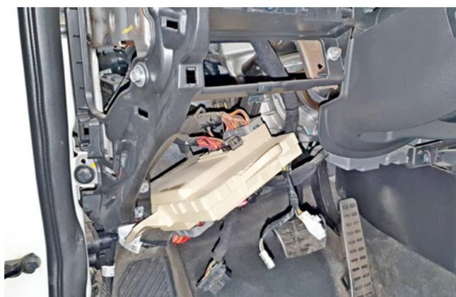
Фото 1.12. Монтажный блок предохранителей снят
