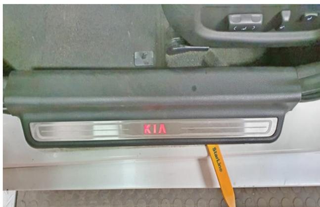
Фото 1.3. Снять накладку порога двери водителя
