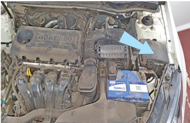
Фото 2.6. Возможное место установки подкапотного блока R6
