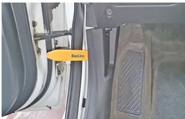
Фото 1.5. Снять накладку левой кик-панели
