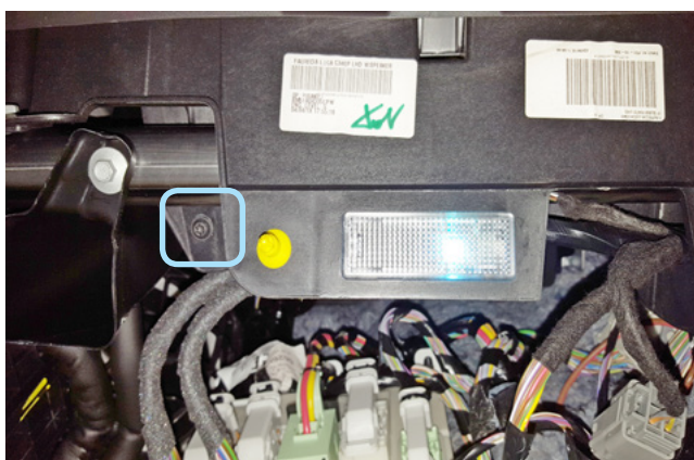
Фото 1.6. Саморез крепления перчаточного ящика слева
