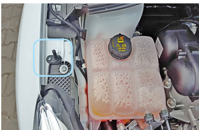
Фото 2.5. Возможное место установки концевика капота
