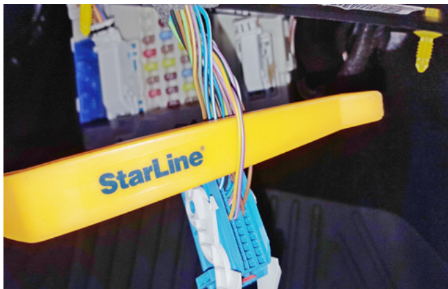
Фото 3.6. Шина данных штатного иммобилайзера (фиолетово-серый и жёлто-оранжевый)
