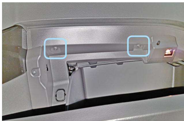
Фото 1.4. Саморезы крепления перчаточного ящика
