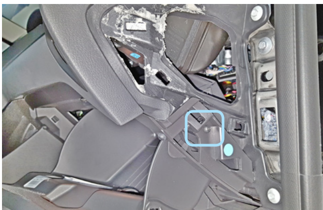
Фото 1.3. Боковая накладка снята. Саморез
