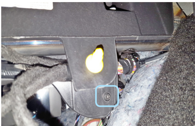
Фото 1.7. Саморез крепления перчаточного ящика справа
