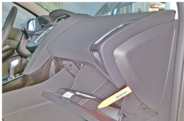
Фото 1.2. Снять боковую накладку передней панели
