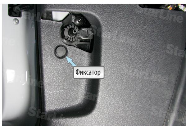
Фото 3.2. Фиксатор накладки кик панели
