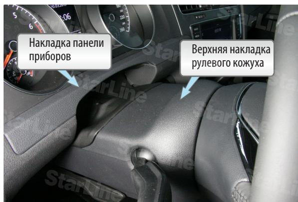
Фото 2.2. Верхняя накладка рулевого кожуха и накладке панели приборов.
