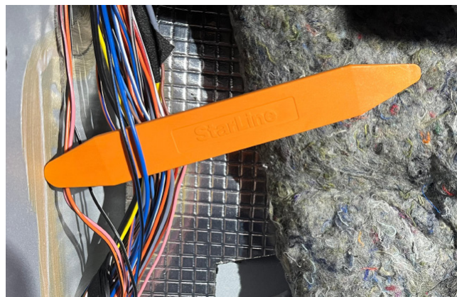
Фото 3.5. Световые сигналы (сине-чёрный и синий)
