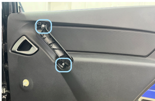
Фото 1.21. Накладка ручки двери и ручка стеклоподъёмника снята, саморезы крепления ручки.
