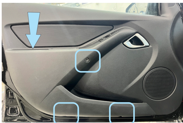
Фото 1.15. Центральная заглушка снята, саморезы крепления.
