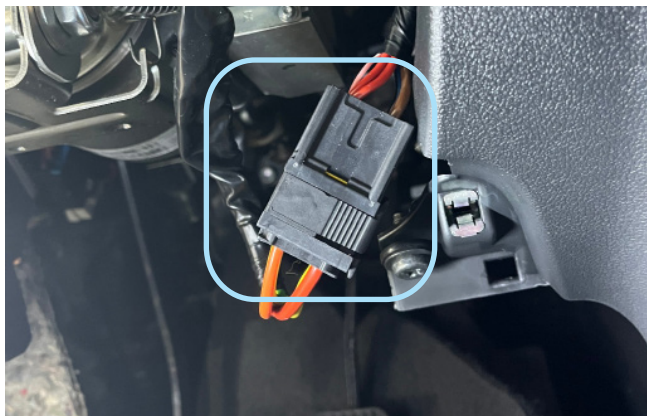
Фото 3.20. Местоположение разъёма замка зажигания
