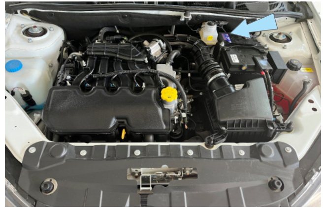
Фото 2.7. Место расположения штатного уплотнителя
