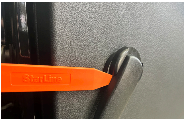
Фото 1.20. Снять ручку стеклоподъёмника
