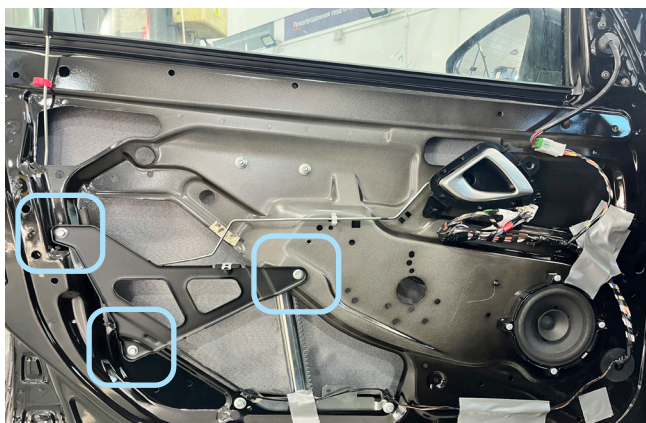
Фото 1.17. Обивка передней двери снята, открутить усилитель двери.
