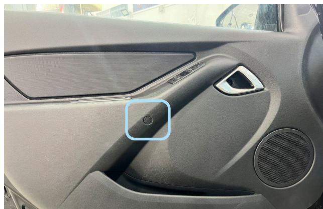
Фото 1.14. Снять центральную заглушку.
