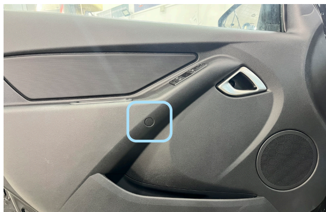
Фото 1.14. Снять центральную заглушку.
