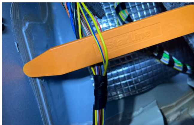
Фото 3.6. Провода управление центрального замка (жёлтый и жёлто-синий)
