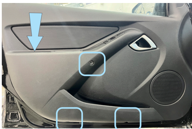
Фото 1.15. Центральная заглушка снята, саморезы крепления.
