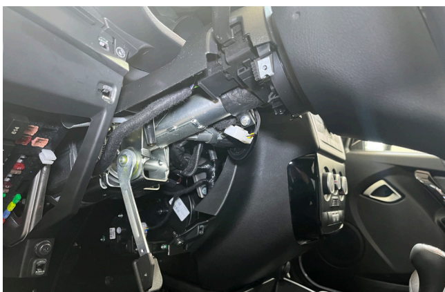
Фото 1.7. Кожуха рулевого вала снят
