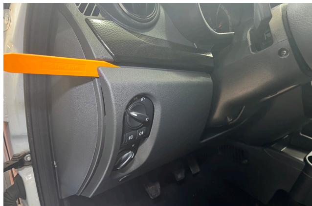
Фото 1.2. Снять пластиковую накладку
