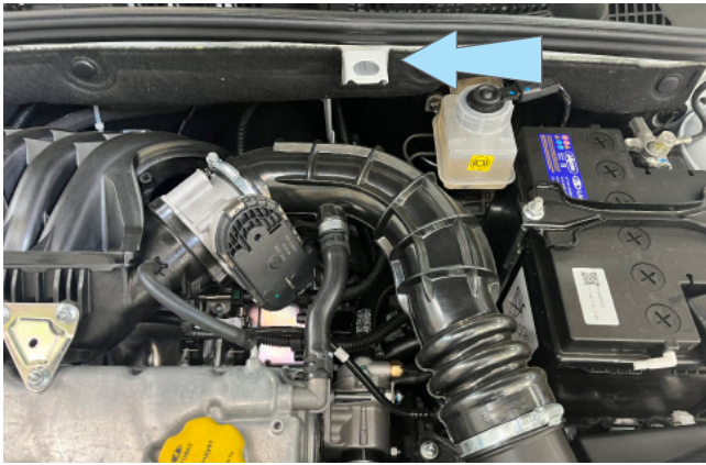
Фото 2.6. Место установки концевика капота
