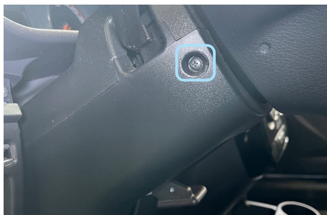
Фото 1.4. Саморез крепления кожуха рулевого вала. Слева
