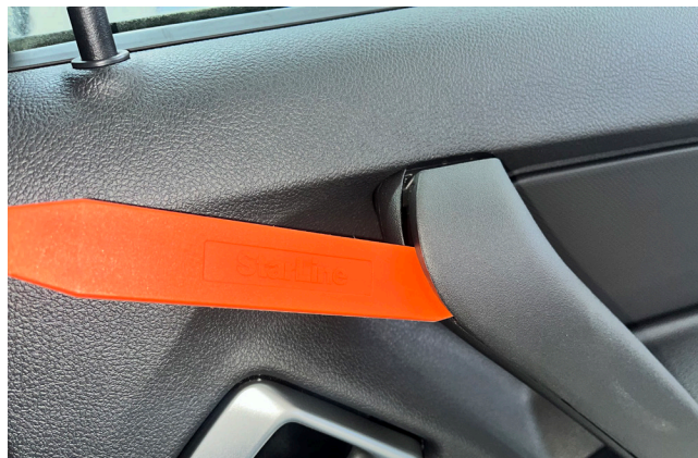
Фото 1.19. Снять накладку ручки двери
