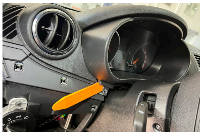
Фото 1.10. Снять декоративную накладку приборной панели
