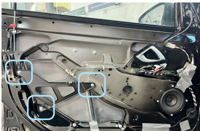
Фото 1.17. Обивка передней двери снята, открутить усилитель двери.
