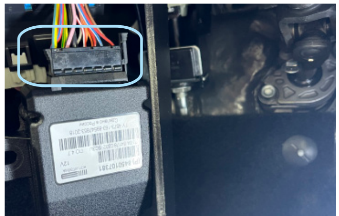
Фото 3.13. Разъём блока комфорта
