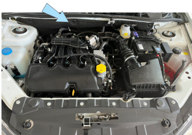
Фото 2.2. Возможное место установки сирены
