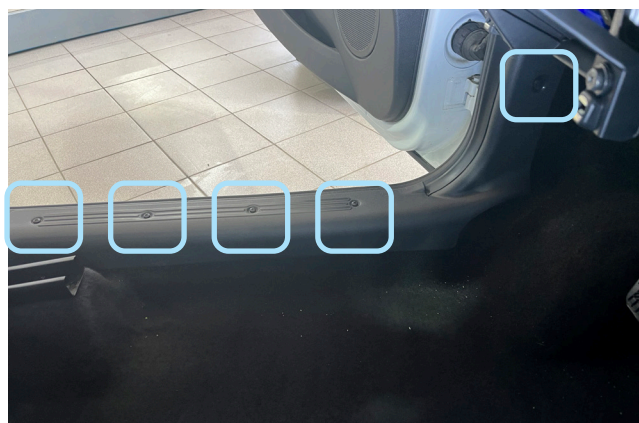
Фото 1.8. Саморезы крепления накладки порога водителя
