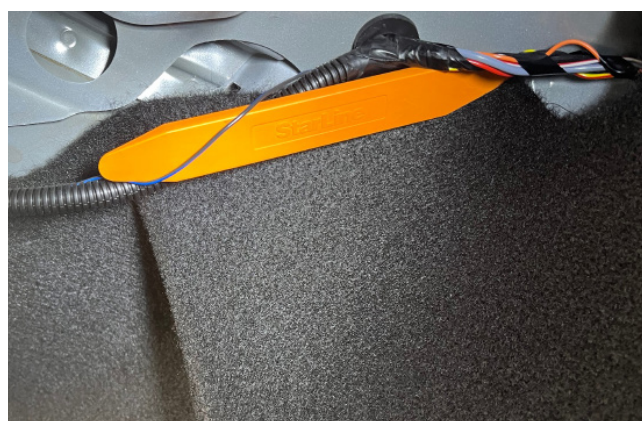
Фото 3.9. Концевик багажника (сине-чёрный)
