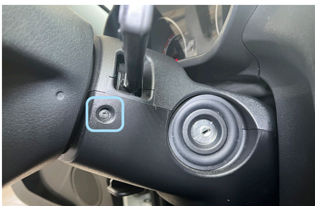
Фото 1.5. Саморез крепления кожуха рулевого вала. Справа
