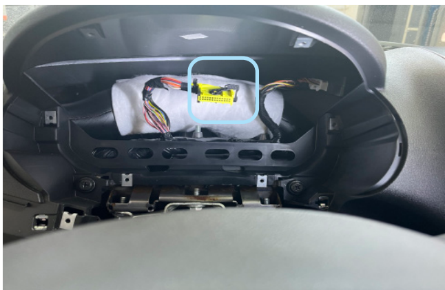
Фото 3.2. Местоположение разъёма панели приборов
