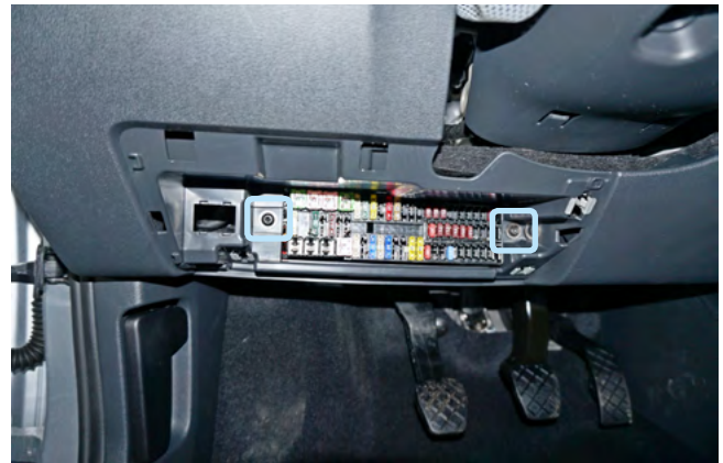
Фото 1.15. Винты крепления блока предохранителей
