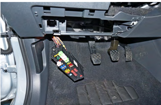
Фото 1.16. Монтажный блок предохранителей снят
