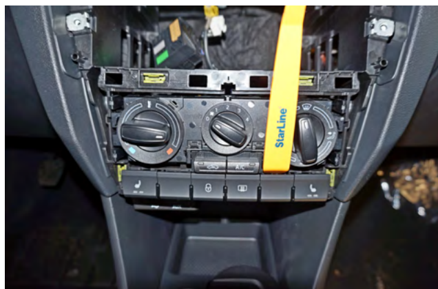
Фото 1.12. Снять блок кнопок
