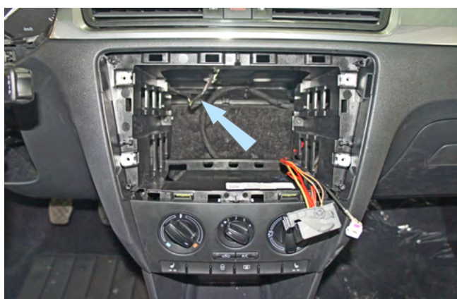
Фото 3.6. Местоположение жгута разъёма кнопки аварийной сигнализации
