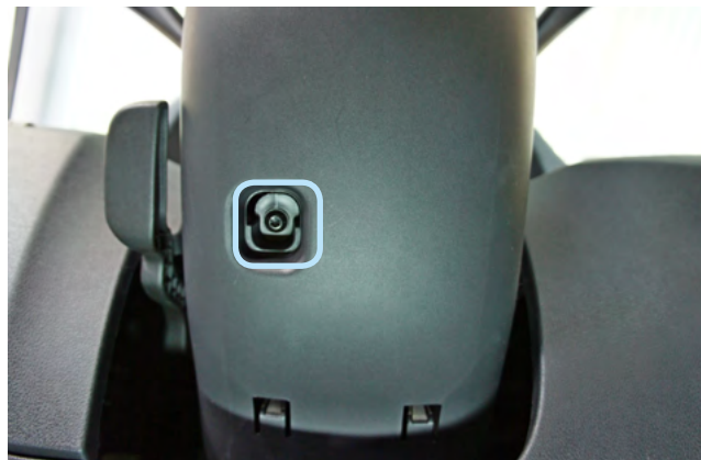
Фото 1.2. Винт крепления нижней части кожуха
