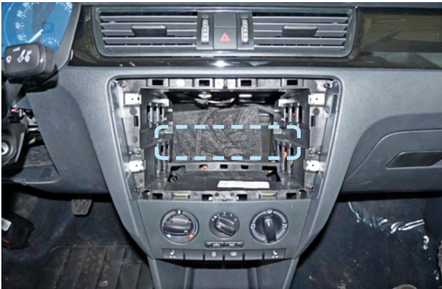
Фото 2.7. Пример расположения центрального блока охранно-телематического комплекса
