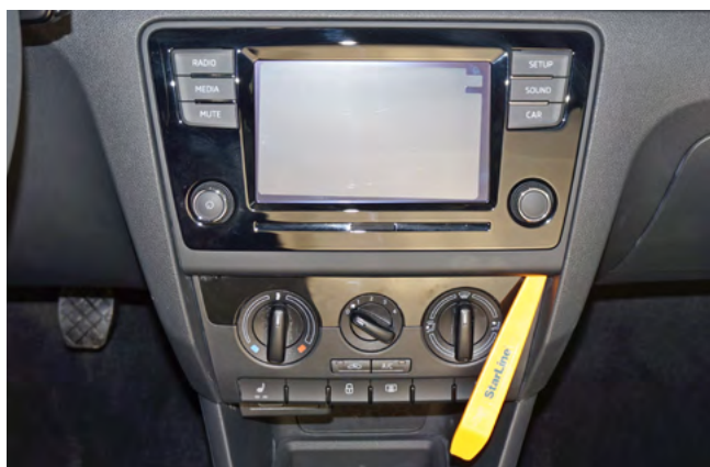
Фото 1.5. Снять декоративную накладку
