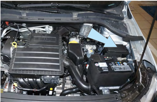
Фото 2.6. Возможное место установки подкапотного блока R6
