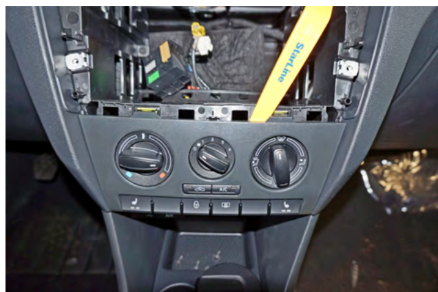
Фото 1.10. Снять декоративную накладку блока управления климат-контролем
