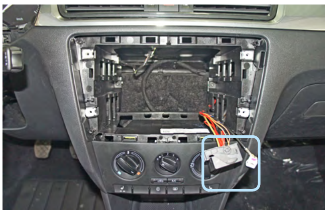
Фото 3.2. Местоположение разъёма магнитолы
