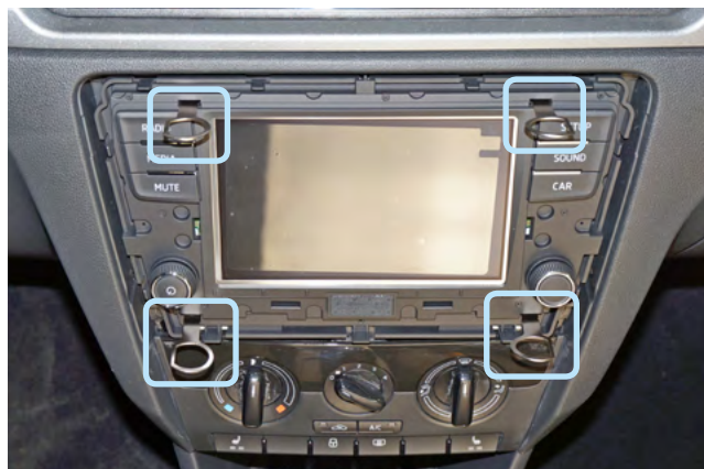
Фото 1.8. Установить ключи для снятия магнитолы
