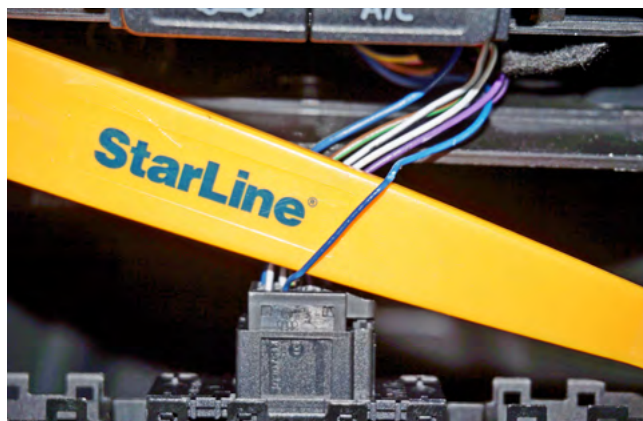
Фото 3.9. Альтернативное управление центральным замком (синий)
