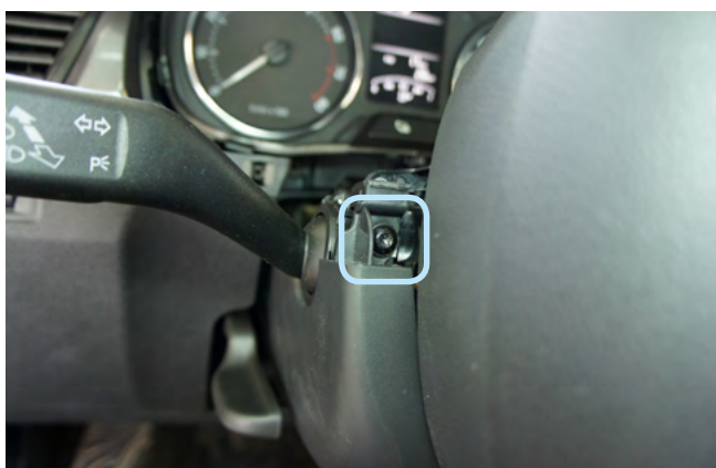
Фото 1.3. Винт крепления нижней части кожуха
