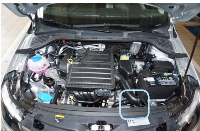
Фото 2.3. Место установки датчика температуры двигателя
