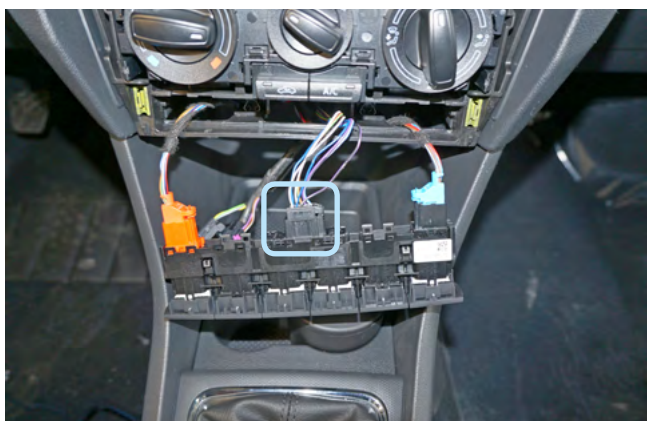
Фото 3.8. Расположение разъёма на блоке кнопок
