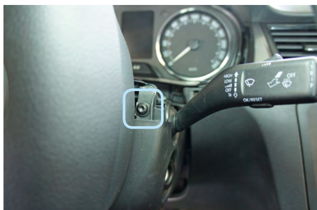
Фото 1.4. Винт крепления нижней части кожуха
