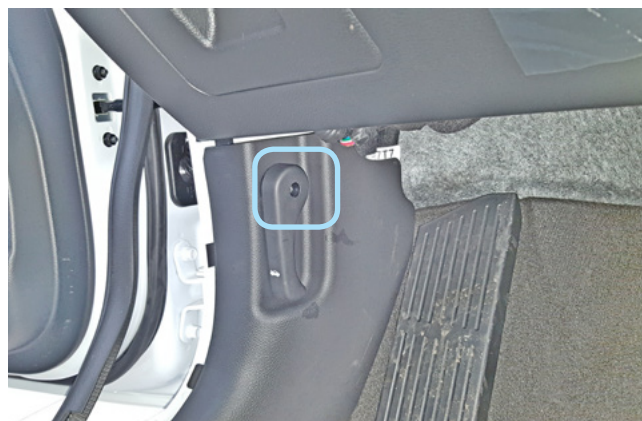
Фото 1.2. Крепление ручки отпирания капота
