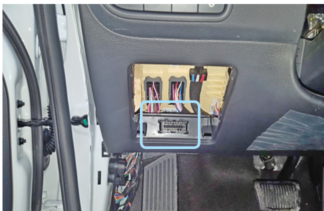
Фото 3.4. Местоположение диагностического разъёма
