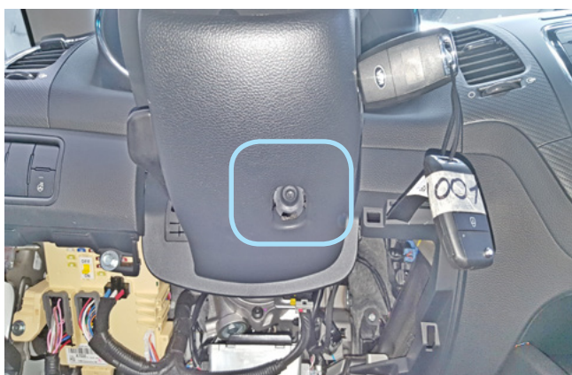
Фото 1.15. Саморез крепления нижней части кожуха рулевого вала снизу
