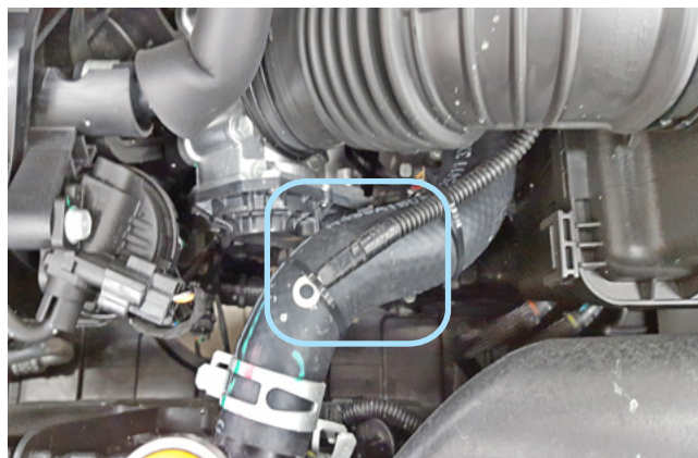
Фото 2.6. Крепление датчика температуры двигателя
