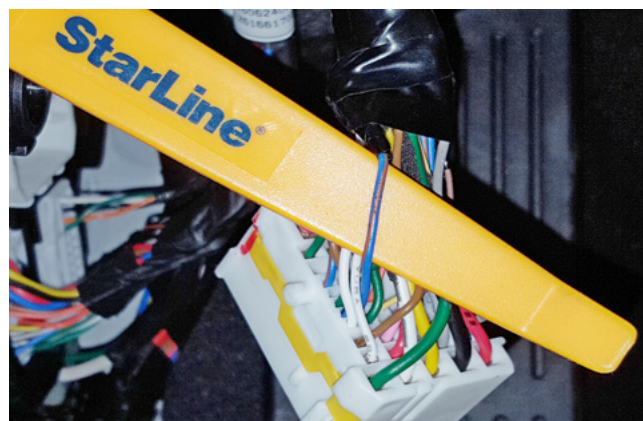
Фото 3.7. Шина данных штатного иммобилайзера (сине-оранжевый)
