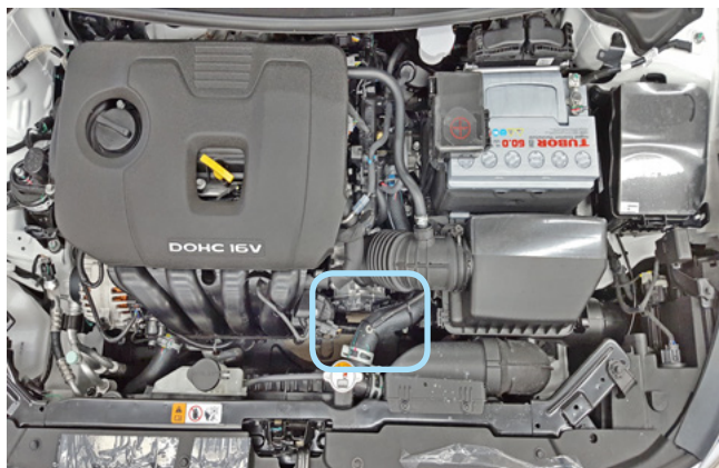
Фото 2.5. Место установки датчика температуры двигателя
