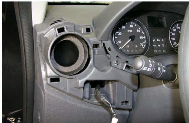
Фото 1.2. Декоративная накладка с воздуховодом снята
