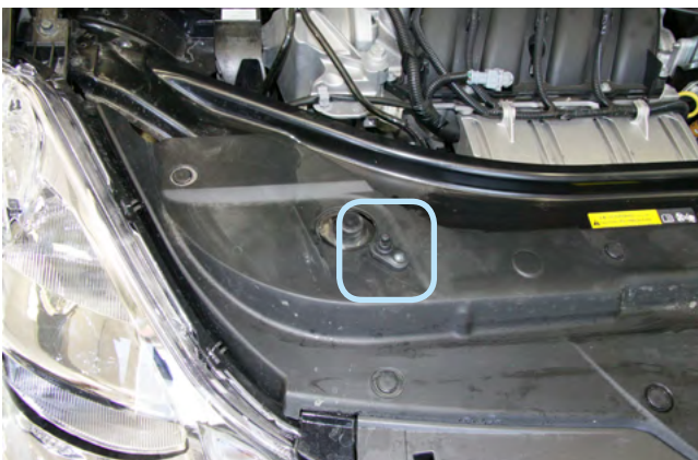
Фото 2.7. Возможное место установки концевика капота
