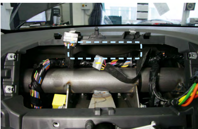
Фото 2.9. Пример расположения центрального блока охранно-телематического комплекса
