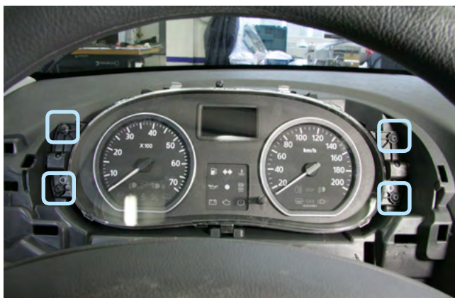
Фото 1.13. Накладка панели приборов снята. Саморезы крепления панели приборов
