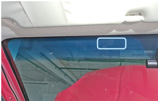
Фото 2.1. Возможное место установки антенного модуля
