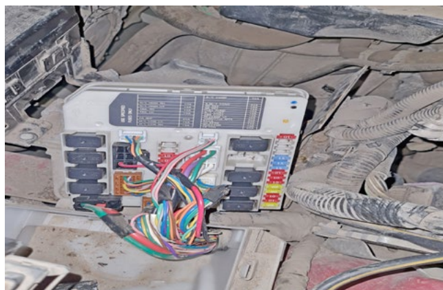
Фото 3.11. Местоположение разъемов на блоке IPDM
