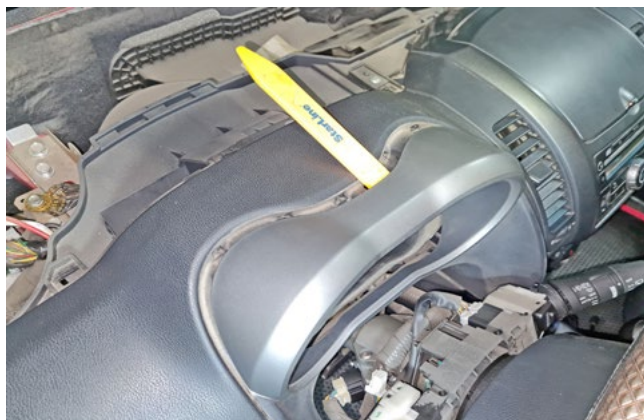
Фото 1.13. Снять декоративную накладку панели приборов
