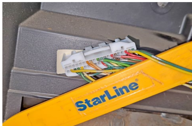
Фото 3.3. Шина CAN-A (зелёный и жёлтый)
