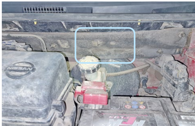
Фото 2.3. Возможное место установки сирены
