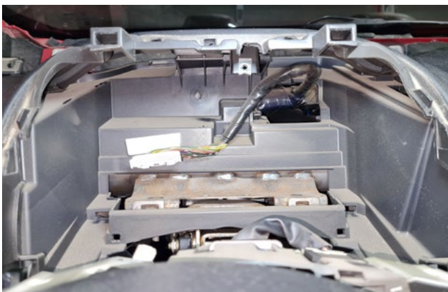
Фото 1.16. Панель приборов снята
