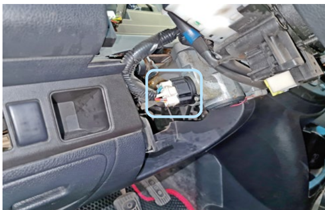
Фото 3.5. Местоположение разъёма замка зажигания
