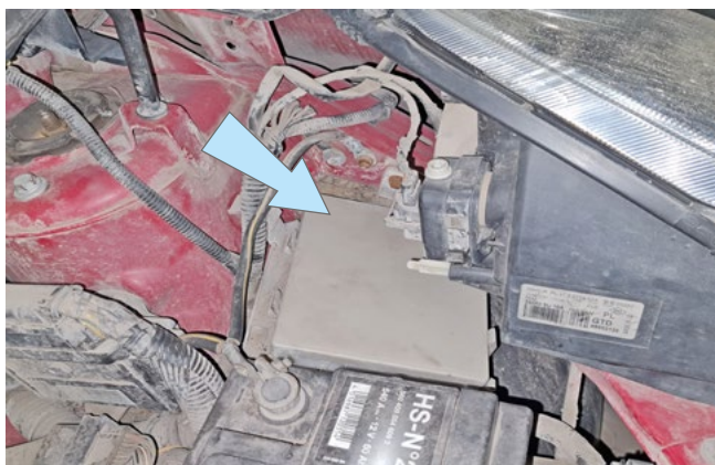
Фото 3.10. Местоположение блока IPDM
