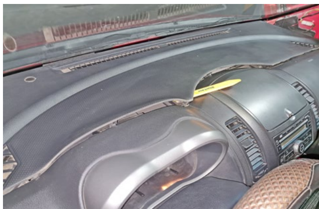
Фото 1.6. Снять верхнюю накладку передней панели
