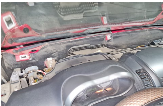
Фото 1.7. Верхняя накладка передней панели снята
