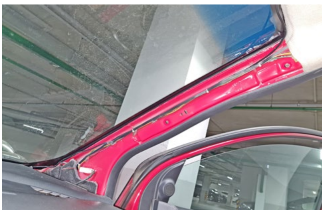
Фото 1.5. Правая боковая накладка передней стойки лобового стекла снята
