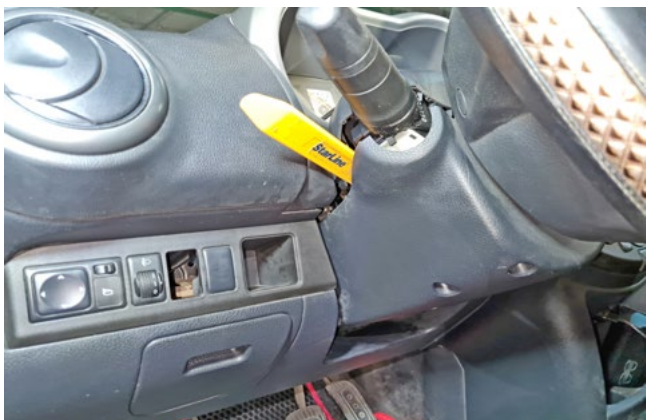
Фото 1.10. Снять кожух рулевого вала
