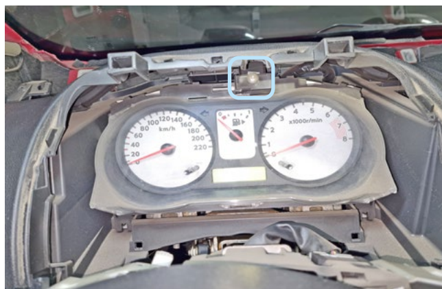
Фото 1.15. Декоративная накладка снята. Саморез крепления панели приборов
