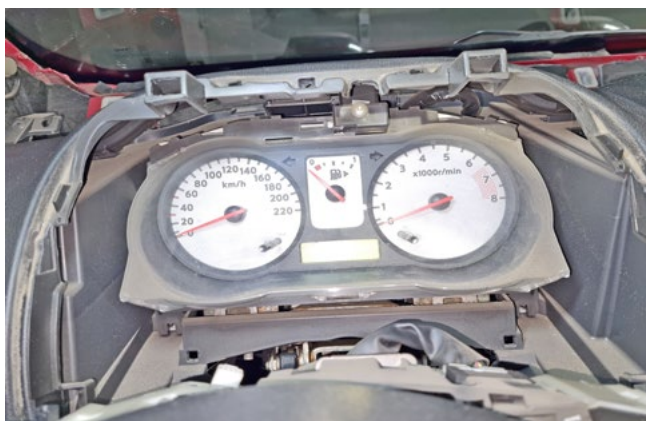
Фото 1.14. Декоративная накладка снята
