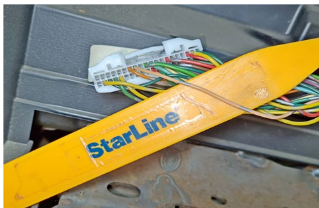
Фото 3.4. Управление индикатором штатного иммобилайзера (розовый)
