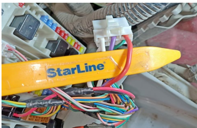
Фото 3.14. Выход на реле стартера «+» (красный)
