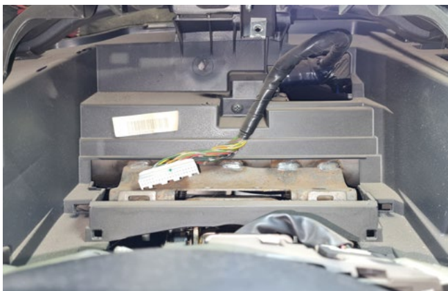
Фото 3.2. Местоположение разъёма панели приборов
