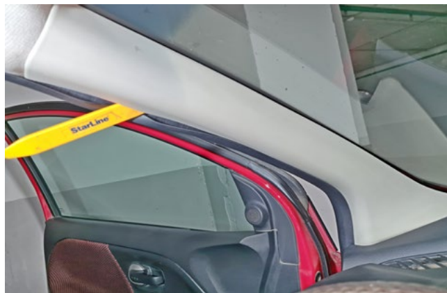
Фото 1.2. Снять левую боковую накладку передней стойки лобового стекла
