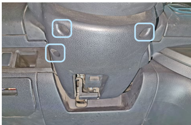
Фото 1.9. Саморезы крепления кожуха
