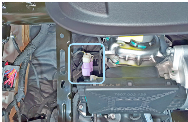
Фото 3.9. Местоположение разъёма концевика педали сцепления
