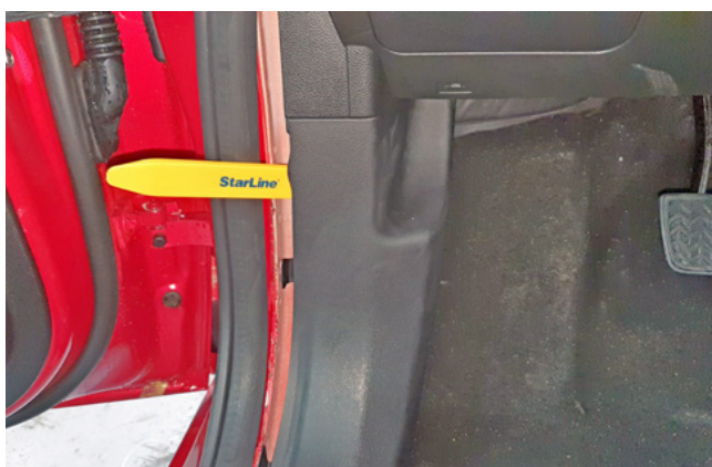
Фото 1.5. Снять накладку левой кик-панели
