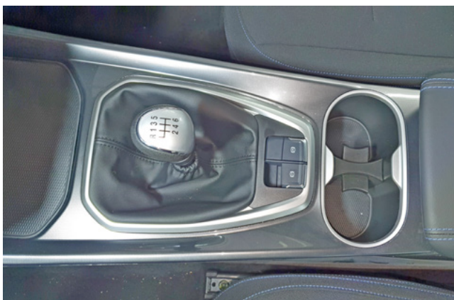
Фото 1.16. Верхняя накладка центрального тоннеля. Общий вид
