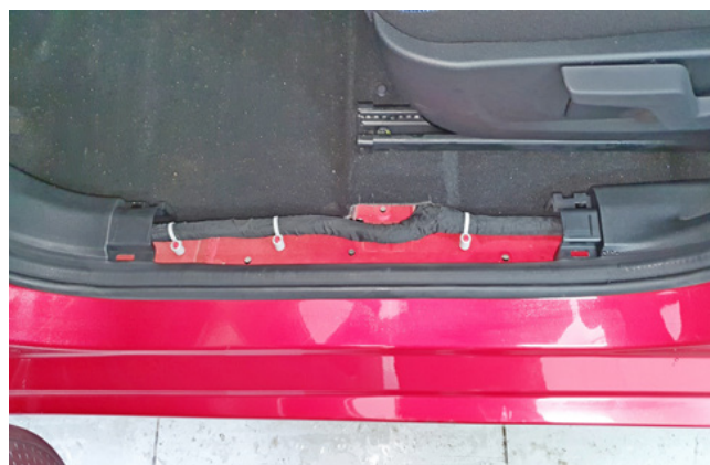
Фото 1.4. Накладка порога двери водителя снята
