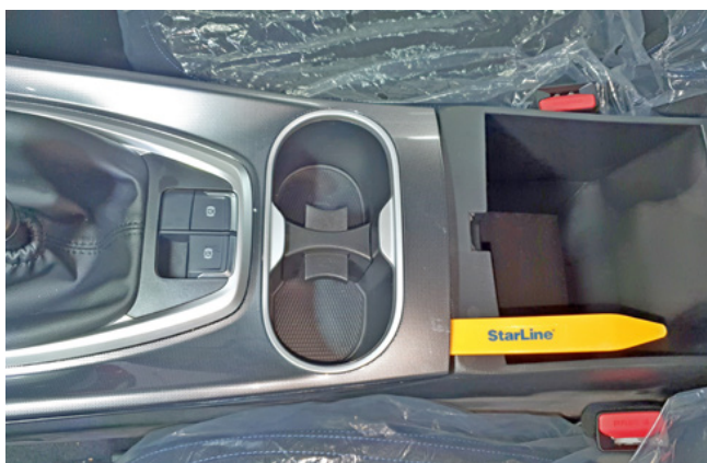
Фото 1.18. Снять верхнюю накладку центрального тоннеля
