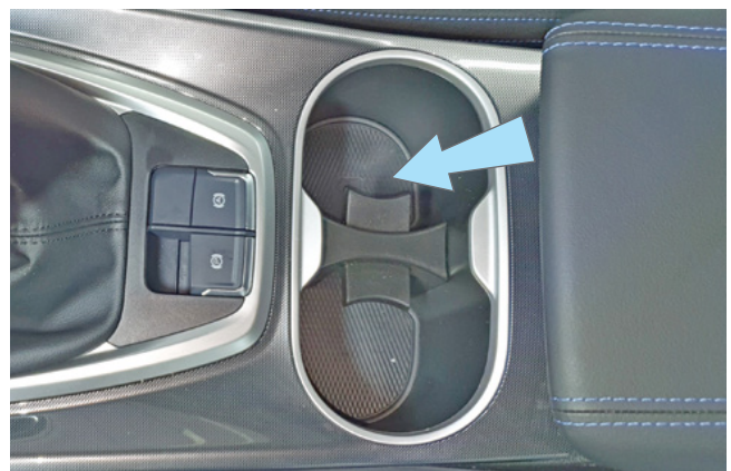
Фото 1.17. Местоположение антенны штатного иммобилайзера
