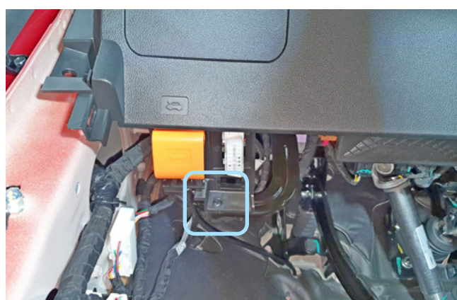
Фото 1.9. Саморез в нижней части накладки
