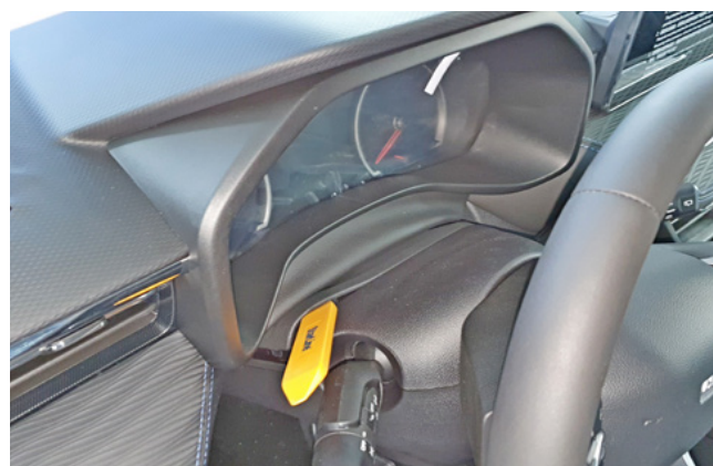
Фото 1.12. Снять пылезащитный кожух рулевой колонки
