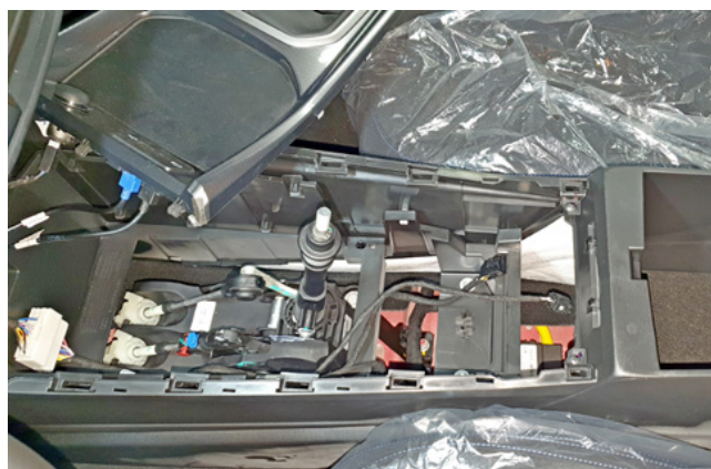
Фото 1.19. Верхняя накладка центрального тоннеля снята
