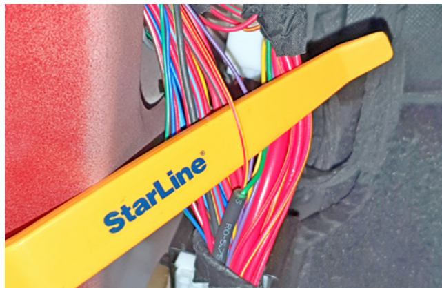
Фото 3.6. Управление центральным замком (жёлто-красный)
