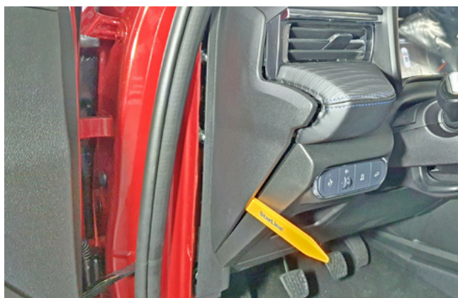
Фото 1.7. Снять боковую накладку передней панели
