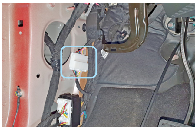
Фото 3.2. Местоположение разъёма P34
