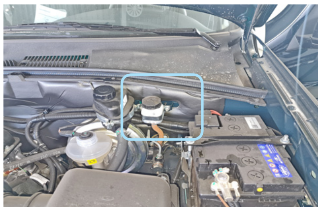
Фото 2.2. Возможное место установки сирены
