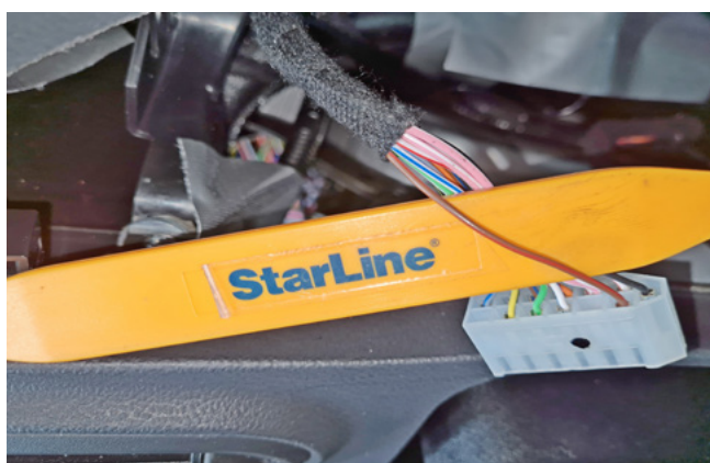
Фото 3.4. Контроль работы двигателя (коричнево-красный)
