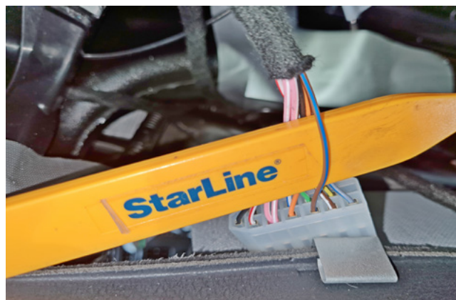
Фото 3.3. Контроль стояночного тормоза (коричнево-синий)
