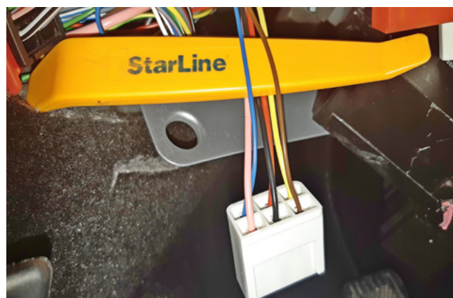
Фото 3.13. Управление центральным замком (синий и коричневый)
