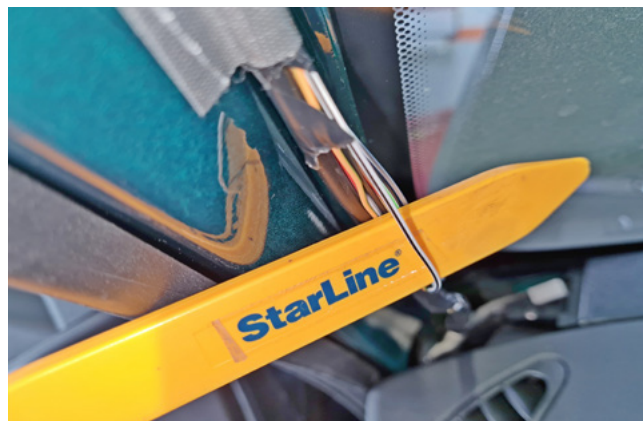
Фото 3.9. Контроль дверей (бело-чёрный)
