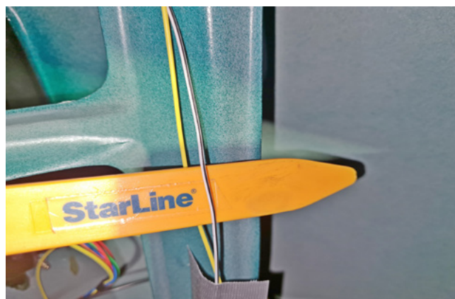
Фото 3.11. Контроль концевика багажника (бело-чёрный)
