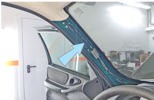
Фото 3.8. Местоположение жгута в левой стойке
