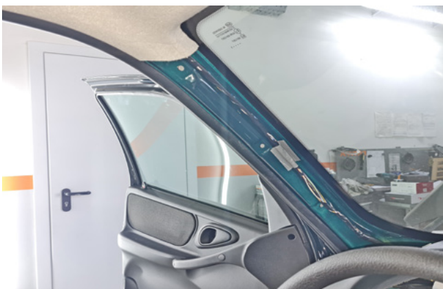
Фото 1.22. Накладка стойки снята
