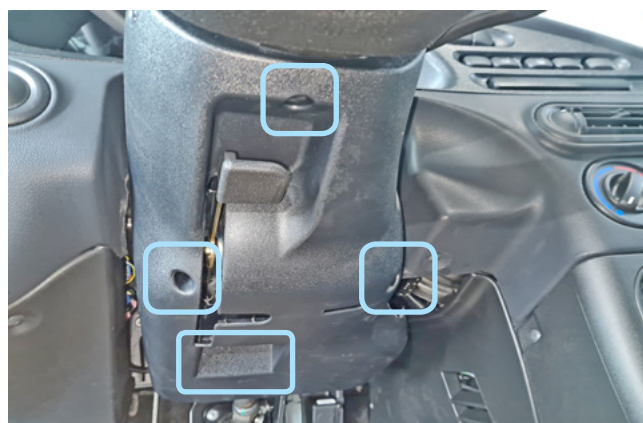
Фото 1.4. Саморезы и винты крепления нижней части кожуха рулевого вала снизу
