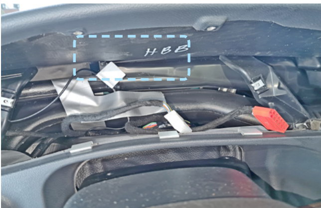
Фото 2.9. Пример расположения центрального блока охранно-телематического комплекса
