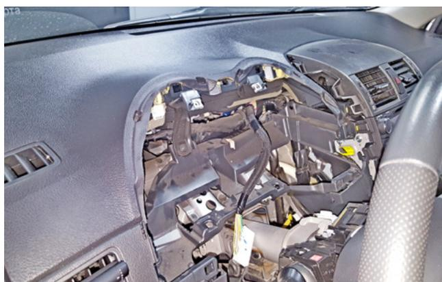
Фото 1.22. Панель приборов снята
