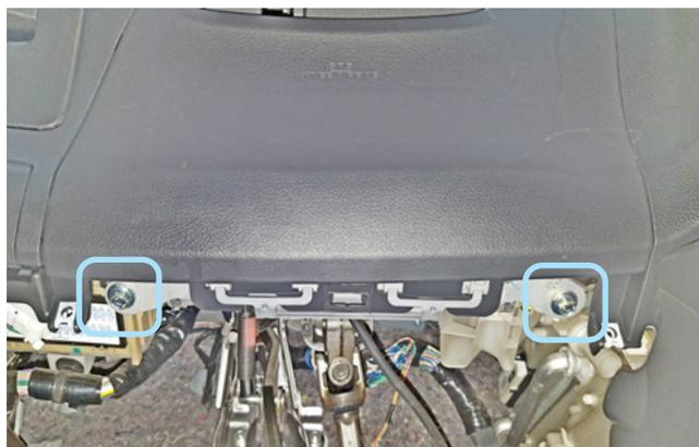
Фото 1.13. Болты крепления подушки безопасности снизу
