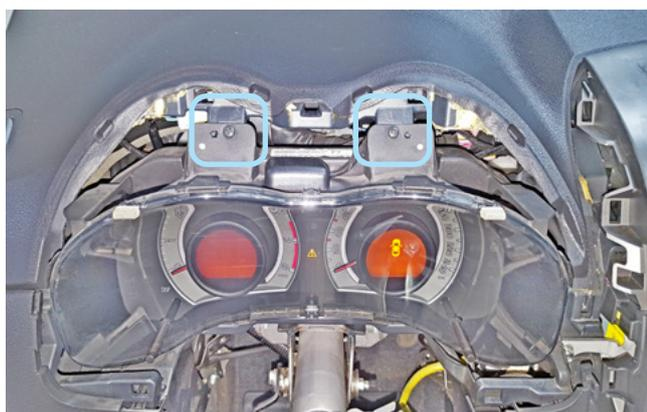
Фото 1.21. Накладка снята. Саморезы крепления панели приборов
