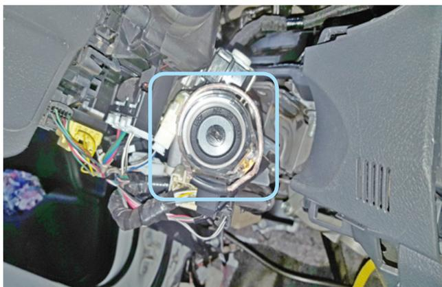
Фото 3.11. Расположение антенны модуля ВР-03 на замке зажигания
