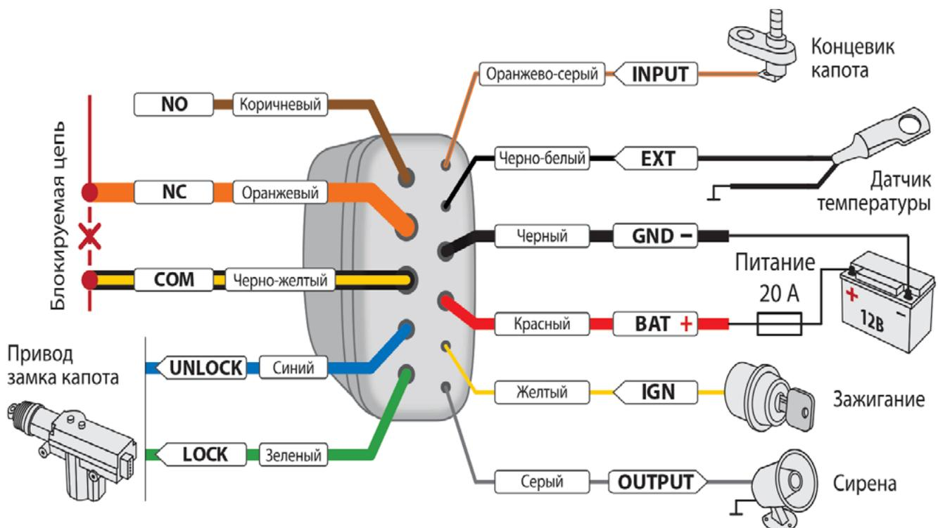
Центральный блок охранно-телематического комплекса StarLine закрепить на пластиковые стяжки за панелью приборов. **Внимание!!! Не размещайте центральный блок на расстоянии менее 10 см от металлических частей кузова автомобиля во избежание плохого качества приёма сигнала GSM и Bluetooth!**
