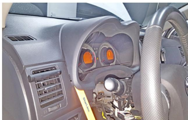
Фото 1.20. Снять накладку панели приборов
