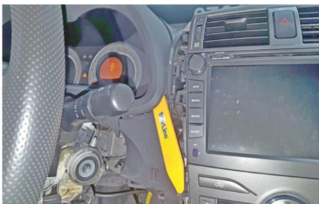
Фото 1.19. Снять накладку панели приборов
