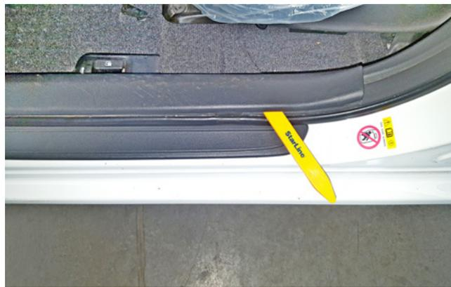
Фото 1.2. Снять накладку порога двери водителя
