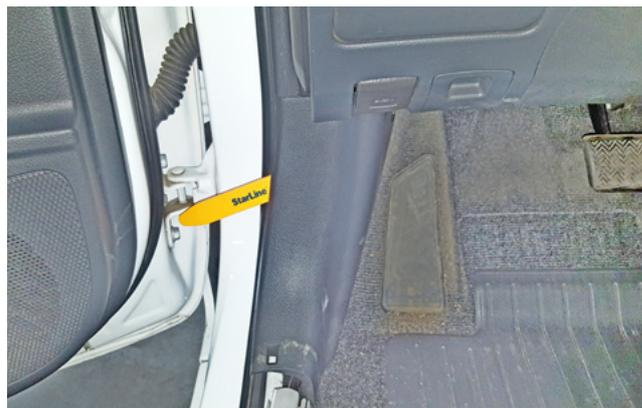
Фото 1.4. Снять накладку левой кик-панели
