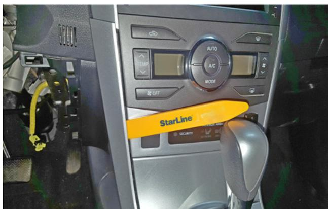
Фото 1.17. Снять нижнюю накладку центральной консоли
