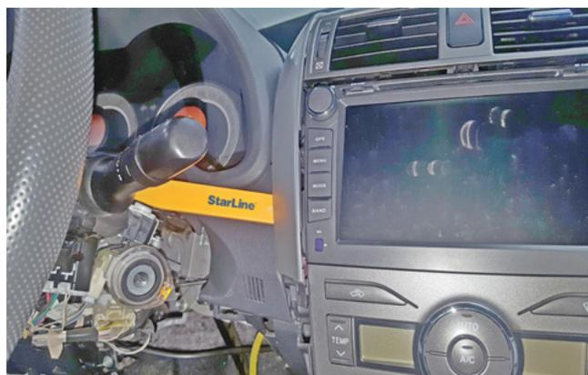
Фото 1.18. Снять верхнюю накладку центральной консоли
