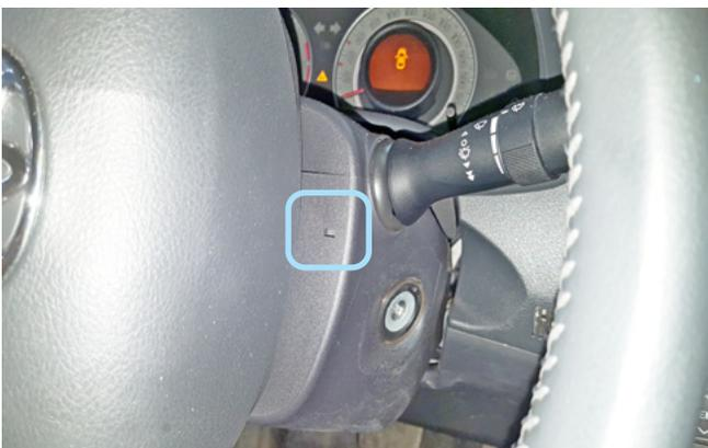
Фото 1.9. Фиксатор нижней части кожуха справа
