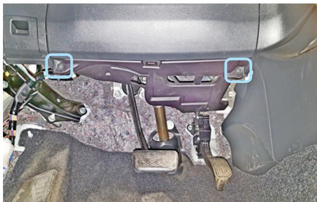
Фото 1.6. Саморезы крепления накладки педального узла
