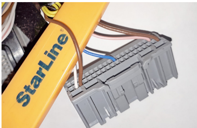
Фото 3.7. Управление реле стартера (коричневый)
