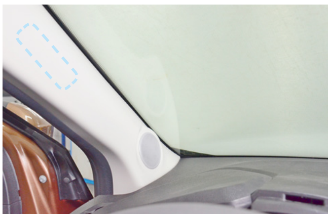
Фото 2.1. Возможное место установки антенного модуля
