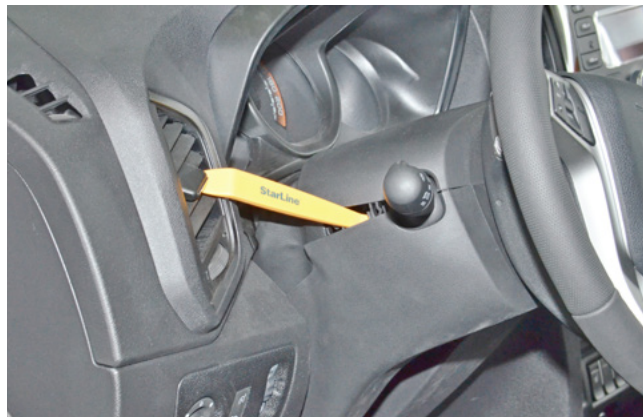
Фото 1.2. Снять кожух рулевого вала
