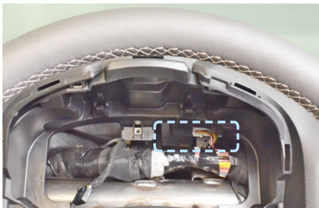
Фото 2.8. Пример расположения центрального блока охранно-телематического комплекса
