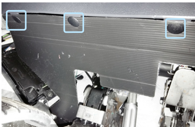
Фото 1.6 Клипсы крепления декоративной накладки педального узла
