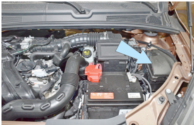
Фото 2.7. Возможное место установки подкапотного блока R6
