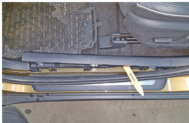
Фото 1.3. Снять накладку порога двери водителя
