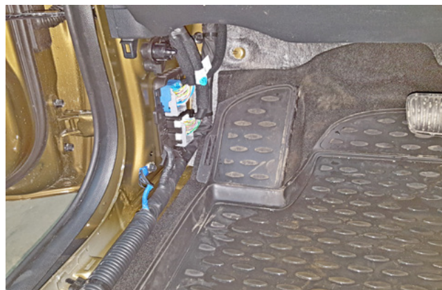
Фото 1.4. Накладка левой кик-панели снята
