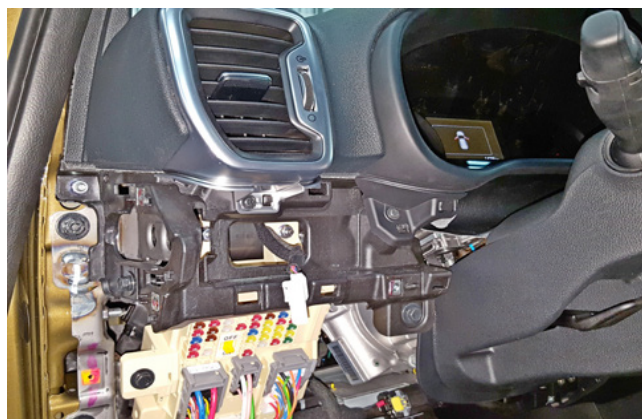
Фото 1.10. Блок кнопок снят
