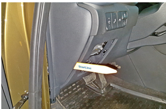
Фото 1.5. Снять боковую накладку передней панели
