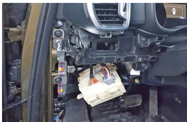
Фото 1.12. Монтажный блок предохранителей снят
