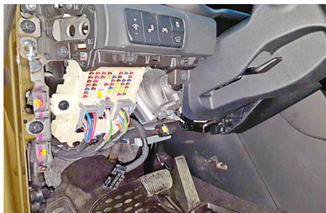
Фото 1.8. Пластиковая накладка под рулевой колонкой снята
