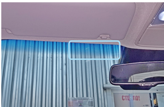
Фото 2.1. Возможное место установки антенного модуля
