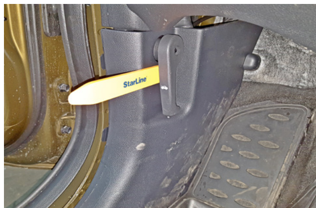
Фото 1.2. Снять ручку отпирания капота
