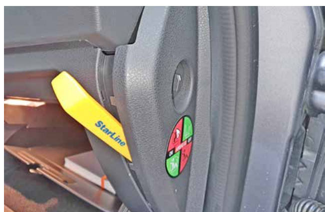
Фото 1.5. Снять правую накладку передней панели
