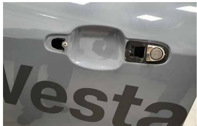
Фото 1.18. Ручка двери водителя снята
