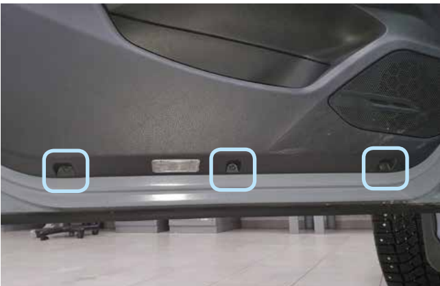
Фото 1.15. Саморезы крепления внутренней обшивки двери водителя
