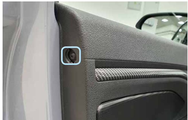
Фото 1.14. Саморез крепления внутренней обшивки двери водителя
