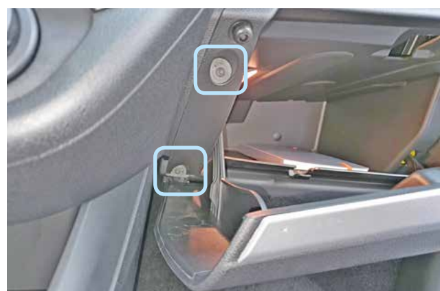
Фото 1.6. Саморезы крепления перчаточного ящика слева
