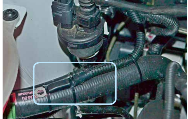
Фото 2.5. Крепление датчика температуры двигателя
