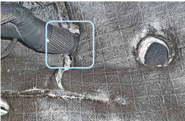
Фото 2.6. Штатный уплотнитель. Вид со стороны салона
