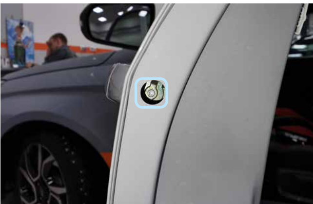
Фото 1.17. Саморез крепления ручки двери водителя
