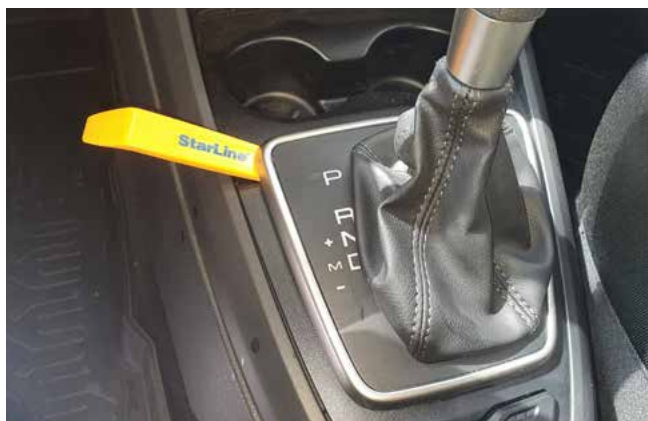
Фото 1.19. Снять накладку коробки передач
