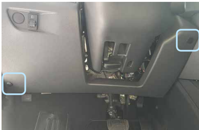
Фото 1.1. Клипсы крепления накладки под рулевой колонкой
