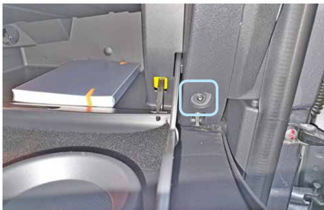
Фото 1.7. Саморез крепления перчаточного ящика справа
