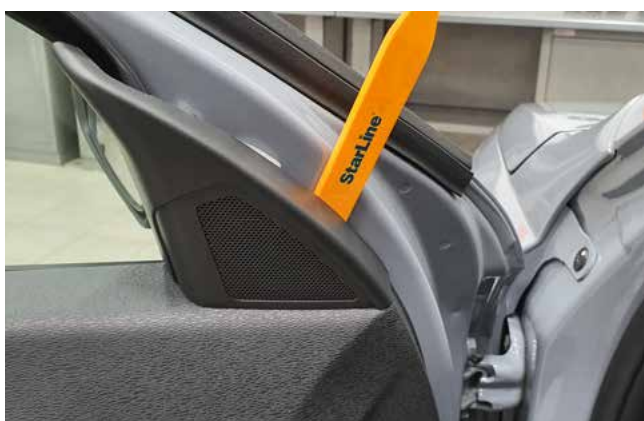
Фото 1.9. Снять пластиковую накладку динамика
