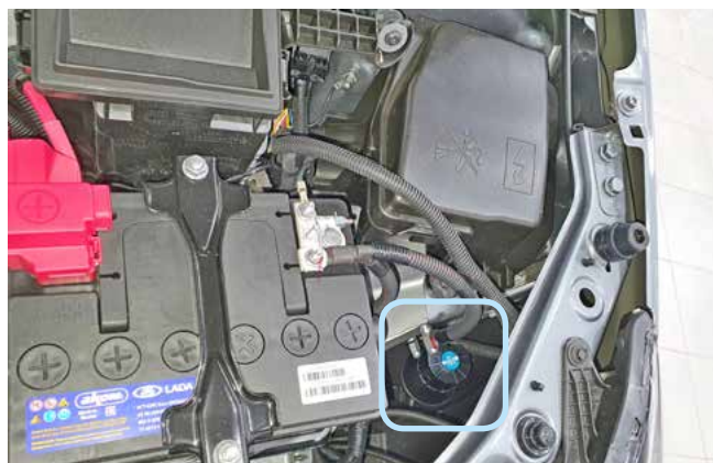
Фото 2.2. Возможное место установки сирены
