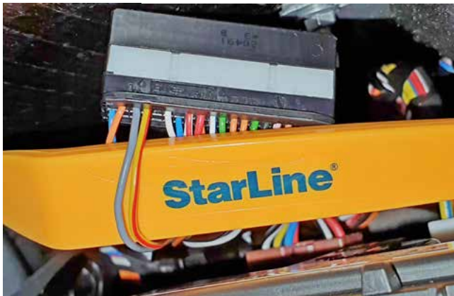
Фото 3.4. Шина CAN-A (жёлто-красный и серый)
