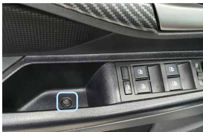
Фото 1.11. Саморез крепления ручки двери водителя
