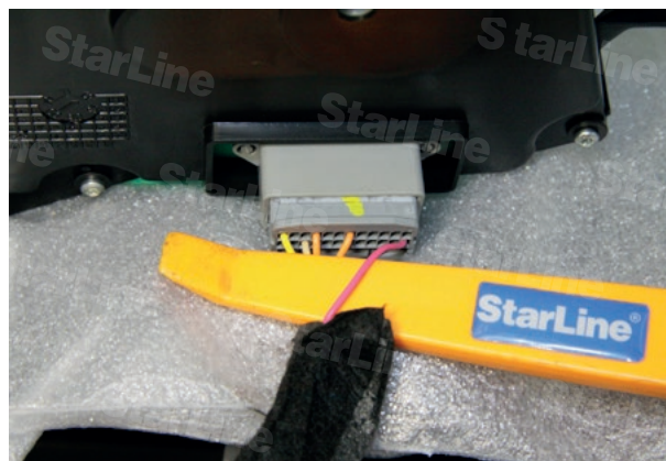
Фото 9.2. Контроль концевиков дверей и багажника (розовый)
