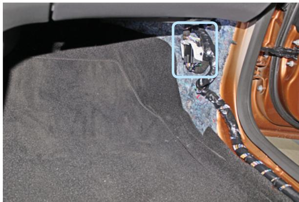
Фото 11.3. Местоположение разъёма
