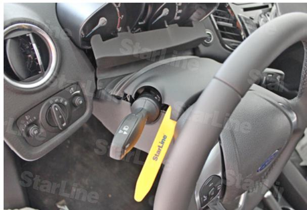
Фото 3.4. Снять верхнюю часть кожуха
