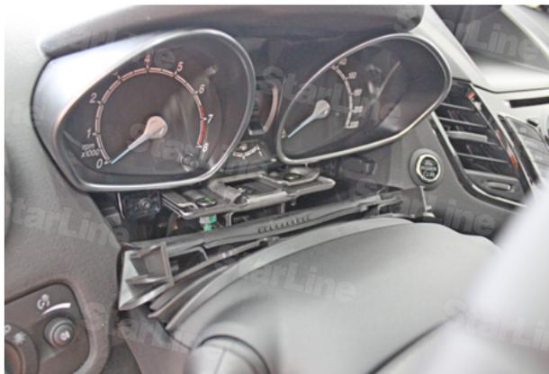
Фото 3.3. Нижняя декоративная накладка панели приборов снята
