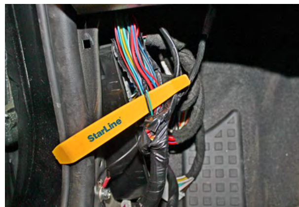
Фото 11.2. Управление центральным замком (зелёно-красный и чёрно-синий)
