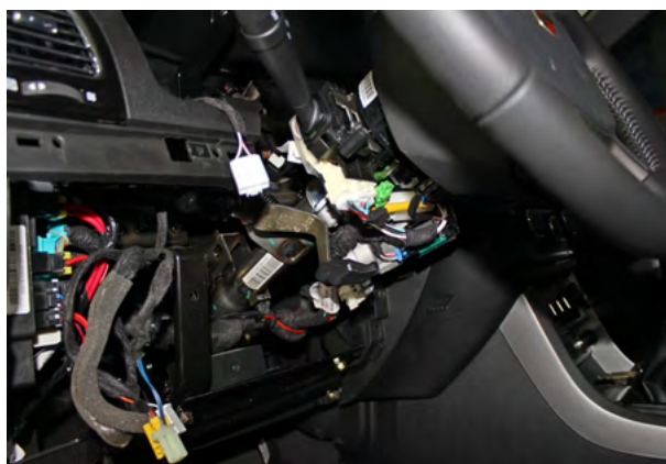
Фото 3.6. Нижняя часть кожаного рулевого вала снята
