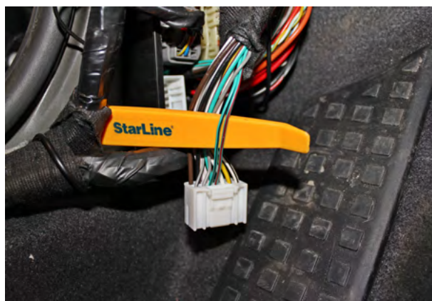
Фото 10.2. Управление световыми сигналами (зелёно-красный и зелёно-чёрный)
