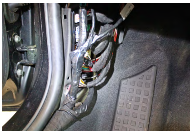
Фото 4.5. Накладка кик-панели снята
