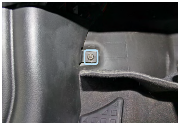
Фото 4.4. Гайка крепления накладки кик-панели
