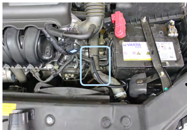
Фото 6.4. Крепление датчика температуры двигателя
