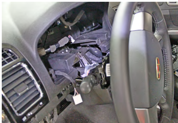
Фото 3.4. Верхняя часть кожаного рулевого вала снята
