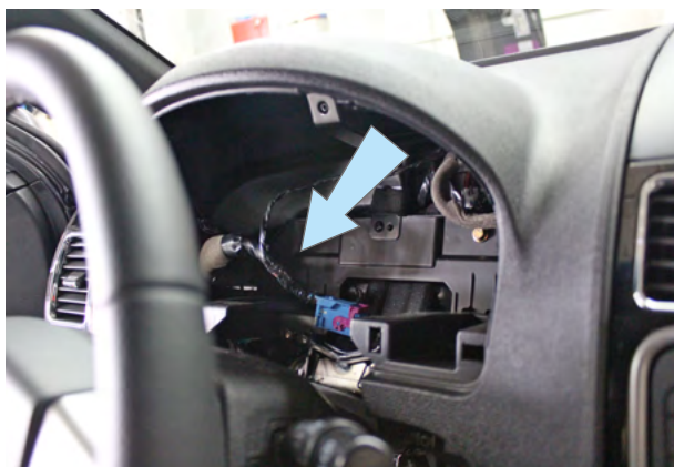
Фото 9.1. Местоположение жгута разъёма панели приборов
