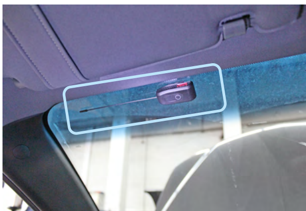
Фото 5.1. Возможное место установки антенного модуля
