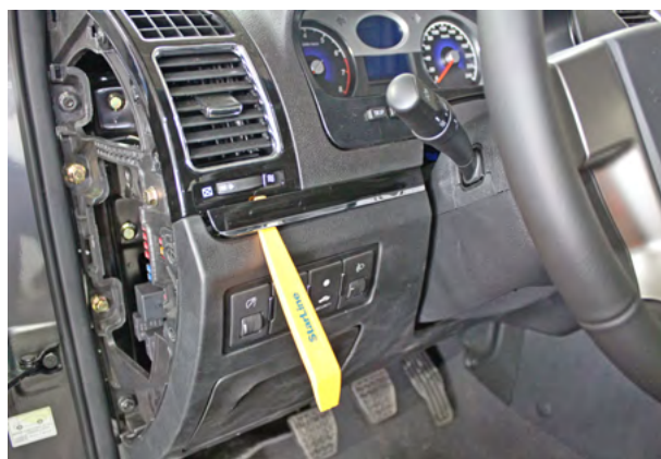
Фото 1.4. Снять декоративную накладку слева от рулевой колонки
