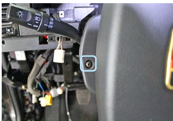
Фото 3.2. Саморез крепления верхней части кожуха рулевого вала слева
