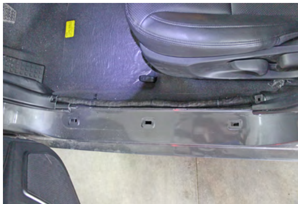
Фото 4.3. Пластиковая накладка порога двери водителя снята
