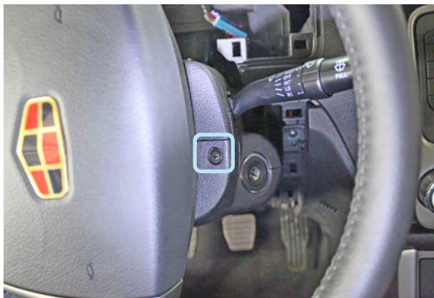
Фото 3.3. Саморез крепления верхней части кожаного рулевого вала справа
