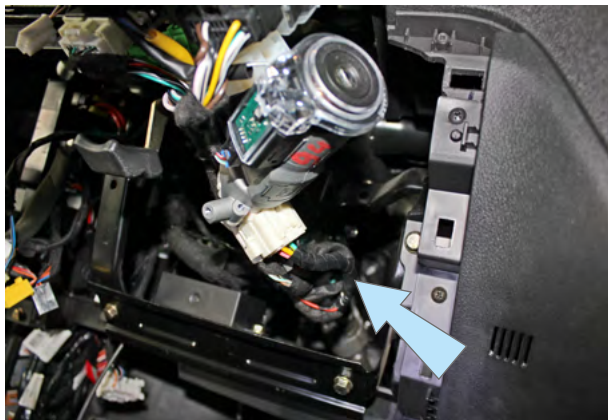
Фото 13.1. Местоположение жгута разъёма замка зажигания
