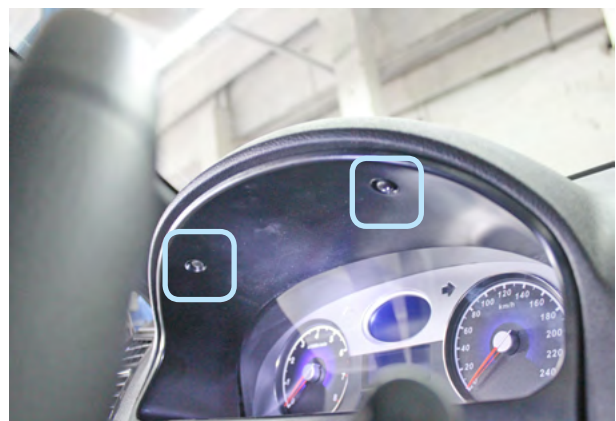
Фото 2.2. Саморезы крепления декоративной накладки панели приборов
