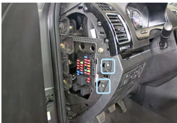
Фото 1.3. Левая боковая накладка снята. Саморезы
