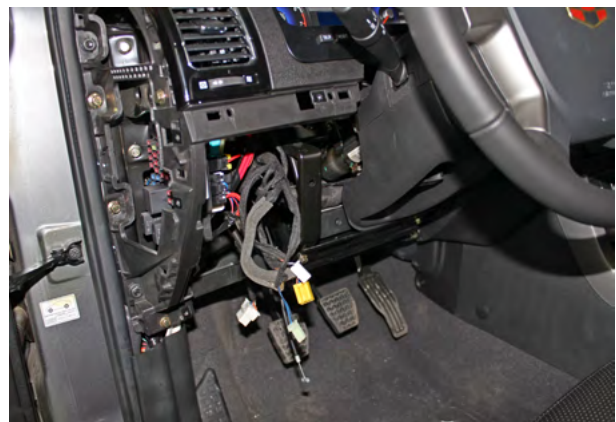
Фото 1.10. Пластиковая накладка под рулевой колонкой снята
