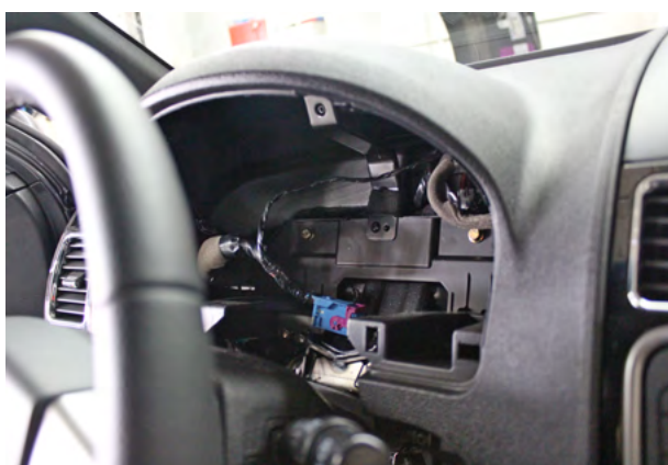
Фото 2.5. Панель приборов снята
