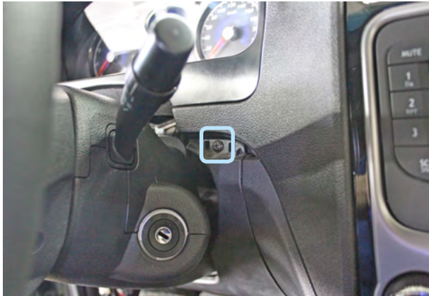
Фото 1.7. Декоративная накладка справа снята. Саморез
