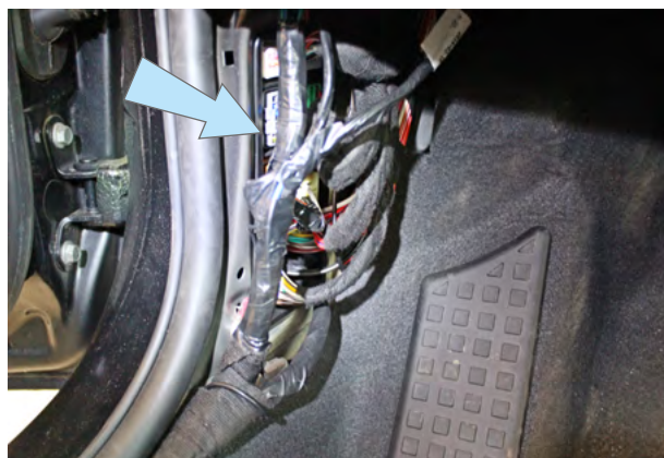
Фото 11.1. Местоположение чёрного разъёма на блоке BCM
