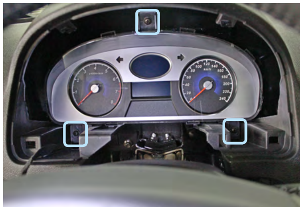
Фото 2.4. Саморезы крепления панели приборов
