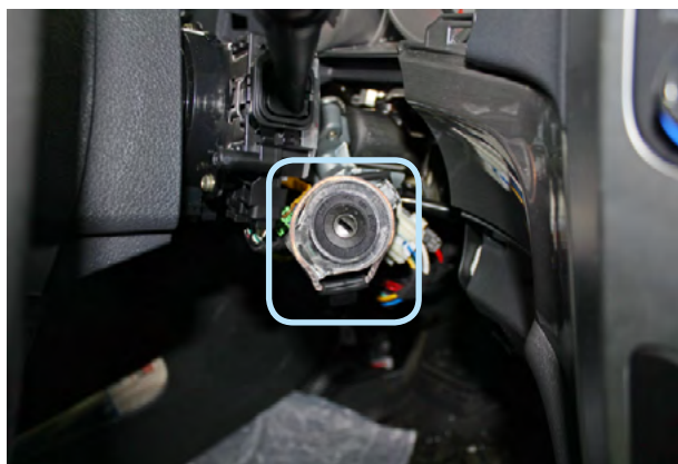
Фото 14. Антенна модуля обхода штатного иммобилайзера на замке зажигания
