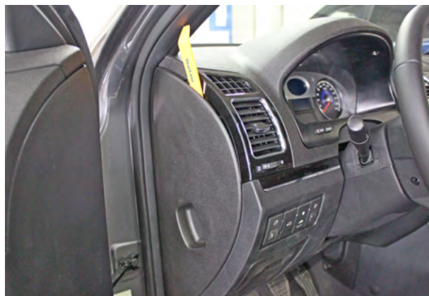
Фото 1.2. Снять левую боковую накладку передней панели
