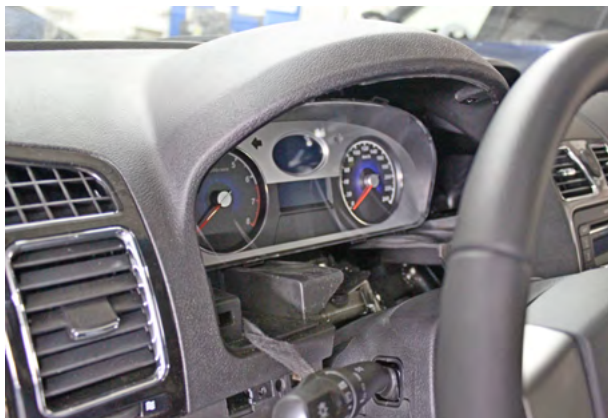
Фото 2.3. Декоративная накладка панели приборов снята
