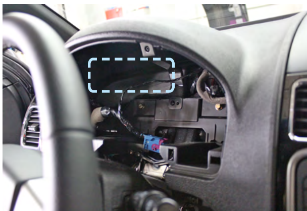
Фото 7. Пример расположения центрального блока охранно-телематического комплекса
