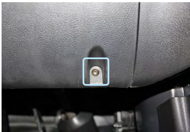
Фото 1.9. Саморез крепления пластиковой накладки под рулевой колонкой снизу
