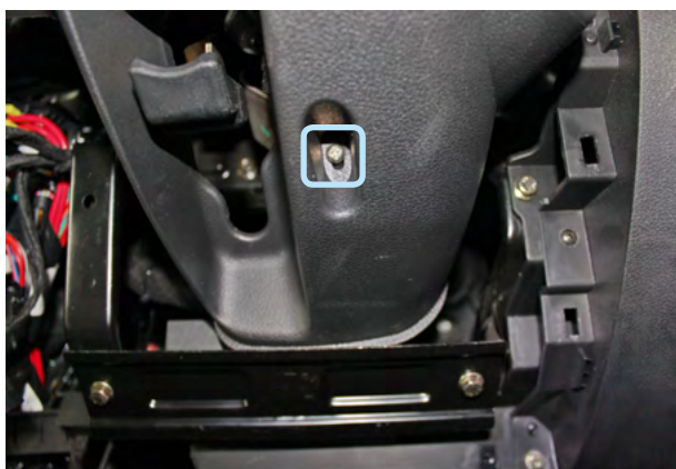
Фото 3.5. Саморез крепления нижней части кожаного рулевого вала
