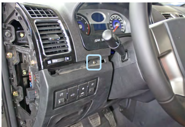
Фото 1.5. Декоративная накладка снята. Саморез
