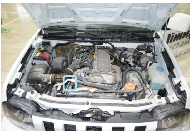
Фото 4.3. Место установки датчика температуры двигателя
