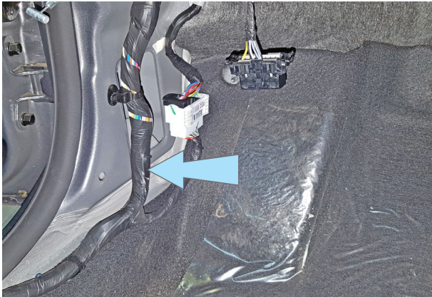
Фото 10.1. Местоположение жгута в левой кик-панели
