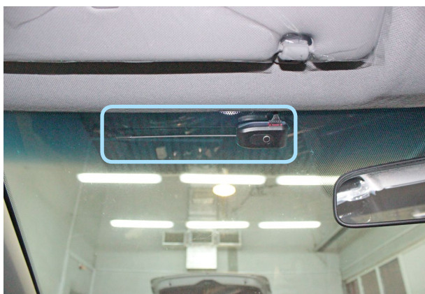
Фото 4.1. Возможное место установки антенного модуля
