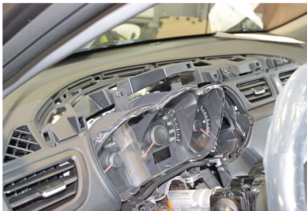
Фото 3.3. Накладка панели приборов снята
