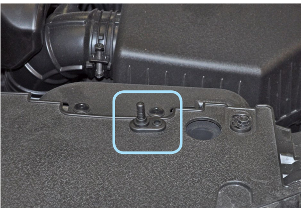
Фото 5.5. Возможное место установки концевика капота
