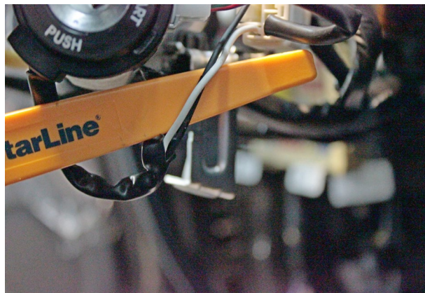
Фото 15.2. Провода антенны штатного иммобилайзера (чёрный и белый)
