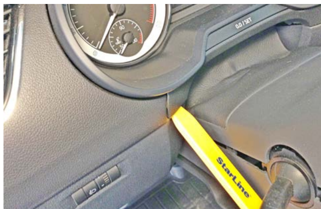
Фото 1.9. Снять накладку под панелью приборов
