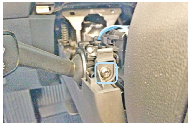
Фото 1.10. Винт крепления кожуха рулевого вала слева
