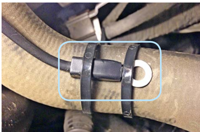
Фото 2.6. Крепление датчика температуры двигателя
