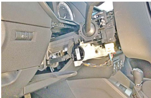
Фото 1.13. Кожух рулевого вала снят
