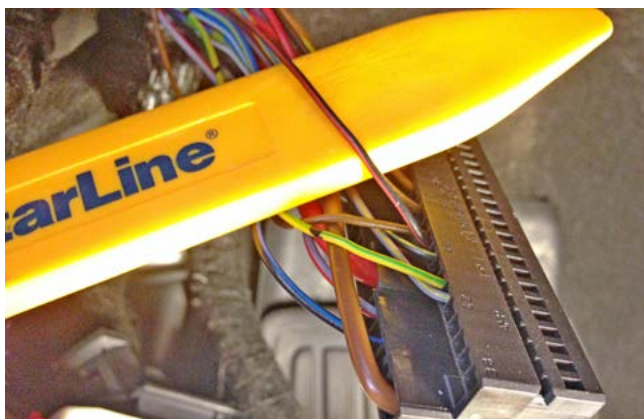
Фото 3.10. Разъём А, зажигание 2 (чёрно-красный)
