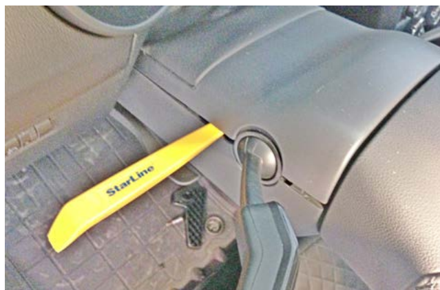
Фото 1.8. Отсоединить верхнюю часть кожуха рулевого вала
