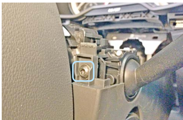
Фото 1.11. Винт крепления кожуха рулевого вала справа
