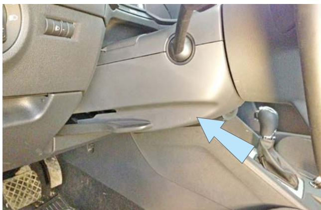
Фото 1.7. Кожух рулевого вала. Общий вид
