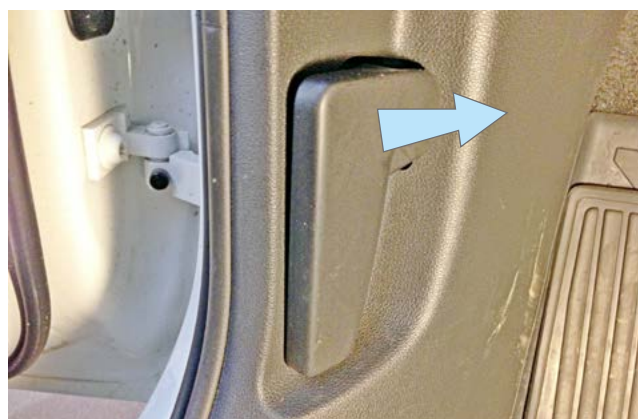
Фото 1.4. Сдвинуть фиксатор ручки отпирания капота в направлении стрелки
