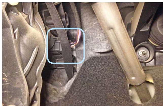
Фото 3.13. Местоположение разъёма педали сцепления
