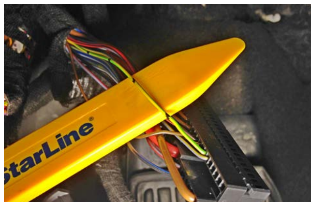
Фото 3.9. Разъём А, зажигание 1 (жёлто-зелёный)
