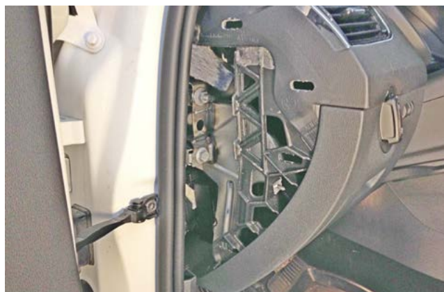
Фото 1.2. Левая боковая накладка передней панели снята
