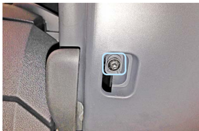
Фото 1.12. Винт крепления кожуха рулевого вала снизу
