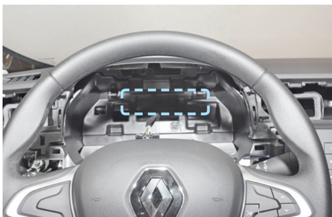
Фото 2.10. Пример расположения центрального блока охранно-телематического комплекса
