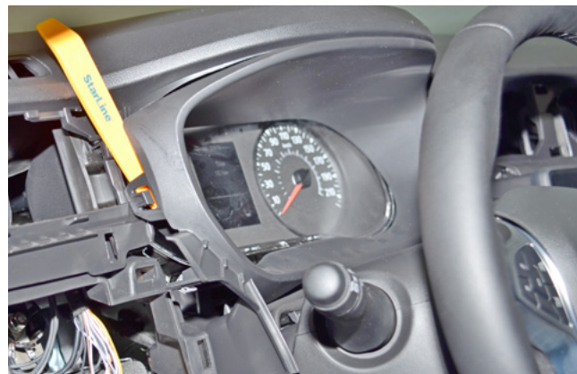
Фото 1.8. Снять накладку панели приборов
