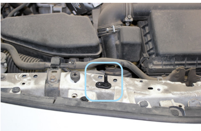
Фото 2.5. Возможное место установки концевика капота
