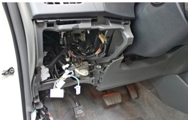
Фото 1.7. Накладка слева от рулевой колонки снята
