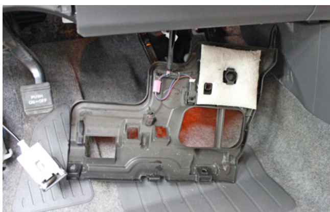
Фото 1.9. Накладка педального узла снята
