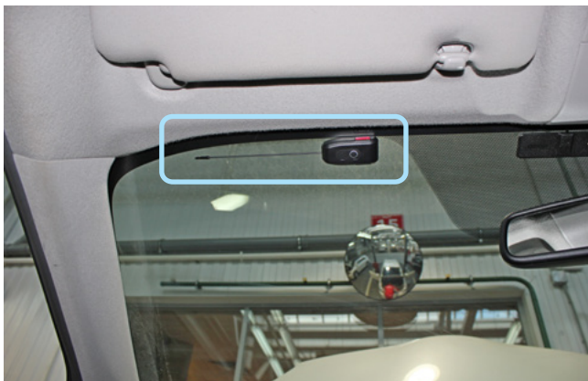
Фото 2.1. Возможное место установки антенного модуля
