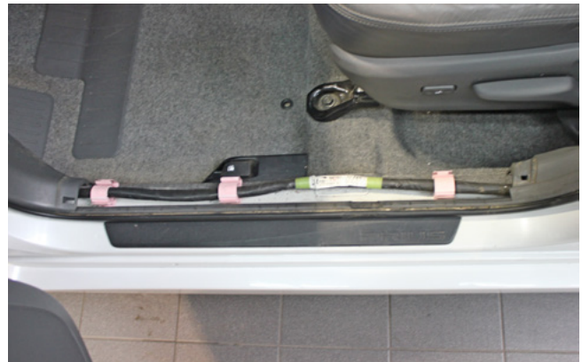
Фото 1.2. Накладка порога снята
