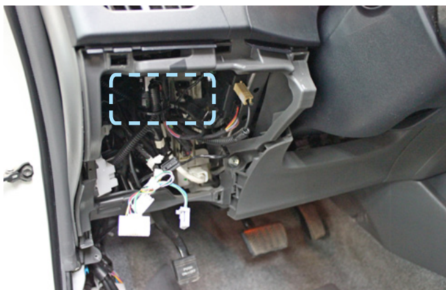
Фото 2.7. Пример расположения центрального блока охранно-телематического комплекса
