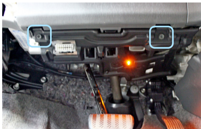
Фото 1.8. Саморезы крепления накладки педального узла
