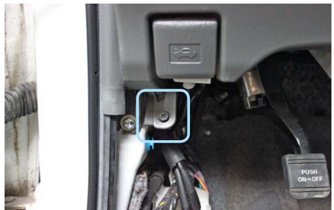
Фото 1.6. Саморез крепления накладки
