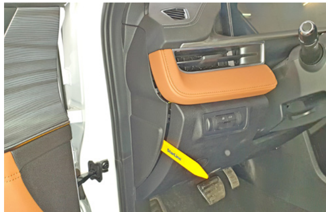
Фото 1.2. Снять боковую накладку передней панели
