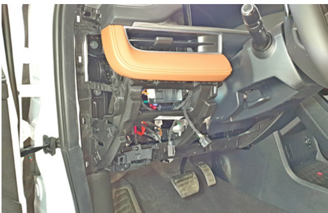
Фото 1.5. Пластиковая накладка под рулевой колонкой снята
