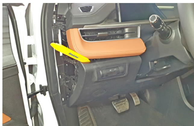
Фото 1.4. Снять пластиковую накладку под рулевой колонкой
