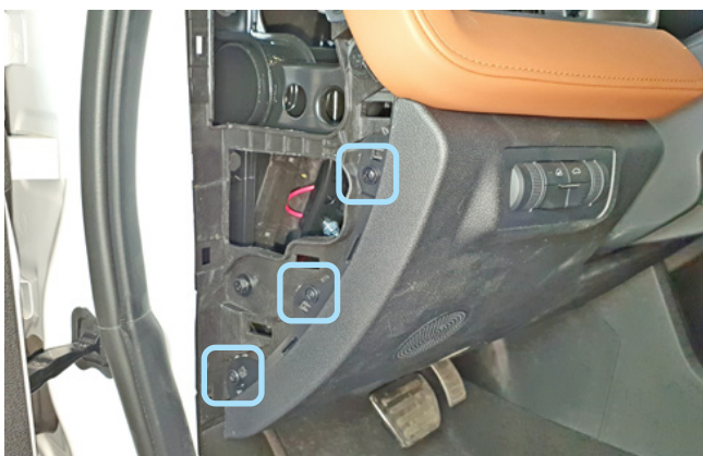
Фото 1.3. Саморезы крепления пластиковой накладки под рулевой колонкой
