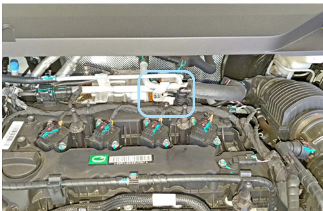
Фото 2.6. Место установки датчика температуры двигателя
