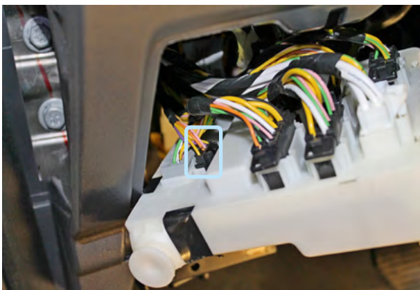
Фото 8.1. Местоположение разъёма BODY (I)
