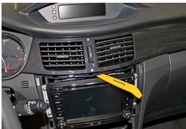
Фото 1.9. Частично снять продольную декоративную наладку передней панели
