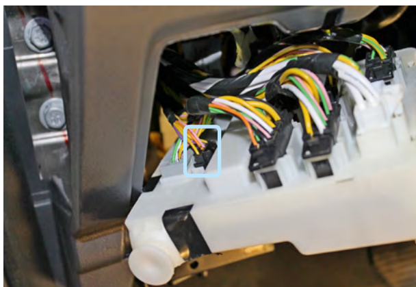
Фото 14.1. Местоположение разъёма BODY (I)
