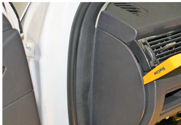
Фото 1.2. Снять боковую накладку передней панели
