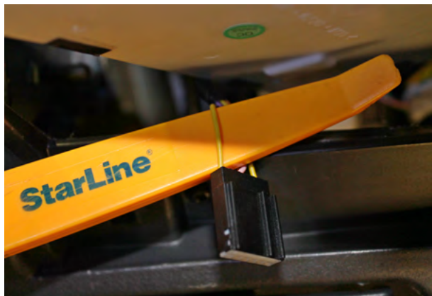
Фото 8.3. Концевик багажника (жёлтый)
