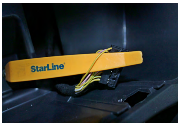
Фото 10. Стояночный тормоз (жёлтый)
