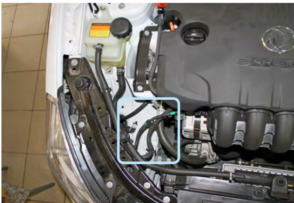
Фото 5.1. Возможное место установки сирены
