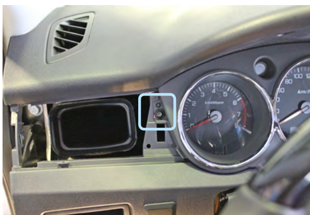
Фото 1.11. Саморез крепления накладки панели приборов слева
