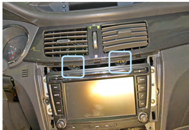
Фото 1.8. Саморезы крепления продольной декоративной накладки передней панели
