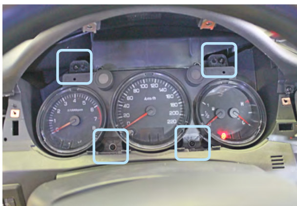
Фото 1.15. Саморезы крепления панели приборов
