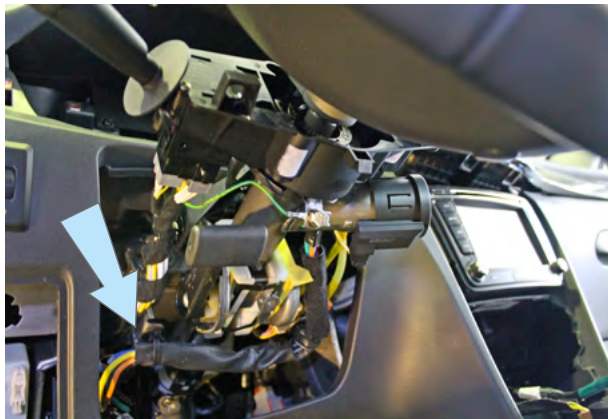
Фото 16.1. Местоположение жгута замка зажигания
