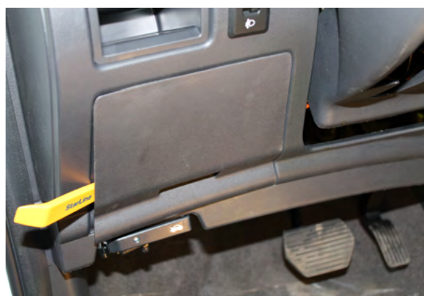
Фото 2.2. Снять пластиковую накладку
