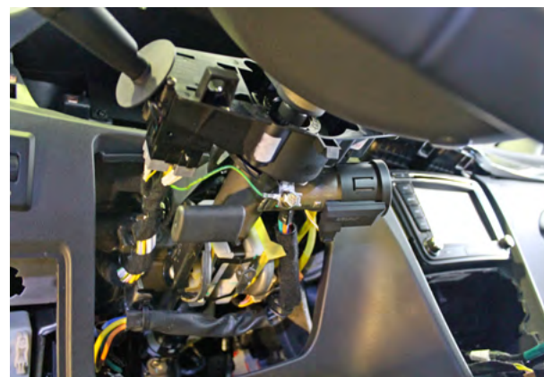
Фото 3.4. Нижняя часть кожуха рулевого вала снята
