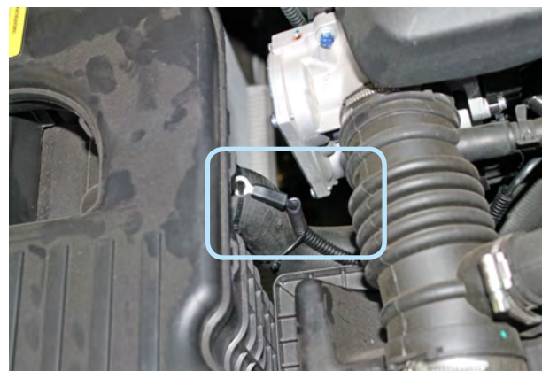
Фото 5.4. Крепление датчика температуры двигателя
