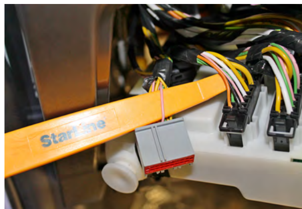
Фото 13.2. Управление световыми сигналами (розовый)
