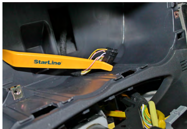
Фото 9.2. Контроль работы двигателя (розовый)
