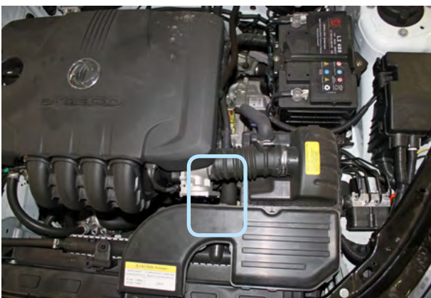
Фото 5.3. Место установки датчика температуры двигателя
