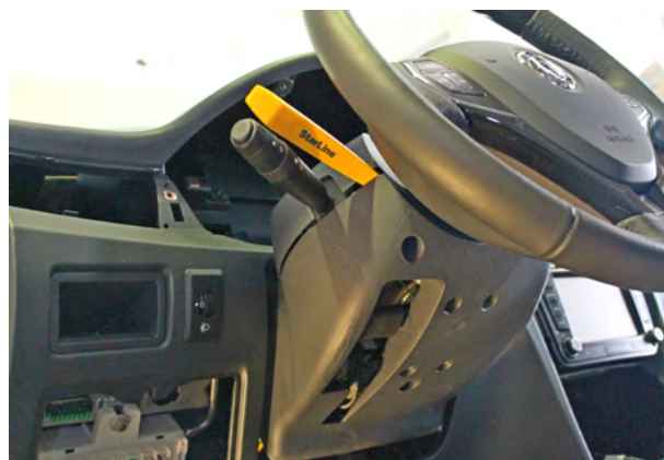
Фото 3.2. Снять верхнюю часть кожуха рулевого вала
