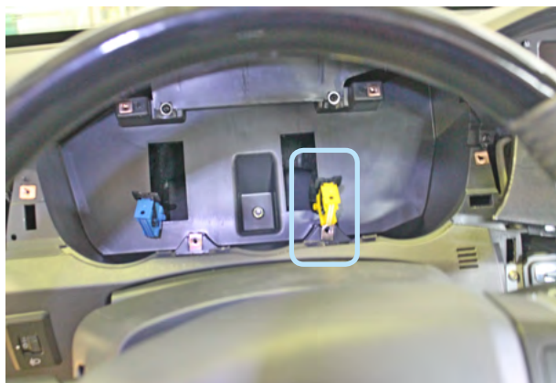
Фото 9.1. Местоположение разъёма панели приборов
