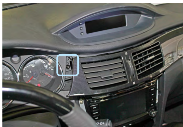
Фото 1.10. Саморез крепления накладки панели приборов справа
