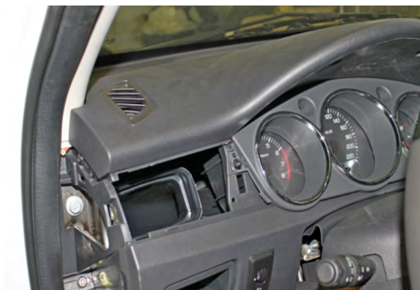
Фото 1.5. Левый воздуховод снят
