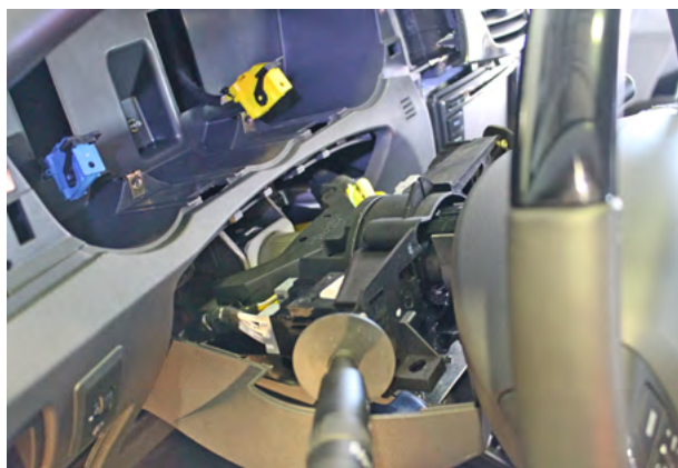
Фото 3.3. Верхняя часть кожуха рулевого вала снята
