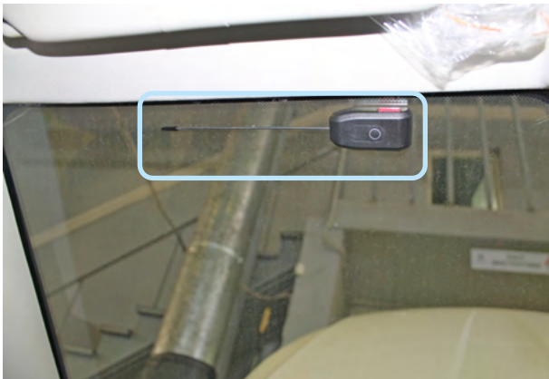
Фото 4.1. Возможное место установки антенного модуля
