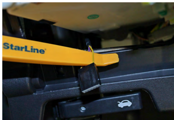
Фото 14.2. Управление центральным замком (жёлтый)
