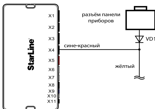
Схема 1. Подключение стояночного тормоза
