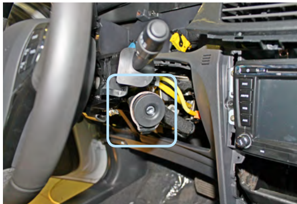
Фото 15. Антенна модуля обхода штатного иммобилайзера на замке зажигания
