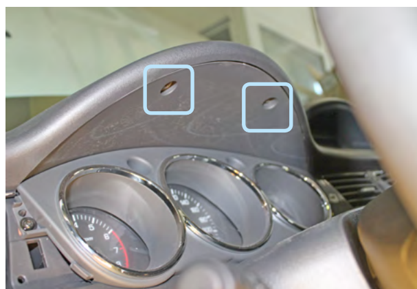
Фото 1.12. Саморезы крепления накладки панели приборов сверху
