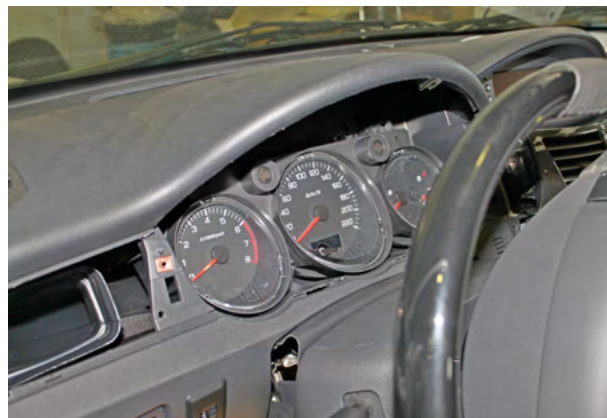
Фото 1.14. Накладка панели приборов снята
