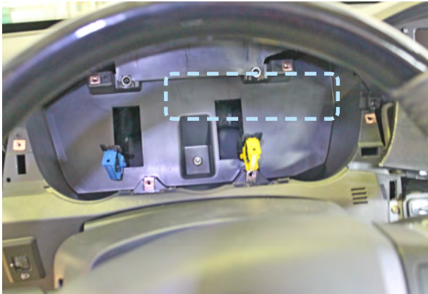
Фото 6. Пример расположения центрального блока охранно-телематического комплекса
