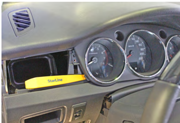
Фото 1.13. Снять декоративную накладку панели приборов
