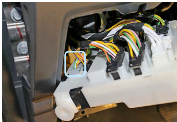
Фото 13.1. Местоположение разъёма IP(H)
