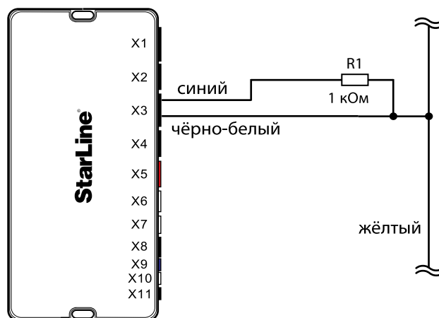
Схема 2. Подключение управления центральным замком
