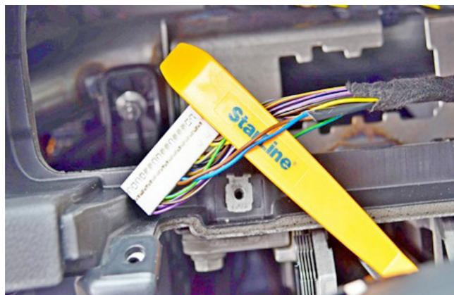
Фото 3.13. Провода антенны штатного иммобилайзера (синий и коричневый)
