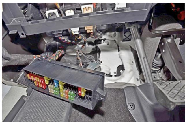
Фото 1.22. Монтажный блок предохранителей снят
