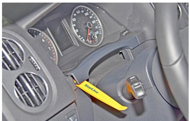
Фото 1.11. Снять накладку под панелью приборов
