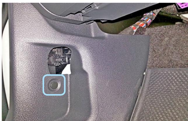
Фото 1.4. Ручка снята. Клипса крепления накладки порога двери водителя
