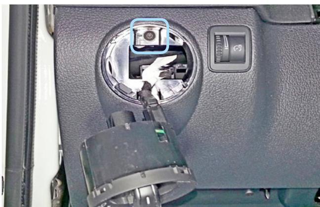
Фото 1.10. Переключатель света снят. Саморез
