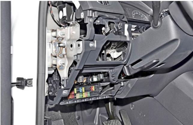
Фото 1.14. Накладка слева от рулевой колонки снята
