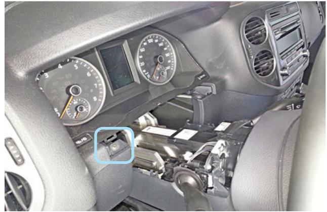
Фото 1.13. Саморез крепления накладки
