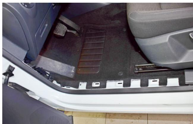
Фото 1.5. Накладка порога двери водителя снята
