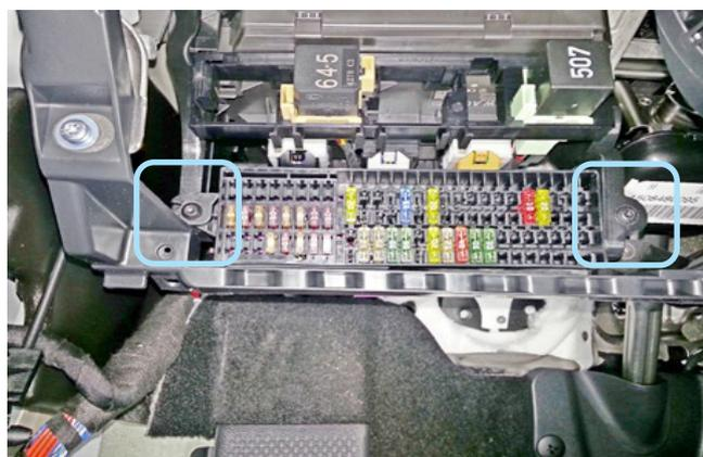
Фото 1.21. Винты крепления монтажного блока предохранителей
