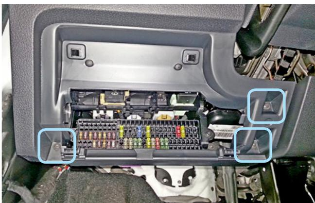
Фото 1.8. Саморезы крепления накладки слева от рулевой колонки
