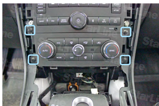
Фото 2.4. Саморезы крепления блока управления климат-контролем
