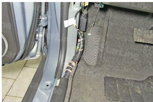
Фото 1.4. Накладка левой кик-панели снята
