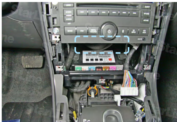
Фото 6. Пример расположения центрального блока охранно-телематического комплекса
