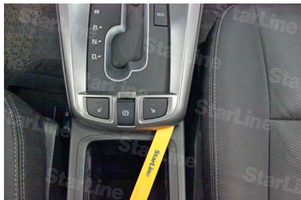
Фото 2.2. Снять декоративную накладку центральной консоли
