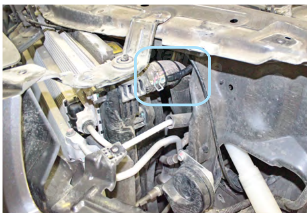
Фото 5.5. Место установки датчика температуры двигателя
