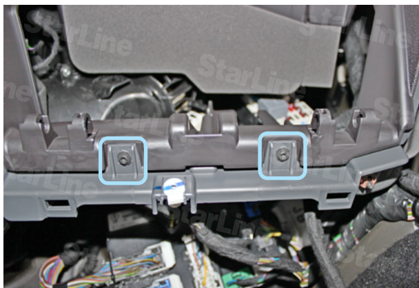
Фото 1.7. Саморезы крепления бардачка снизу
