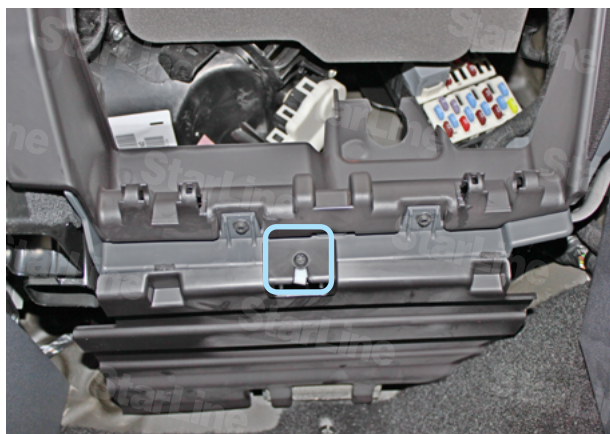
Фото 1.3. Крышка бардачка снята. Саморез крепления нижней накладки
