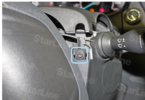
Фото 2.4. Крепление нижней части кожуха справа
