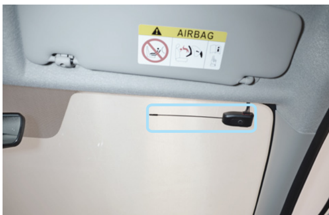
Фото 2.1. Возможное место установки антенного модуля
