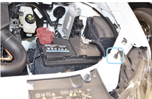
Фото 2.7. Возможное место установки концевика капота
