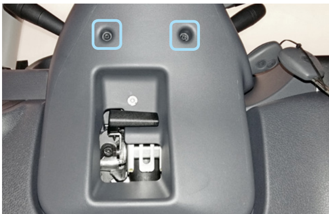
Фото 1.1. Саморезы крепления нижней части кожуха
