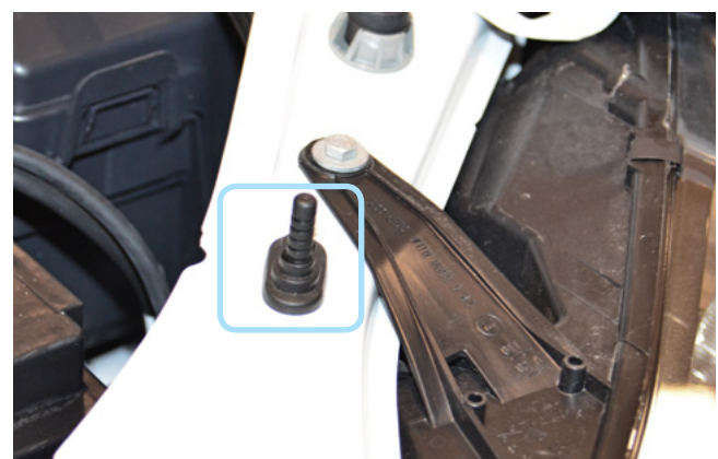
Фото 2.8. Крепление концевика капота
