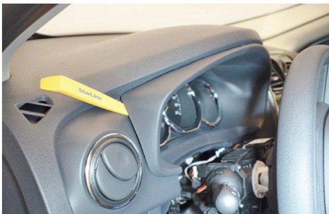
Фото 1.4. Снять накладку панели приборов
