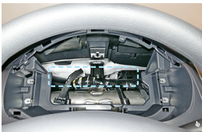
Фото 2.10. Пример расположения центрального блока охранно-телематического комплекса
