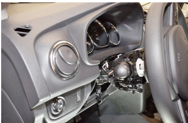
Фото 1.3. Кожух рулевого вала снят
