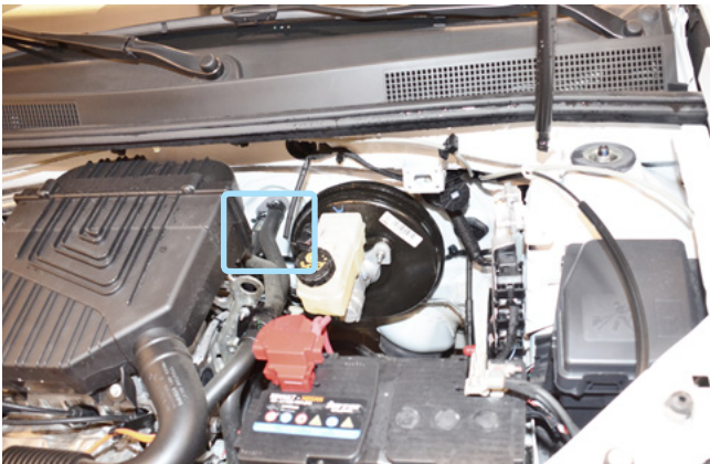
Фото 2.5. Место установки датчика температуры двигателя
