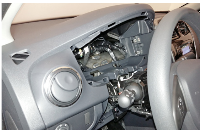
Фото 1.6. Панель приборов снята
