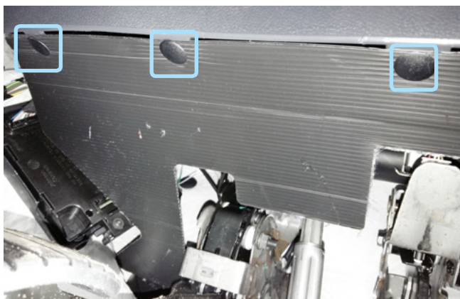
Фото 1.7 Клипсы крепления декоративной накладки педального узла
