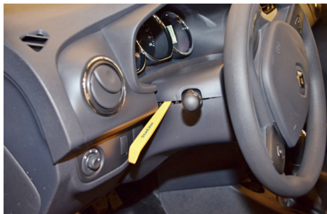
Фото 1.2. Снять верхнюю часть кожуха рулевого вала
