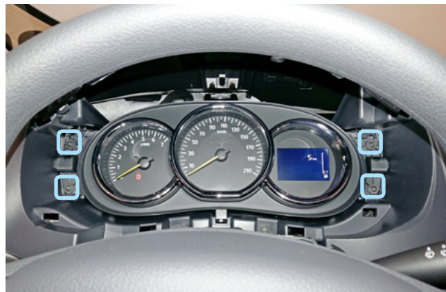
Фото 1.5. Саморезы крепления панели приборов
