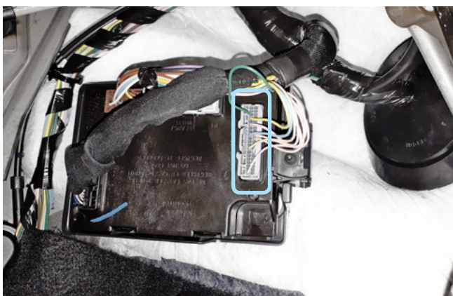
Фото 3.4. Местоположение серого разъёма S2
