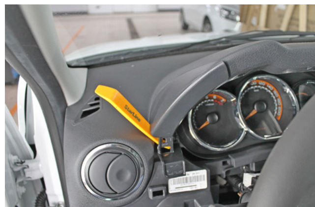
Фото 1.18. Снять накладку слева от панели приборов
