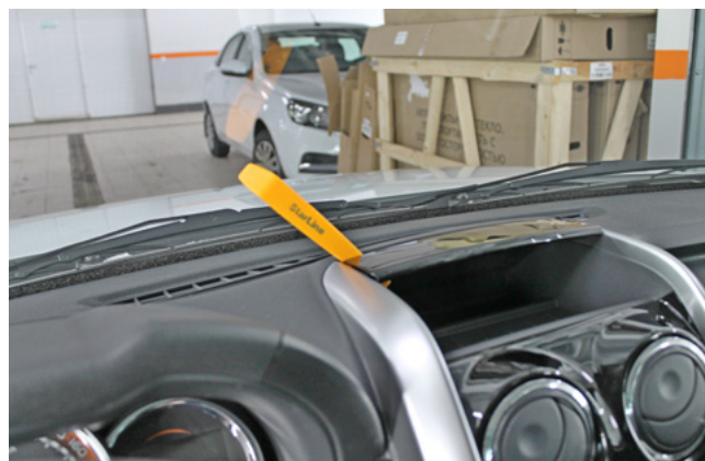
Фото 1.10. Снять пластиковую накладку в верхней части центральной консоли
