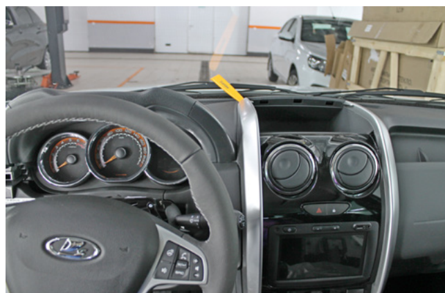
Фото 1.12. Снять левую декоративную накладку центральной консоли
