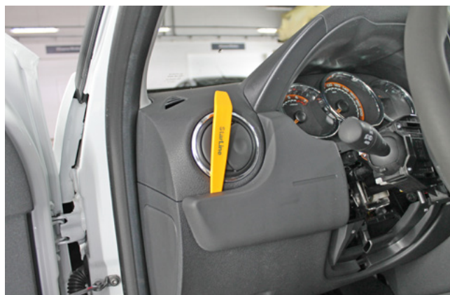
Фото 1.8. Снять пластиковую накладку слева от рулевой колонки
