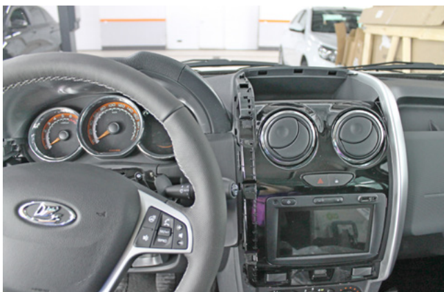
Фото 1.13. Декоративная накладка центральной консоли снята
