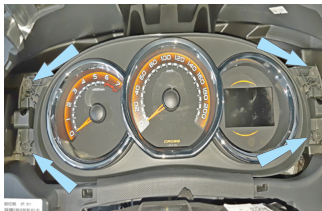
Фото 1.22. Саморезы крепления панели приборов
