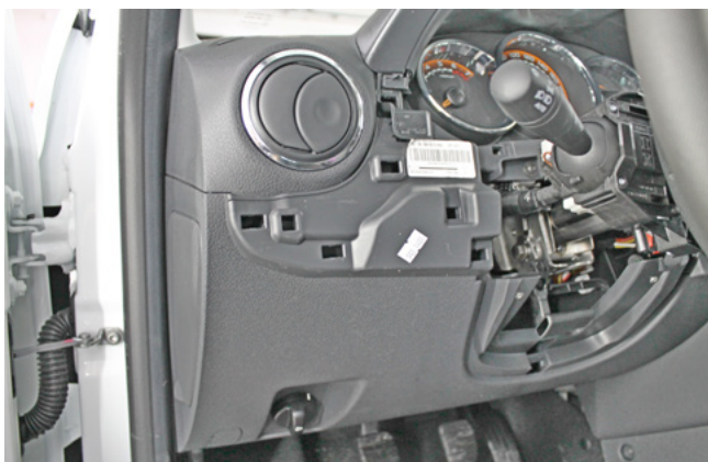
Фото 1.9. Пластиковая накладка снята
