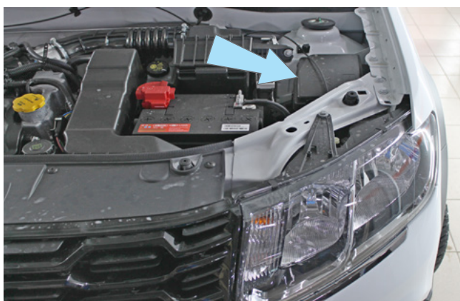
Фото 2.8. Возможное место установки подкапотного блока R6
