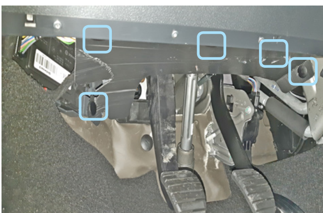
Фото 1.5. Клипсы крепления декоративной накладки педального узла
