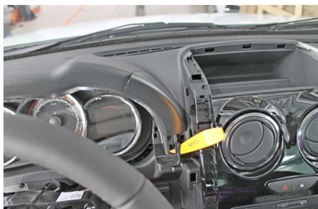
Фото 1.20. Снять накладку справа от панели приборов
