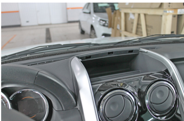
Фото 1.11. Пластиковая накладка снята
