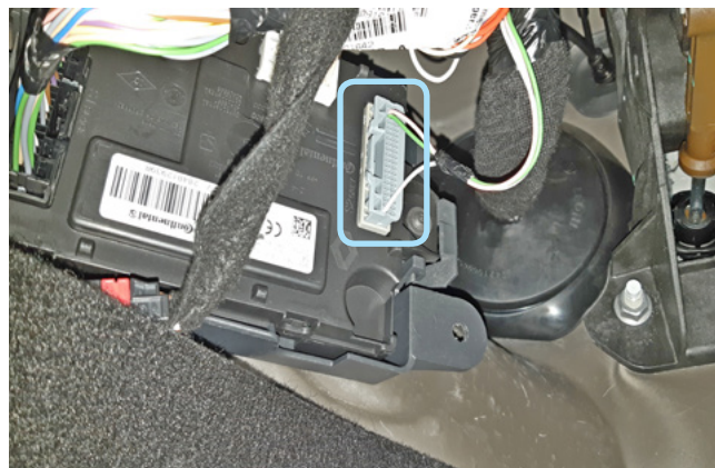
Фото 3.9. Местоположение серого разъёма на блоке BCM
