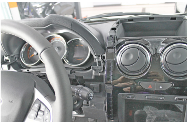
Фото 1.15. Пластиковая накладка снята
