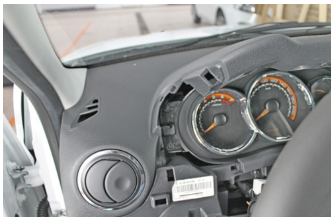
Фото 1.19. Накладка слева от панели приборов снята
