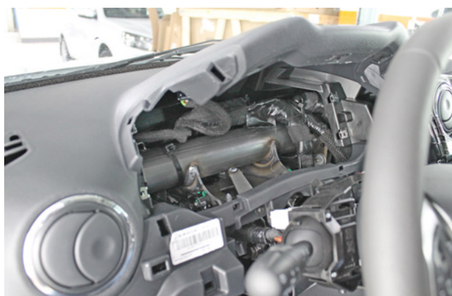
Фото 1.23. Панель приборов снята
