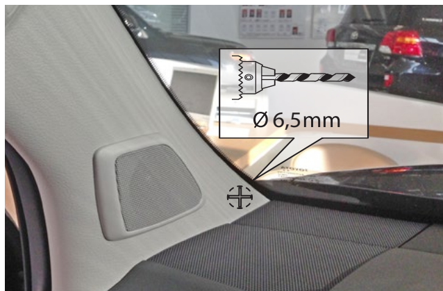
Фото 2.2. Место установки светодиода
