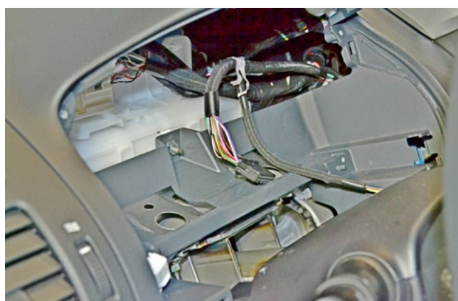
Фото 1.20. Панель приборов снята
