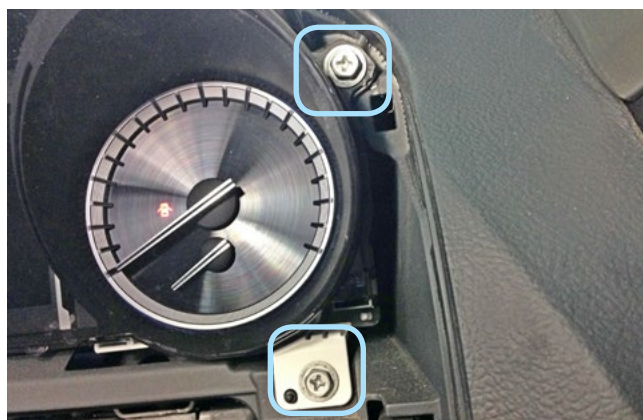
Фото 1.19. Саморезы крепления панели приборов справа
