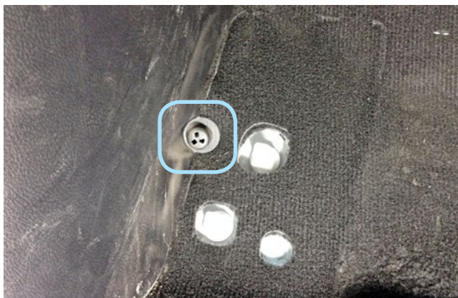
Фото 1.3. Площадка для ноги водителя снята. Клипса крепления накладки левой кик-панели
