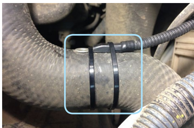
Фото 2.6. Крепление датчика температуры двигателя
