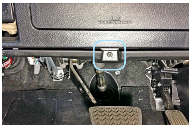
Фото 1.8. Саморез крепления накладки педального узла
