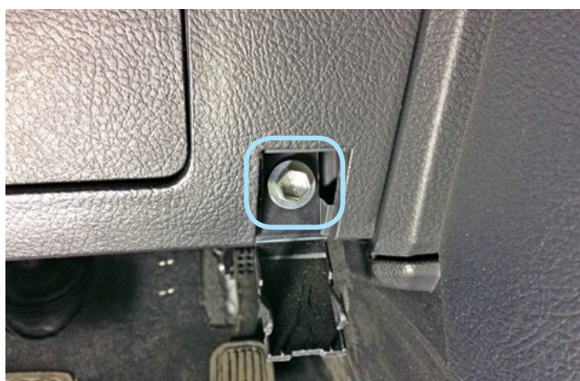
Фото 1.10. Болт крепления накладки под рулевой колонкой справа
