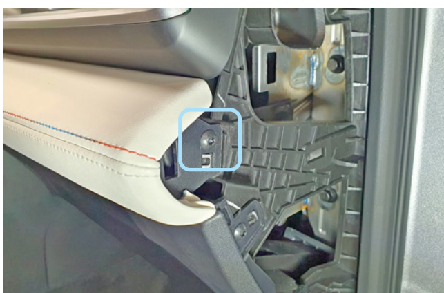
Фото 1.20. Накладка снята. Саморез крепления продольной накладки передней панели
