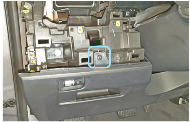
Фото 1.8. Саморез крепления пластиковой накладки под рулевой колонкой
