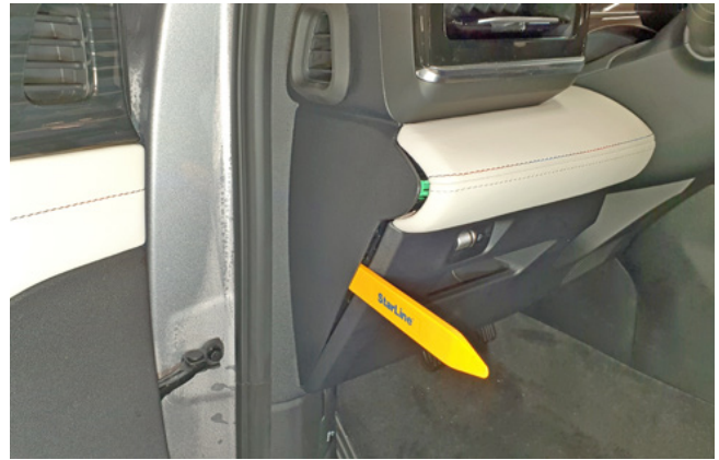
Фото 1.2. Снять левую боковую накладку передней панели
