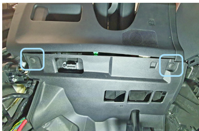
Фото 1.14. Клипсы крепления накладки педального узла
