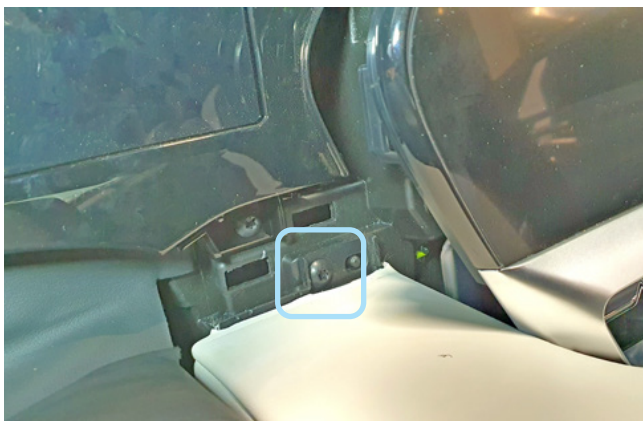
Фото 1.18. Саморез крепления продольной накладки передней панели
