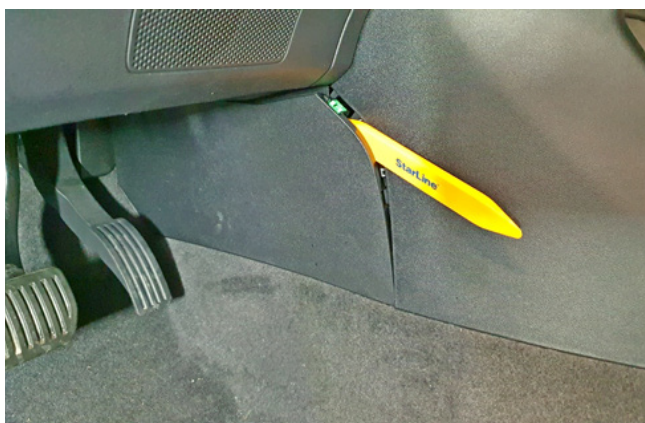
Фото 1.13. Снять боковую накладку центрального тоннеля
