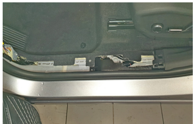
Фото 1.12. Накладка порога двери водителя снята
