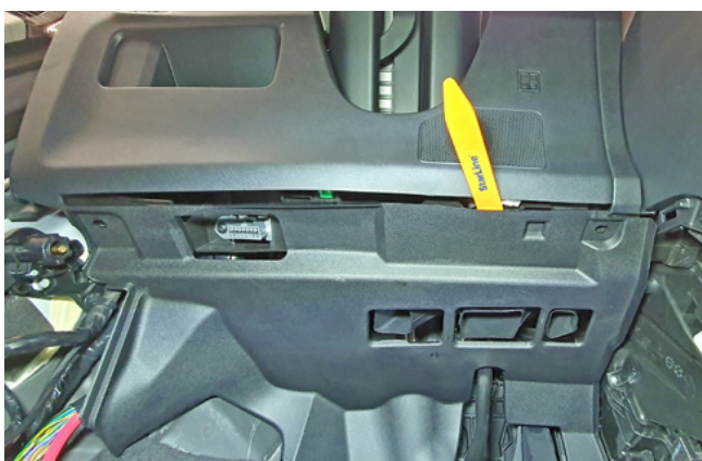
Фото 1.15. Снять накладку педального узла
