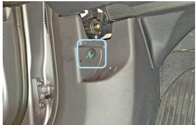
Фото 1.10. Ручка отпирания капота снята. Клипса крепления накладки порога двери водителя
