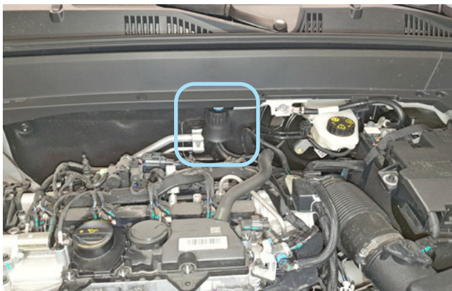
Фото 2.2. Возможное место установки сирены
