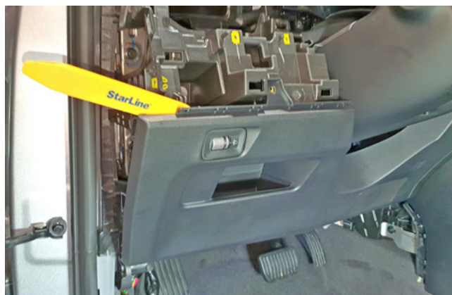
Фото 1.24. Снять пластиковую накладку под рулевой колонкой
