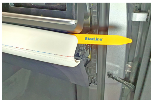
Фото 1.21. Снять продольную накладку передней панели
