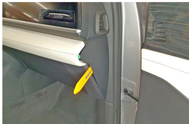
Фото 1.19. Снять правую боковую накладку передней панели
