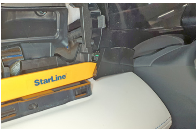
Фото 1.5. Снять декоративную накладку под панелью приборов
