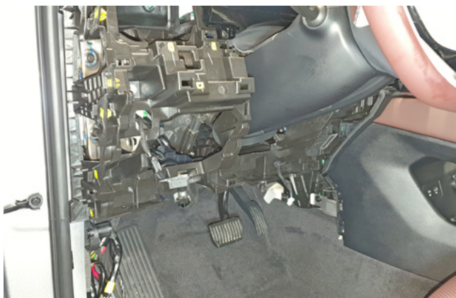
Фото 1.25. Пластиковая накладку под рулевой колонкой снята
