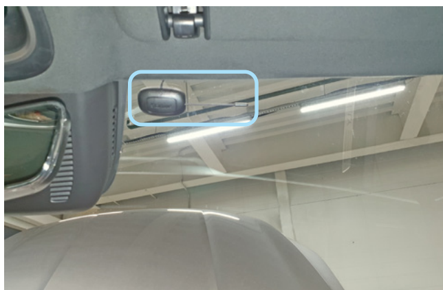
Фото 2.1. Возможное место установки антенного модуля
