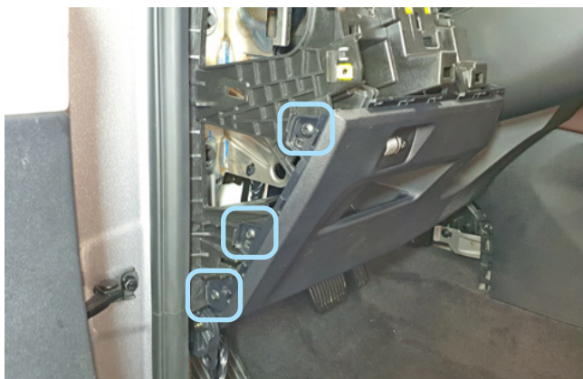
Фото 1.23. Саморезы крепления пластиковой накладке под рулевой колонкой
