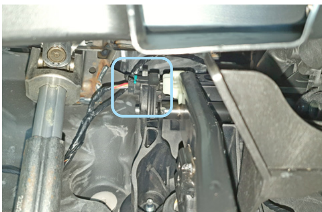
Фото 3.12. Местоположение разъёма концевика педали тормоза
