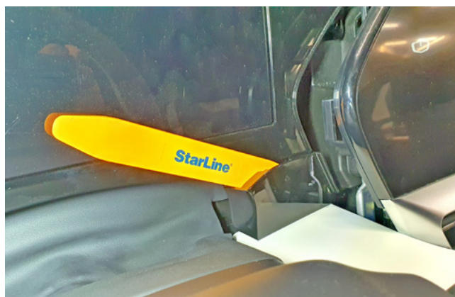
Фото 1.17. Снять декоративную накладку под панелью приборов
