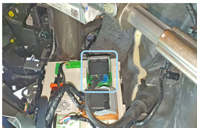
Фото 3.7. Местоположение разъёма на блоке BCM
