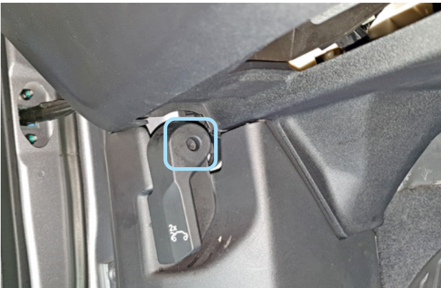
Фото 1.9. Винт крепления ручки отпирания капота
