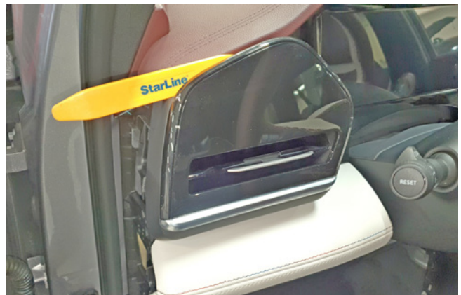
Фото 1.4. Снять левый воздуховод
