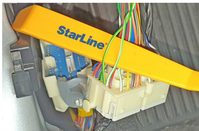
Фото 3.5. Шина CAN-B (бело-зелёный и зелёно-жёлтый)
