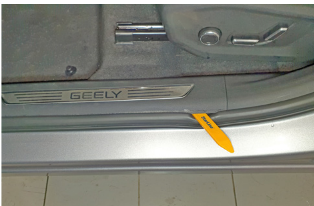
Фото 1.11. Снять накладку порога двери водителя
