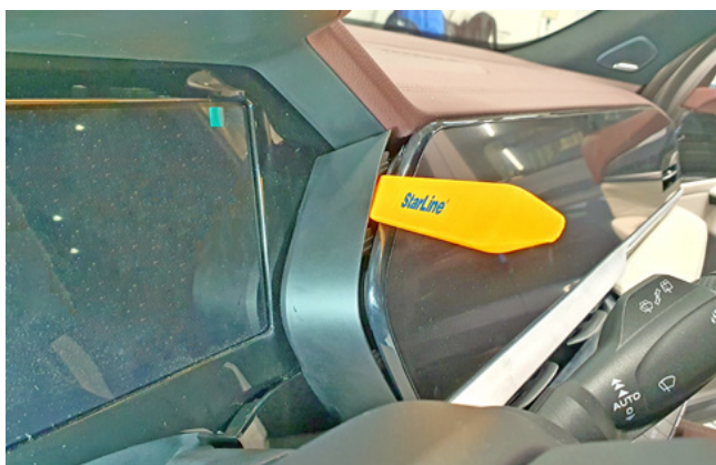
Фото 1.16. Снять накладку центрального дисплея
