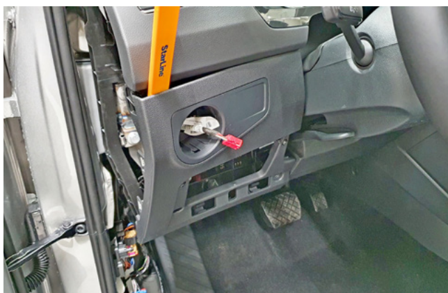
Фото 1.13. Снять накладку слева от рулевой колонки
