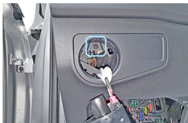
Фото 1.12. Переключатель света снят. Саморез
