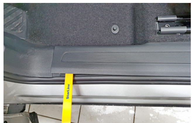
Фото 1.6. Частично снять пластиковую накладку порога двери водителя
