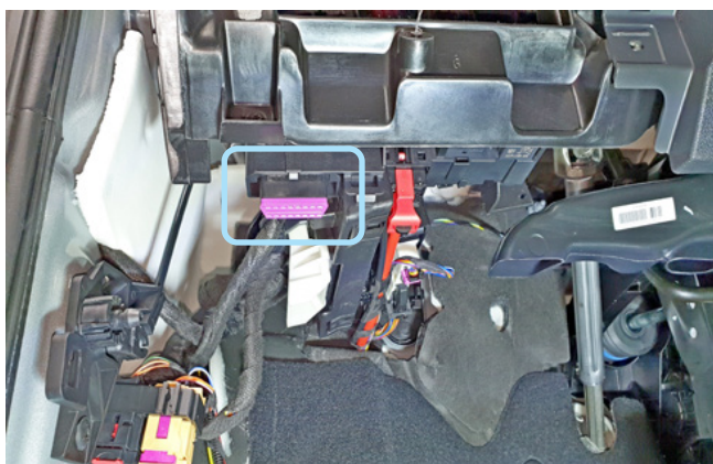
Фото 3.4. Местоположение диагностического разъёма
