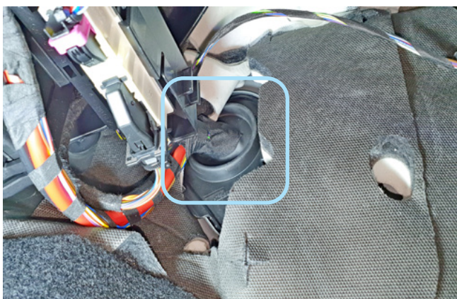
Фото 2.6. Штатный уплотнитель. Вид со стороны салона
