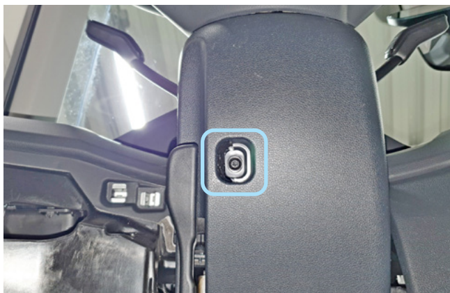
Фото 1.19. Винт крепления нижней части кожуха рулевого вала снизу
