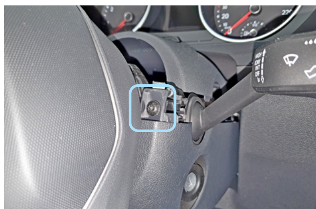
Фото 1.18. Винт крепления нижней части кожуха рулевого вала справа
