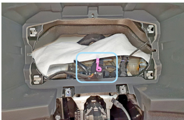
Фото 3.2. Местоположение разъёма панели приборов
