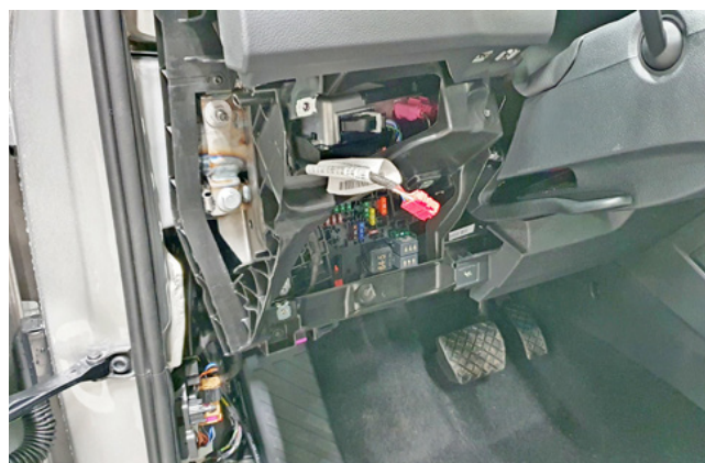
Фото 1.14. Накладка слева от рулевой колонки снята
