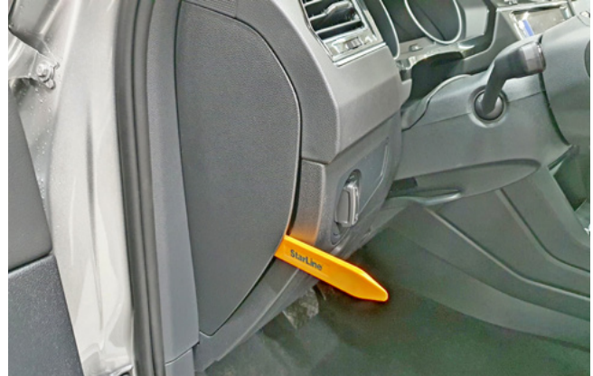
Фото 1.2. Снять боковую накладку передней панели
