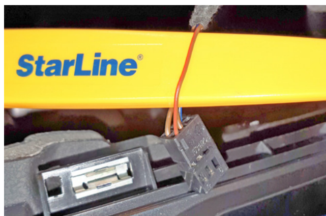
Фото 3.7. Альтернативное управление световыми сигналами (коричнево-красный)
