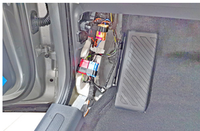
Фото 1.8. Пластиковая накладка левой кик-панели снята
