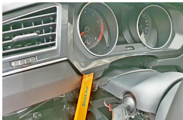
Фото 1.22. Снять декоративную накладку панели приборов
