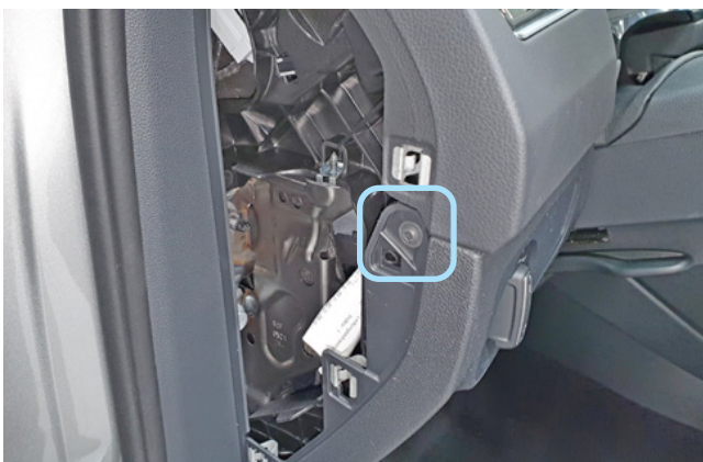
Фото 1.3. Левая боковая накладка передней панели снята. Саморез
