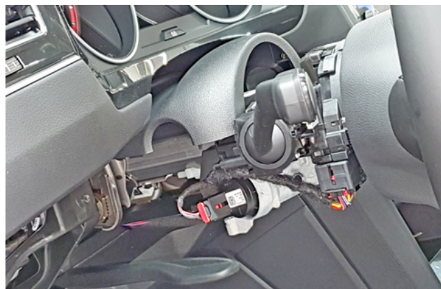
Фото 1.20. Кожух рулевого вала снят
