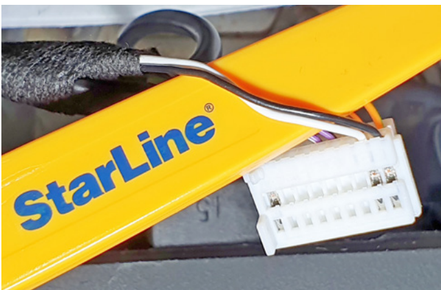
Фото 3.15. Провода антенны штатного иммобилайзера (чёрный и белый)
