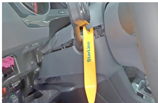
Фото 1.16. Снять верхнюю часть кожуха рулевого вала
