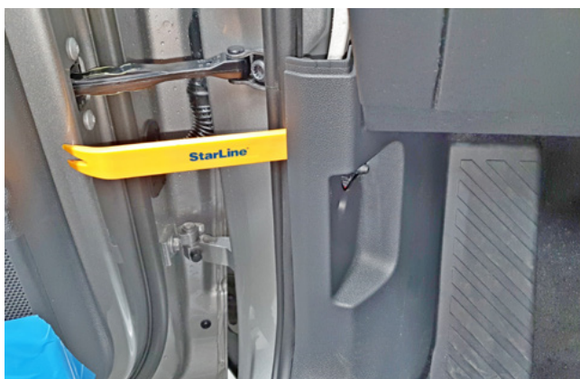
Фото 1.7. Снять пластиковую накладку левой кик-панели
