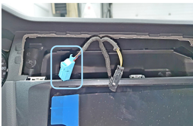
Фото 3.6. Местоположение разъёма кнопки аварийной сигнализации
