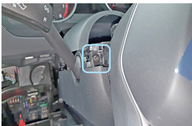
Фото 1.17. Винт крепления нижней части кожуха рулевого вала слева
