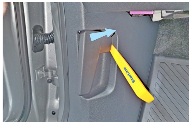
Фото 1.4. Сдвинуть фиксатор ручки отпирания капота в направлении стрелки
