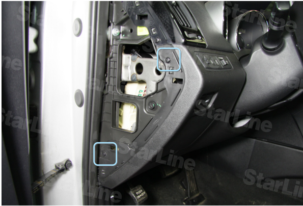
Фото 1.1. Левая накладка торпеды снята, саморезы
