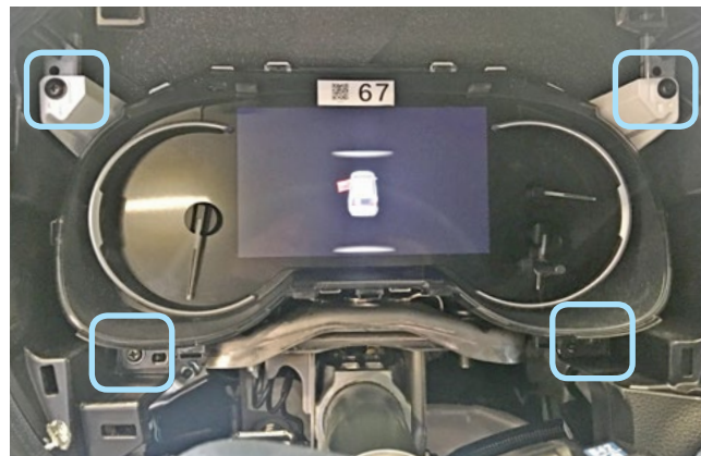
Фото 1.15. Накладка панели приборов снята. Саморезы крепления панели приборов
