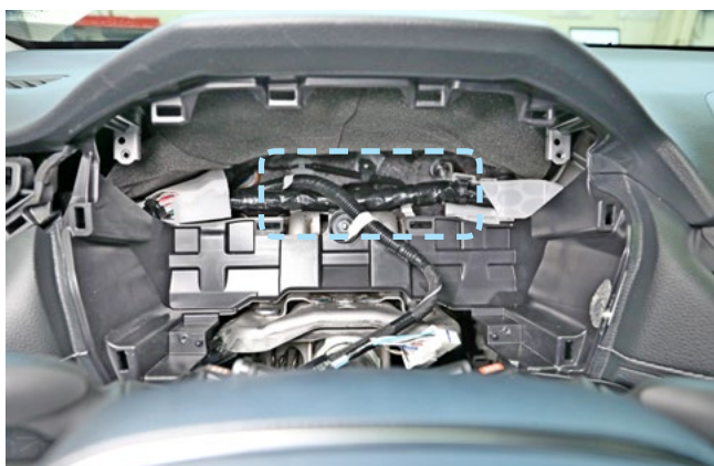
Фото 2.7. Пример расположения центрального блока охранно-телематического комплекса
