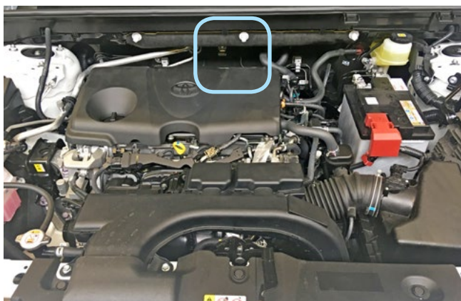
Фото 2.1. Возможное место установки сирены
