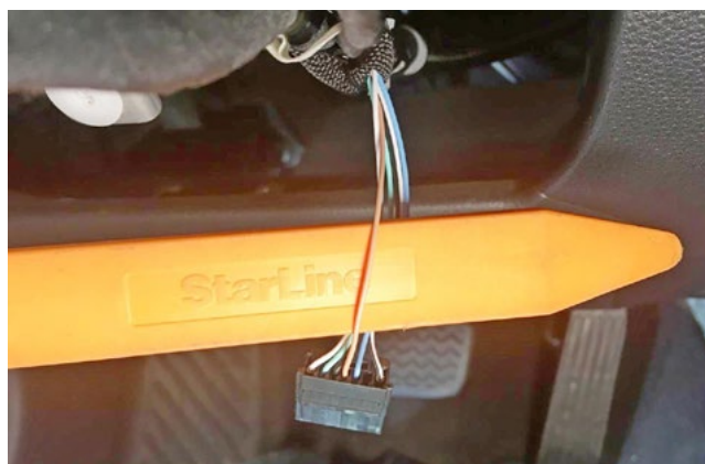
Фото 3.5. Разблокировка рулевого вала (бежевый)
