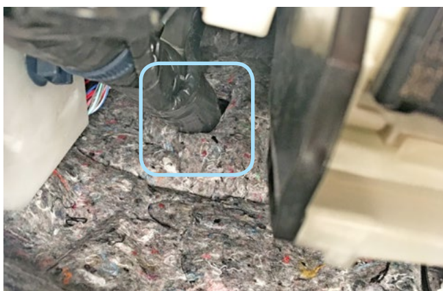
Фото 2.5. Штатный уплотнитель. Вид со стороны салона
