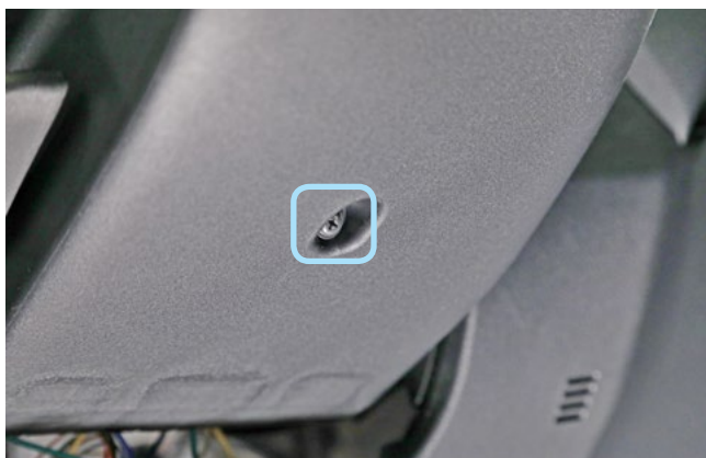
Фото 1.19. Саморез крепления кожуха рулевого вала снизу
