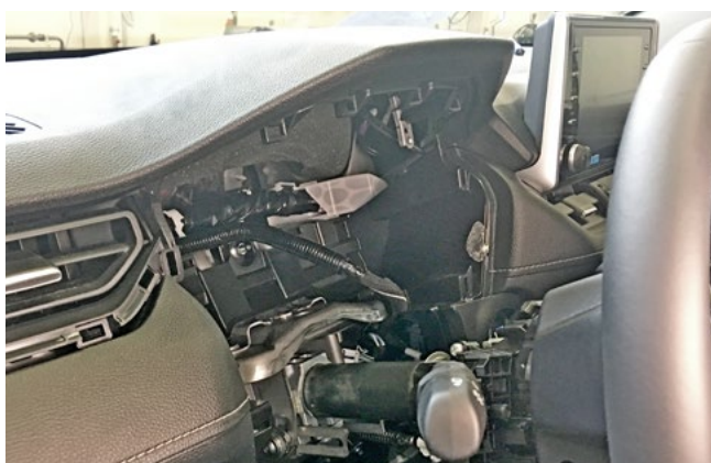
Фото 1.16. Панель приборов снята
