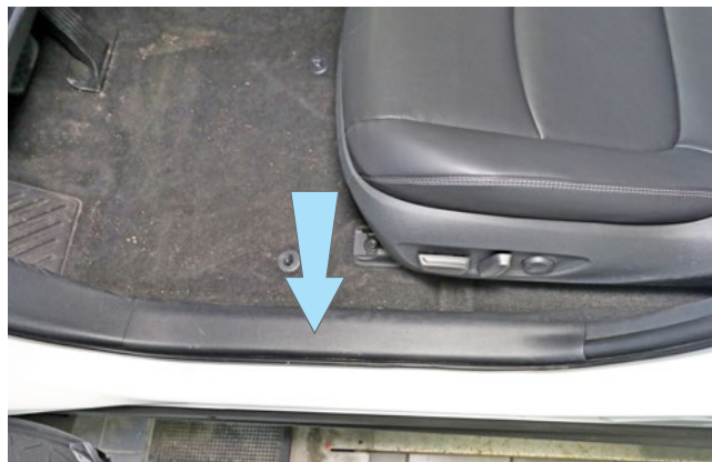
Фото 1.2. Накладка порога двери водителя
