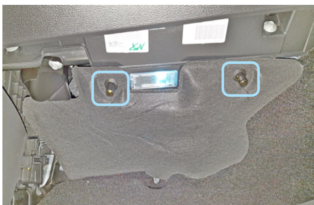
Фото 1.5. Клипсы крепления декоративной накладки под блоком ВСУ
