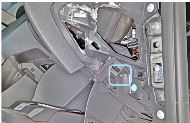
Фото 1.3. Боковая накладка снята. Саморез
