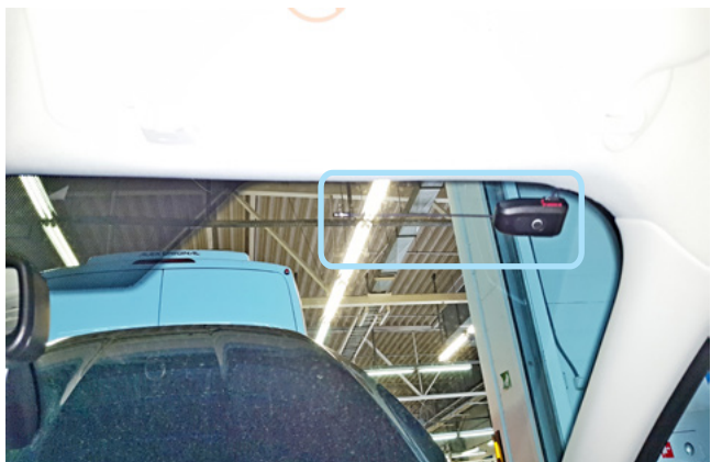
Фото 2.1. Возможное место установки антенного модуля
