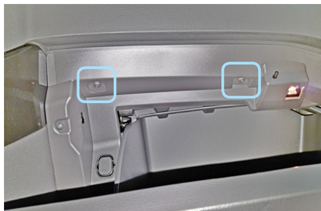
Фото 1.4. Саморезы крепления перчаточного ящика
