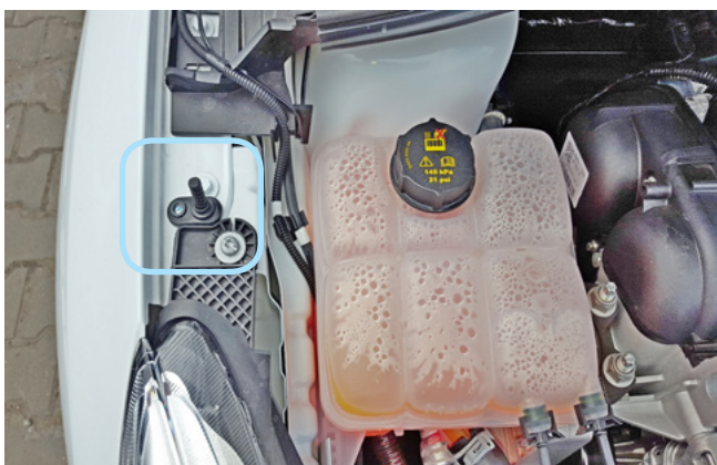
Фото 2.7. Возможное место установки концевика капота
