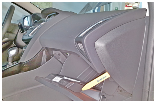
Фото 1.2. Снять боковую накладку передней панели
