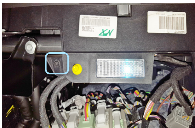
Фото 1.6. Саморез крепления перчаточного ящика слева
