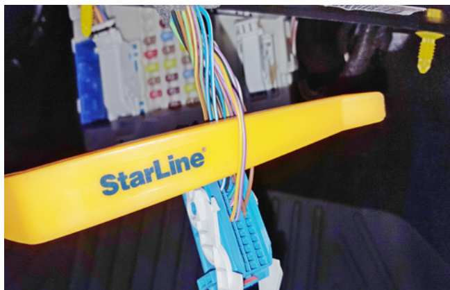
Фото 3.6. Шина данных штатного иммобилайзера (фиолетово-серый и жёлто-оранжевый)
