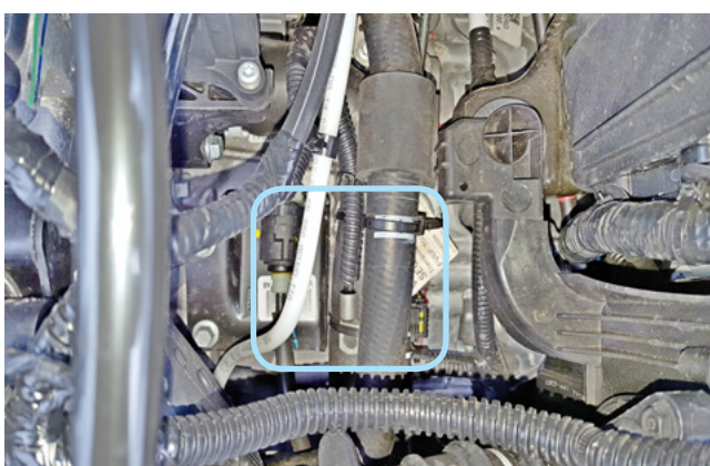
Фото 2.6. Крепление датчика температуры двигателя
