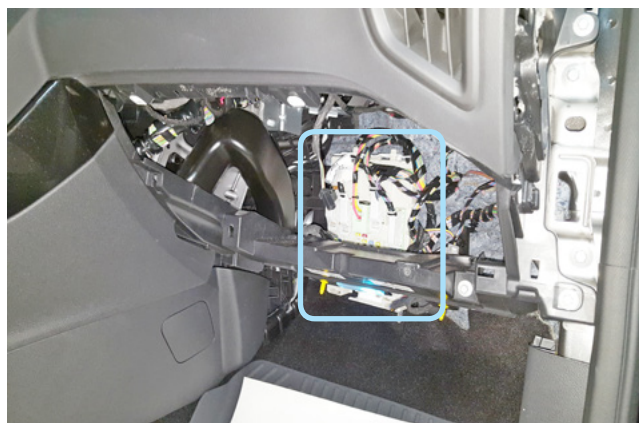
Фото 1.8. Перчаточный ящик снят. Блок ВСМ
