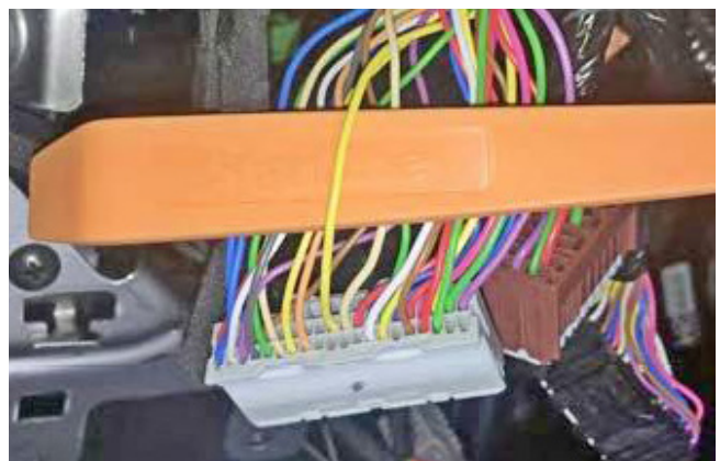
Фото 3.5. Управление световыми сигналами (жёлтый)
