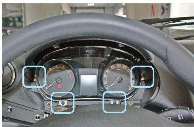
Фото 1.10. Декоративная накладка снята. Саморезы
