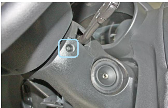
Фото 1.5. Саморез крепления нижней части кожуха рулевого вала справа
