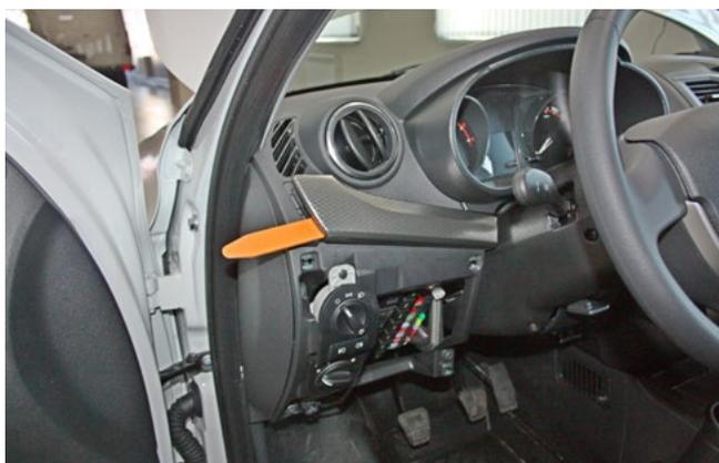
Фото 1.3. Пластиковая накладка снята. Снять декоративную накладку
