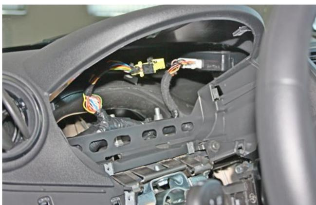
Фото 1.11. Панель приборов снята
