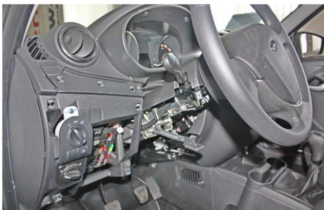
Фото 1.7. Кожух рулевого вала снят
