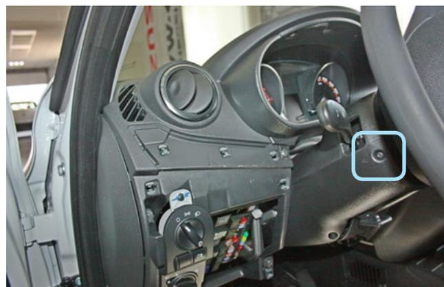
Фото 1.4. Декоративная накладка снята. Саморез крепления нижней части кожуха рулевого вала слева
