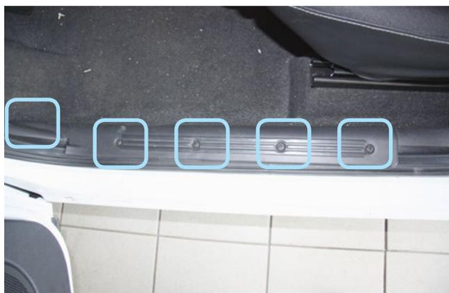
Фото 1.8. Саморезы крепления порога двери водителя
