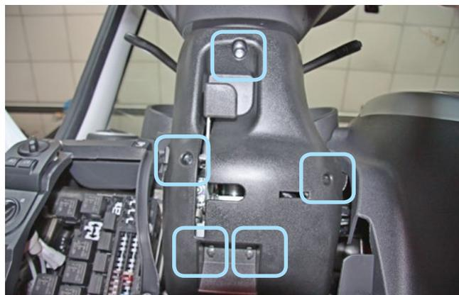
Фото 1.6. Саморезы и болты крепления кожуха рулевого вала снизу
