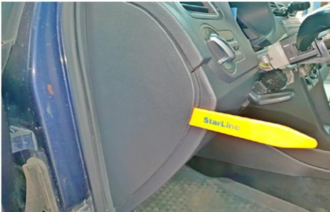
Фото 1.12. Снять боковую накладку передней панели
