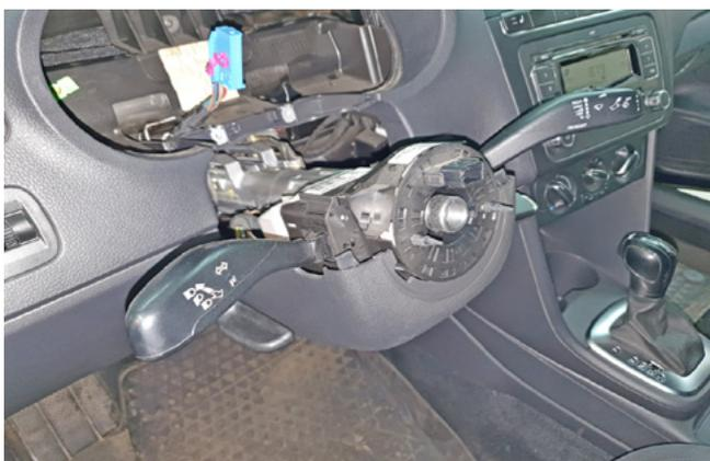
Фото 1.8. Рулевое колесо снято
