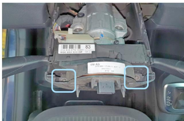
Фото 1.9. Винты крепления нижней части кожуха
