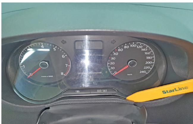
Фото 1.3. Снять накладку панели приборов
