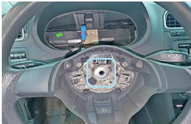
Фото 1.7. Подушка безопасности снята. Винт крепления рулевого колеса
