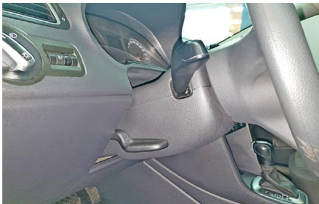
Фото 1.1. Кожух рулевого вала. Общий вид
