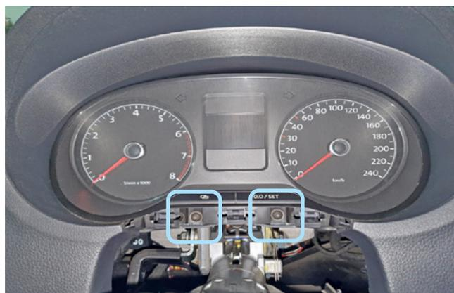
Фото 1.4. Саморезы крепления панели приборов
