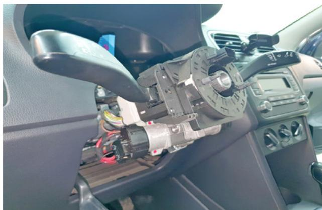
Фото 1.11. Нижняя часть кожуха рулевого вала снята
