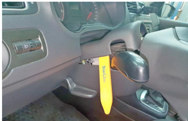
Фото 1.2. Снять верхнюю часть кожуха рулевого вала
