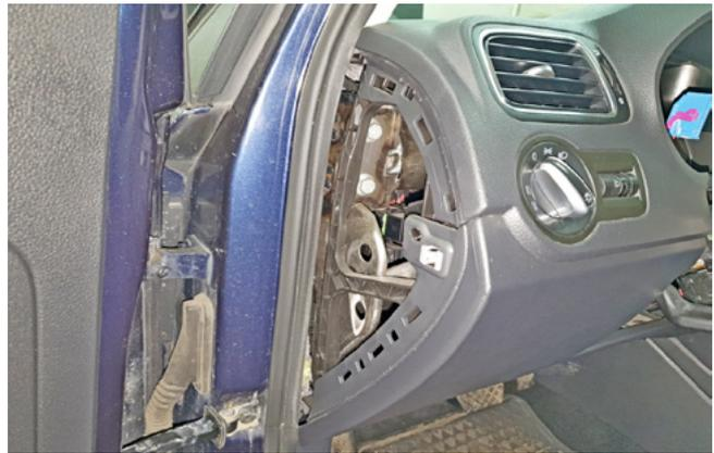
Фото 1.13. Боковая накладка передней панели снята
