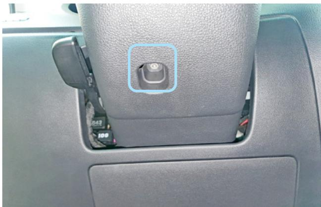
Фото 1.10. Винт крепления нижней части кожуха снизу
