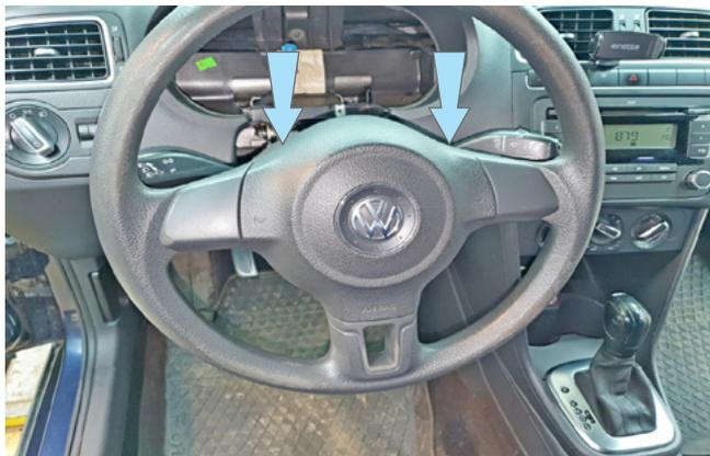
Фото 1.6. Фиксаторы крепления подушки безопасности водителя.
