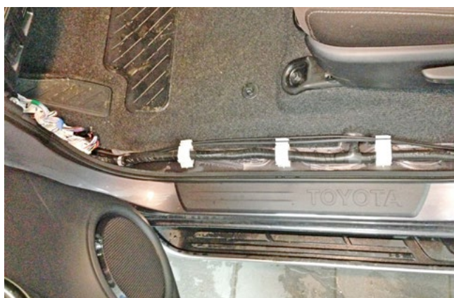
Фото 1.3. Накладки порога и кик-панели сняты
