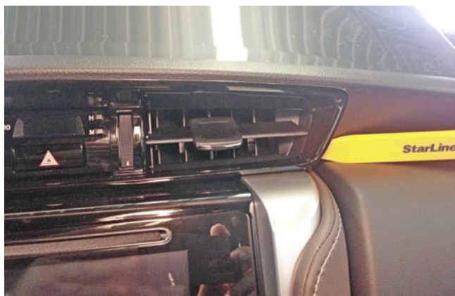
Фото 1.12. Снять центральный воздуховод
