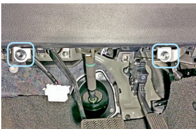
Фото 1.8. Болты крепления подушки безопасности снизу
