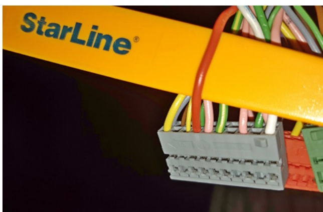
Фото 3.8. Контроль концевика сдвижной левой двери (красный)
