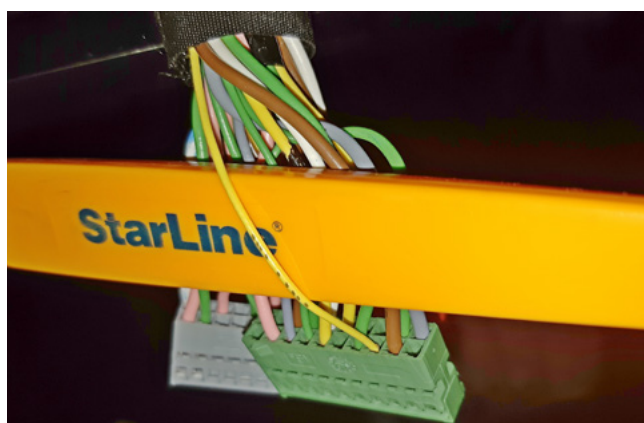
Фото 3.10. Контроль концевика передней правой двери (жёлтый)
