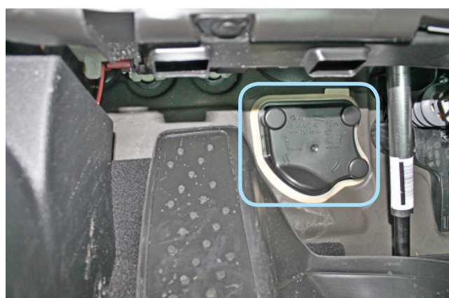
Фото 2.6. Штатный уплотнитель. Вид со стороны салона
