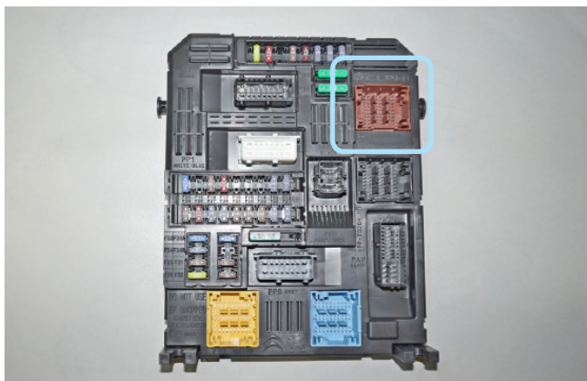
Фото 3.6. Местоположение коричневого разъёма на блоке BSI
