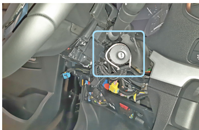
Фото 3.17. Антенна модуля обхода штатного иммобилайзера на замке зажигания
