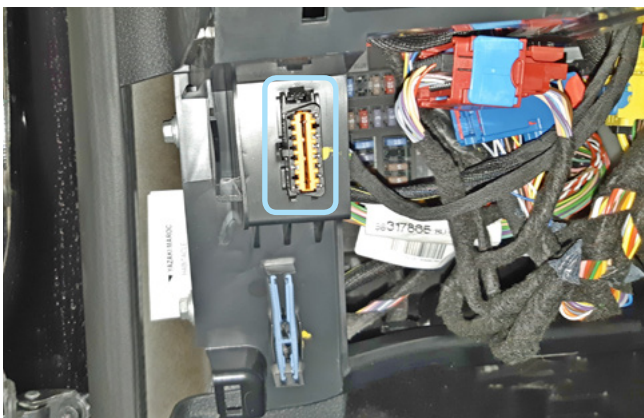
Фото 3.4. Местоположение диагностического разъёма
