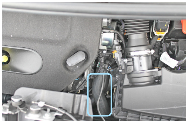
Фото 2.3. Место установки датчика температуры двигателя
