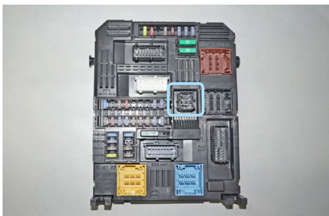
Фото 3.18. Местоположение чёрного разъёма на блоке BSI
