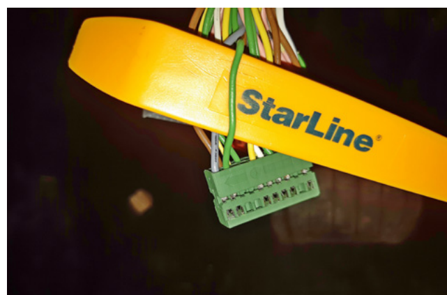
Фото 3.11. Контроль концевика багажника (зелёный)
