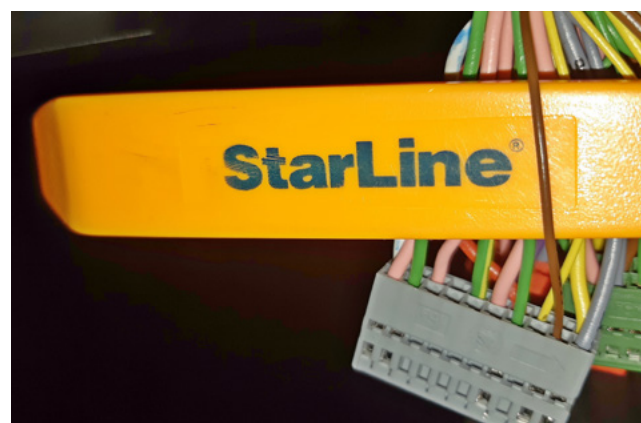
Фото 3.9. Контроль концевика передней левой двери (коричневый)
