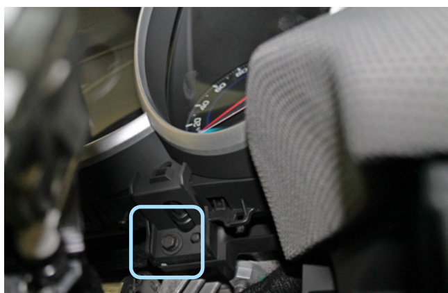
Фото 1.17. Нижняя накладка снята. Саморез крепления панели приборов справа
